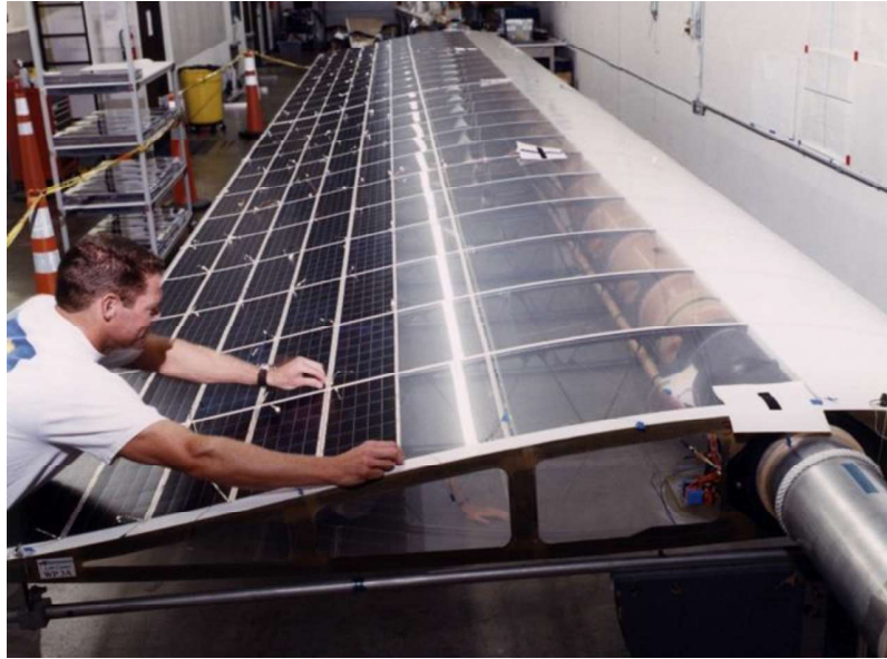
Slika 2.7 Postavljanje solarnih ćelija na Helios solarnu letjelicu [9]
