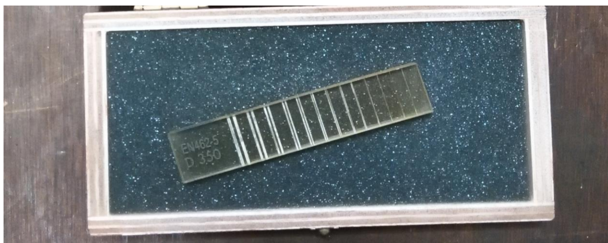
Slika 15: Duplex indikator prema normi EN 462-5
