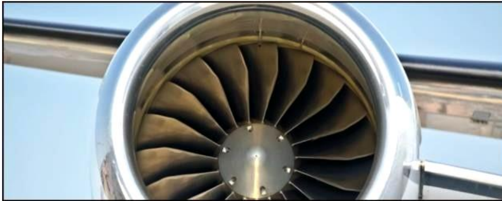
Slika 15 Motor zrakoplova izrađen od sinterirane superlegure [5]
