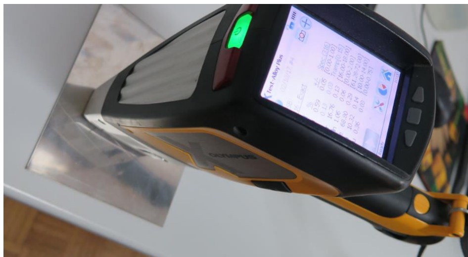
Slika 19: Prikaz provedbe ispitivanja kemijskog sastava XRF metodom.
