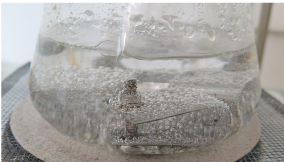
Slika 23: Detaljniji prikaz provedbe korozijskog ispitivanja. Snimljeno tijekom ispitivanja uzoraka od austenitnih čelika.
