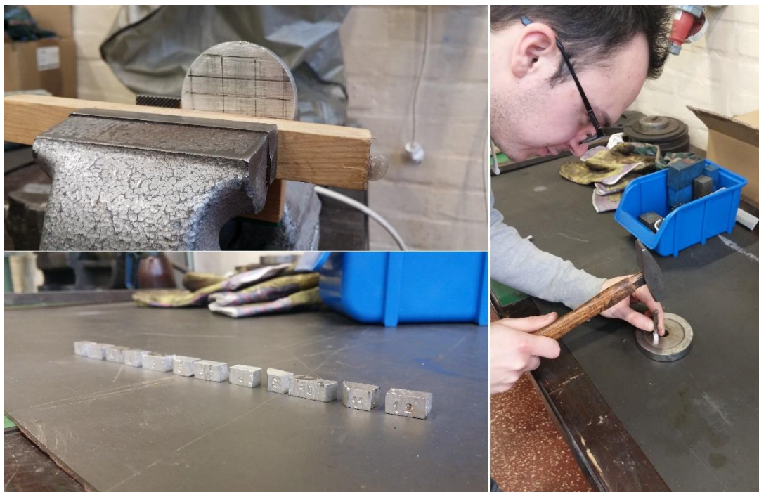
Slika 18. Rezanje i označavanje uzoraka
