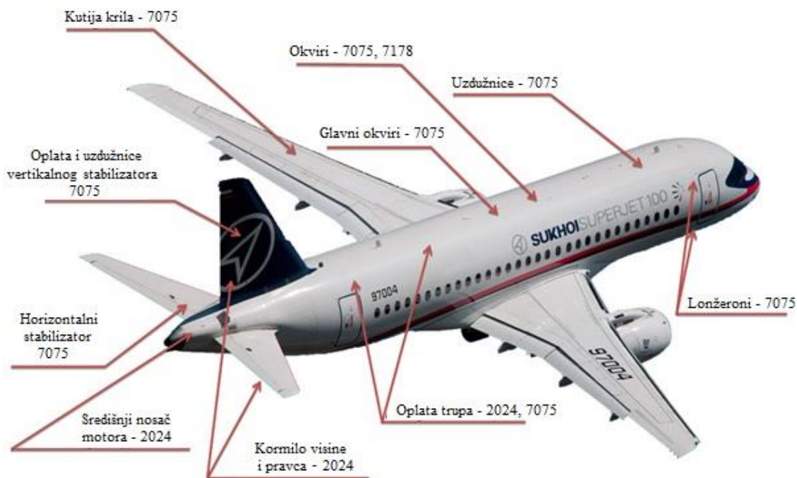
Slika 15. Primjena aluminija u zrakoplovnim konstrukcijama
