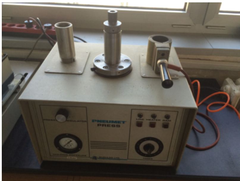
Slika 4.1: Uređaj za ulijevanje
