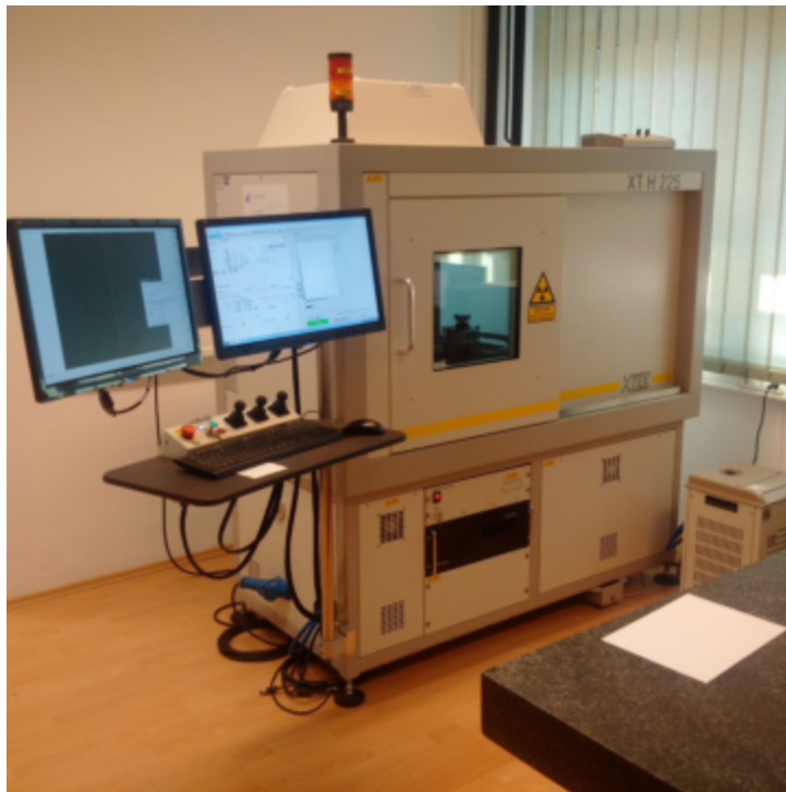
Slika 4.14: CT uređaj Nikon XT H 225
