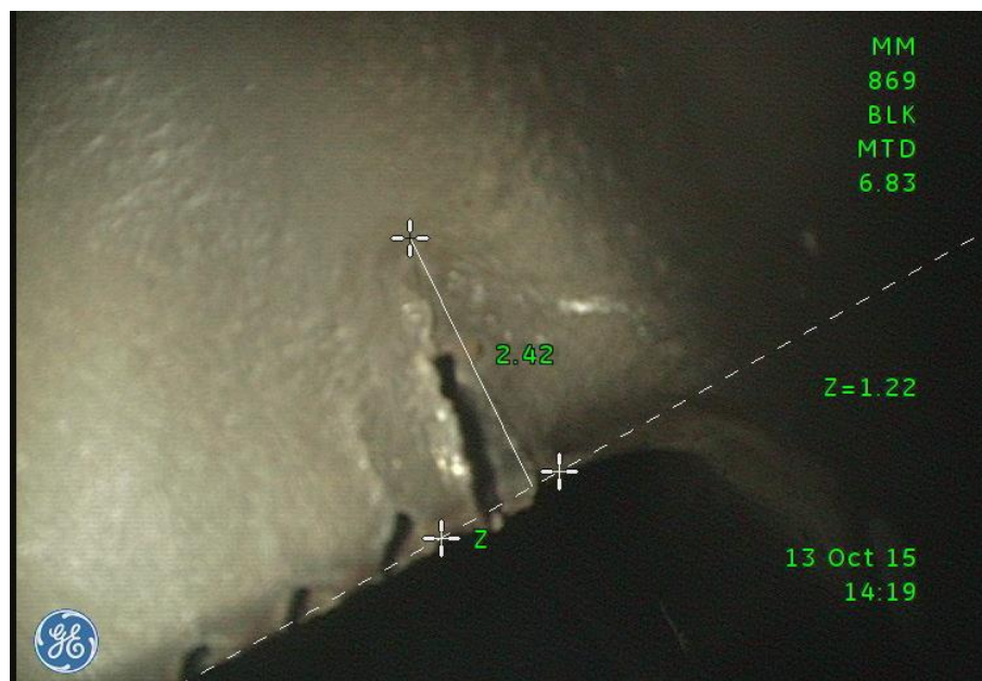
Slika 43. Očitavanje dužine pukotine, - point line, [mm]
