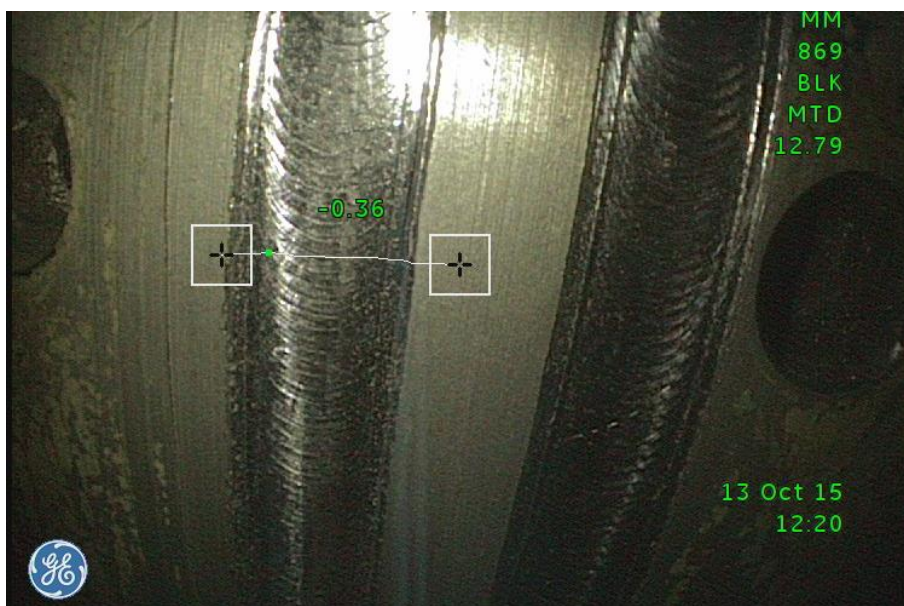
Slika 39. Očitavanje dubine oštećenja – point line, [mm]
