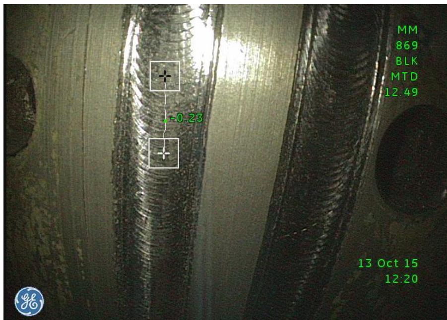
Slika 41. Očitavanje dubine oštećenja – point line, [mm]
