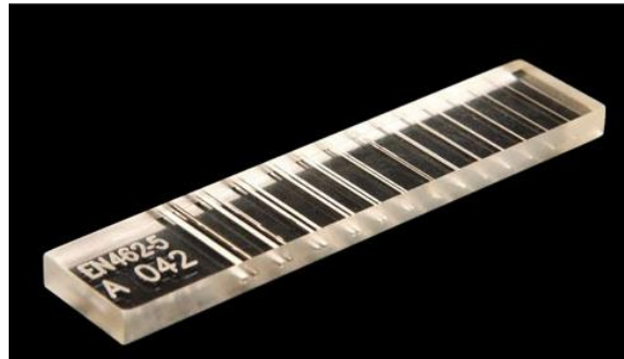
Slika 12. Indikator kvalitete s dvostrukim žicama [13]
