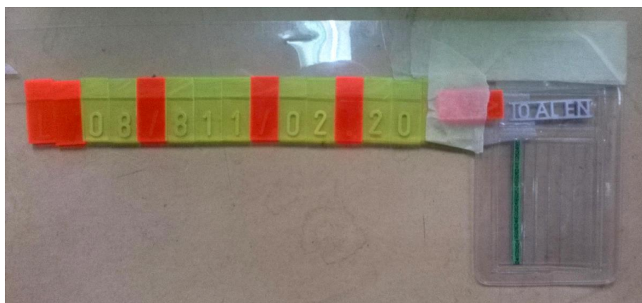
Slika 15. Indikatori kvalitete i identifikacijske oznake radiograma
