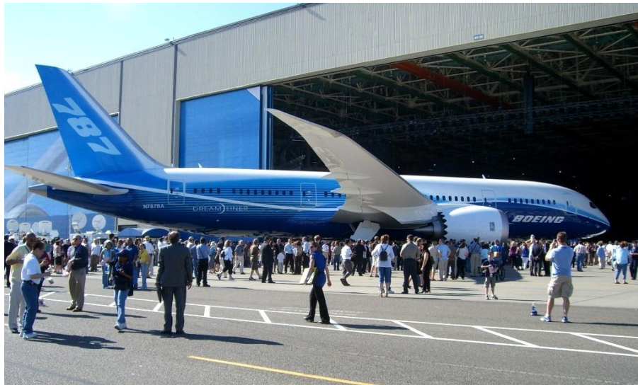
Slika 4. Raked wingtip , završetak krila na zrakoplovu Boeing 787 [1]
