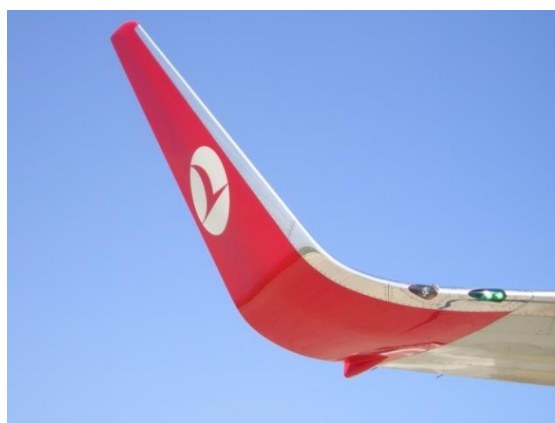
Slika 3. Winglet završetak krila na zrakoplovu Boeing 737-800 [1]
