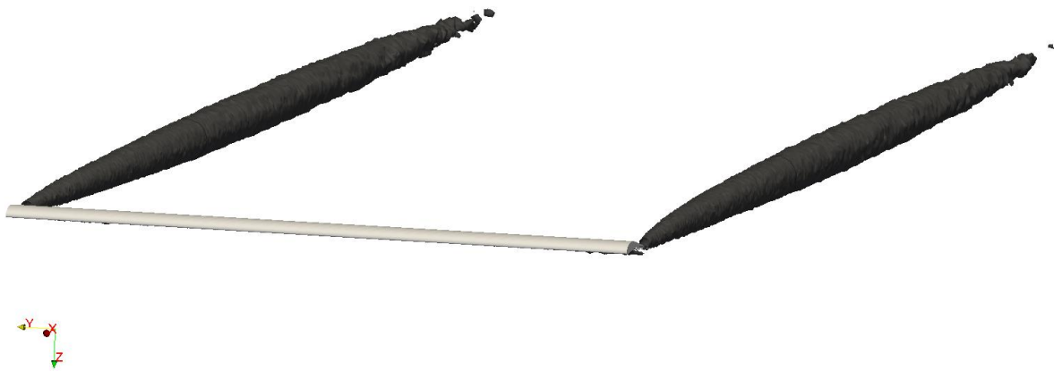
Slika 18. Prikaz kontura veličine Q = 10 \text{ s}^{-2} , za obično krilo
