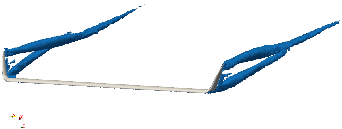
Slika 19. Prikaz kontura veličine Q = 10 \text{ s}^{-2} , za krilo sa završetkom
