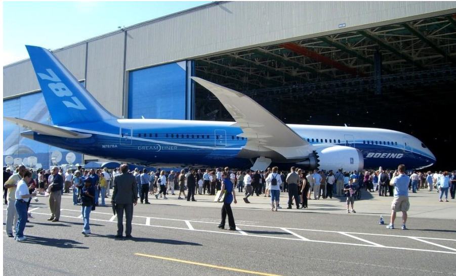
Slika 4. Raked wingtip , završetak krila na zrakoplovu Boeing 787 [1]
