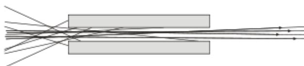
Slika 3.5.Utjecaj kolimatora na izlazne X zrake[6]
