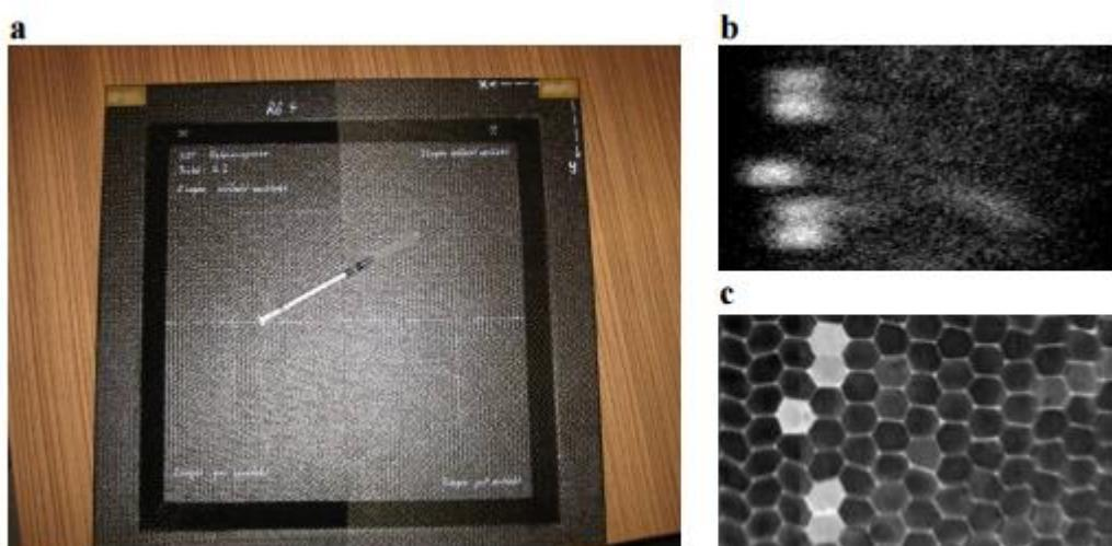
Slika 4.4. Snimka sače tehnikom raspršenog zračenja(b) i tehnikom prozračivanja(c) [13]
