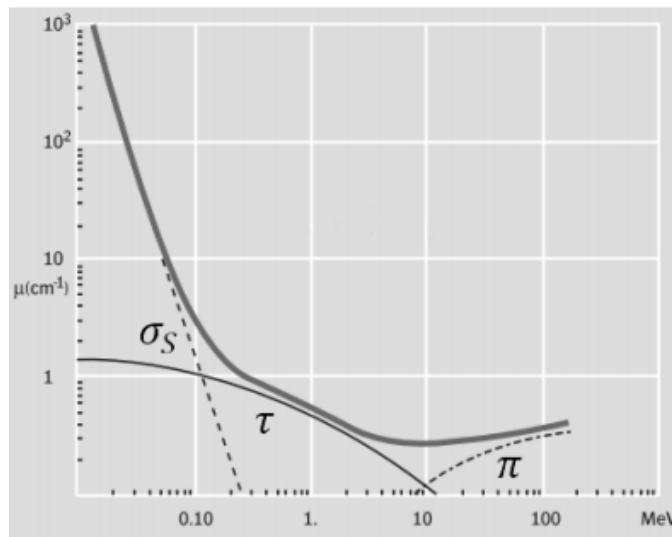
Slika 2.2. Odnos koeficijenta prigušenja i energije zračenja na primjeru čelika[1]
