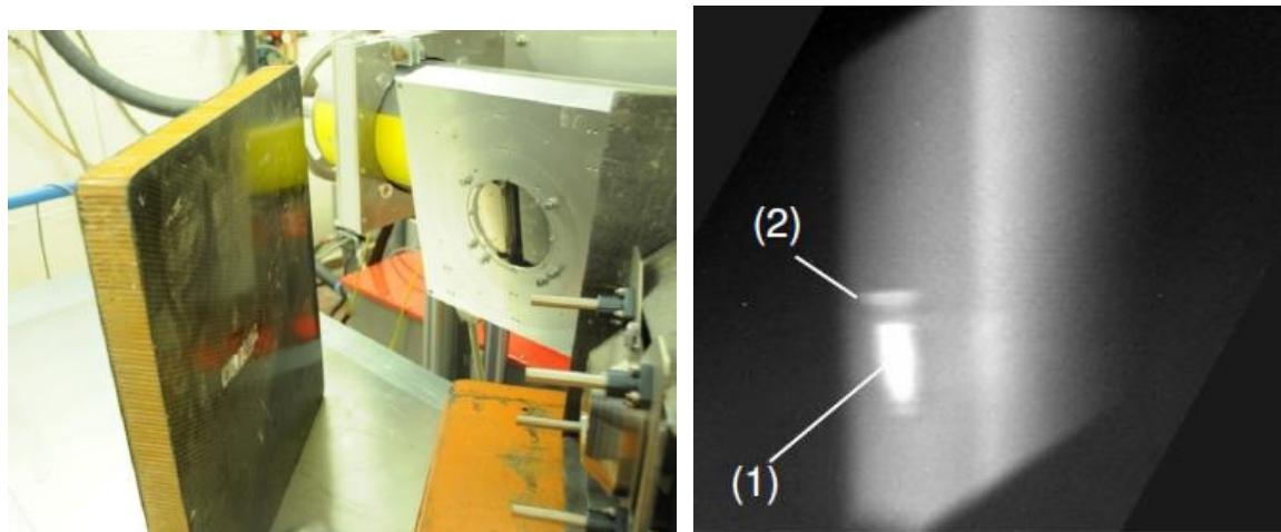
Slika 4.3 Upotreba tehnike raspršenog zračenja sa digitalnim detektorom pri ispitivanju vode u kompozitnim sačama. 1-voda, 2-poliester [13]
