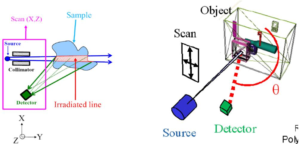
Slika 2.10. Sustav za snimanje dvodimenzionalnih slika tehnikom raspršenog zračenja[6]
