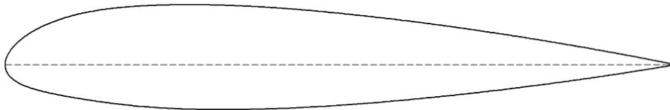
Slika 2.4.1: Aeroprofil NACA 23015
