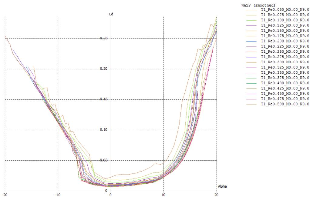
Slika 3.2. Koeficijent otpora u ovisnosti o napadnom kutu (WASP)
