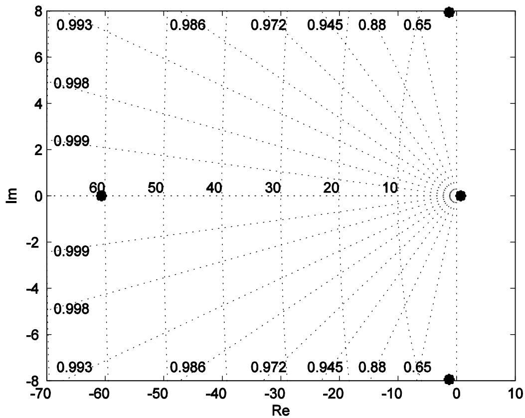
**Slika 6.5. Korijeni sustava bočnog gibanja za maksimalni dolet**
