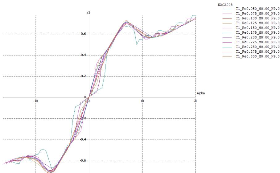
**Slika 3.6. Koeficijent uzgona ovisno o napadnom kutu (NACA 0008)**
