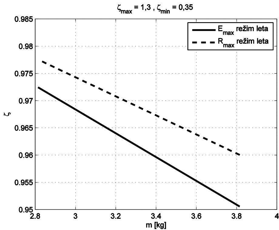
Slika 7.2. Parametri gušenja kratkoperiodičnog moda koji se ocjenjuju
