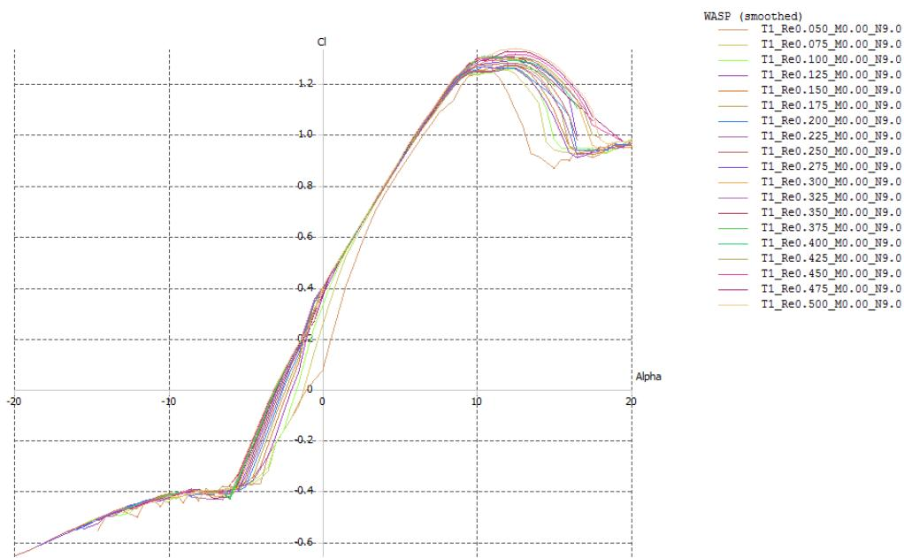
Slika 3.1. Koeficijent uzgona ovisno o napadnom kutu (WASP)
