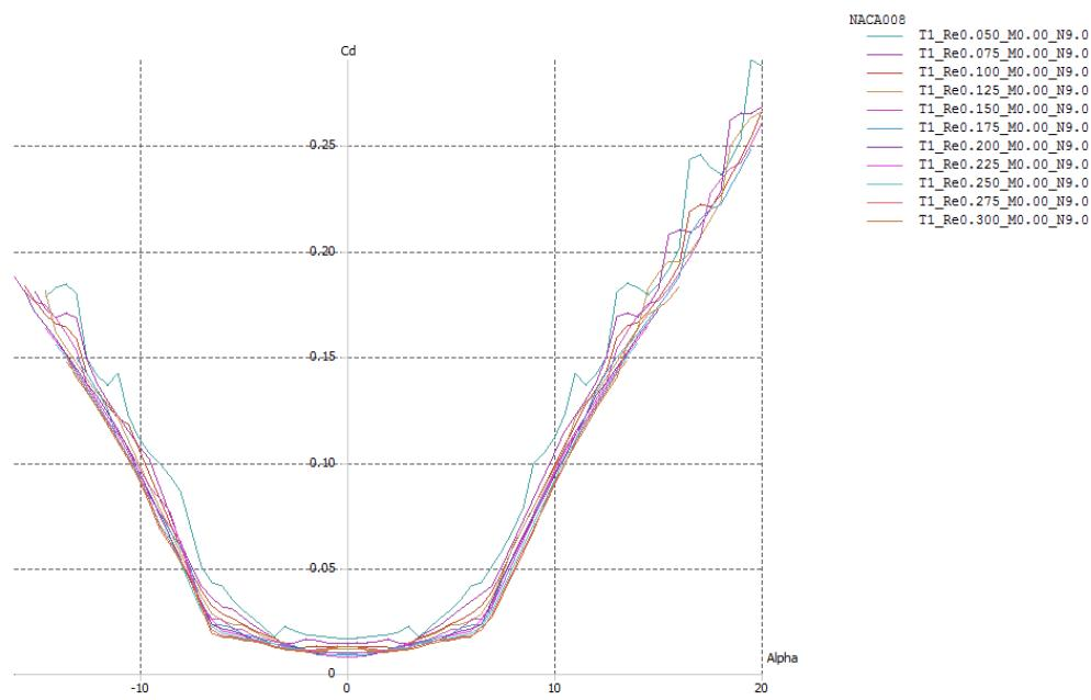
**Slika 3.7.** Koeficijent otpora ovisan o napadnom kutu (NACA 0008)
