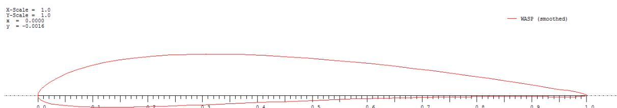
Slika 2.1. Geometrija aeroprofila krila
