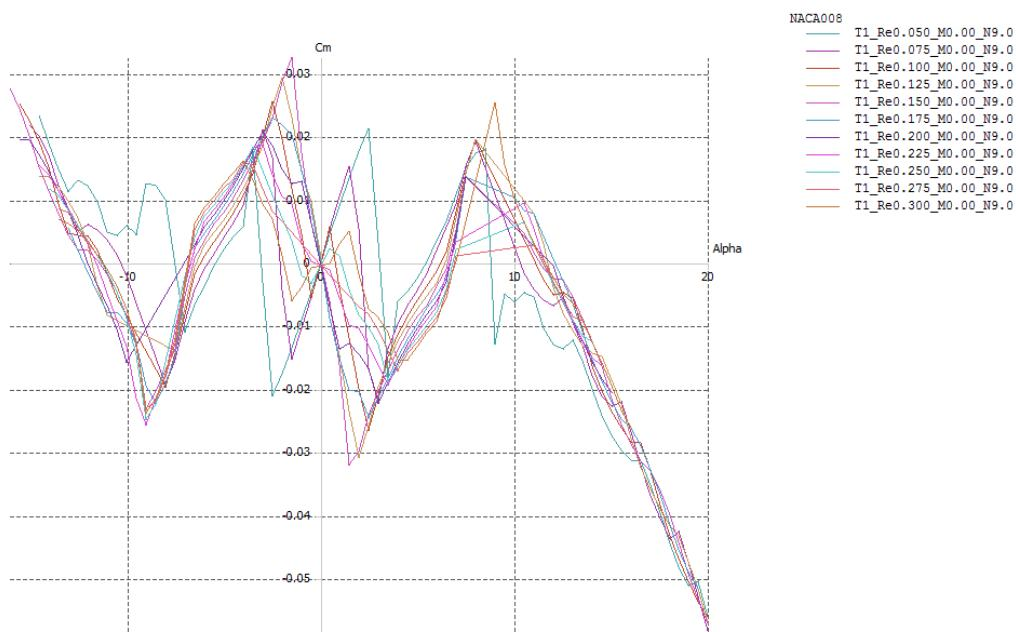
**Slika 3.8.** Koeficijent momenta propinjanja aeroprofilna ovisan o napadnom kutu (NACA 0008)
