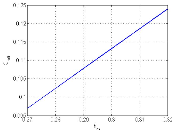
**Slika 21.** Promjena  $C_{m0}$  s promjenom horizontalnog položaja težišta
