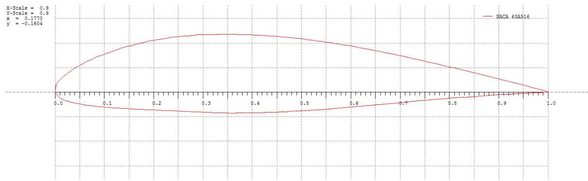
**Slika 4. Profil krila NACA 63A516****Tablica 1. Karakteristike krila**
