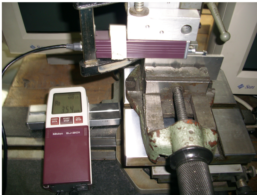
Slika 2.16 Prikaz mjerenja hrapavosti laserskih uzoraka
