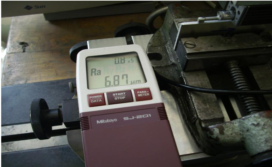
Slika 2.3 Prijenosni uređaj Mitutoyo SJ-201 za mjerenje hrapavosti
