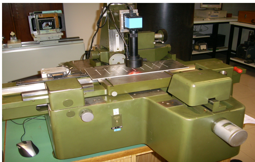
Slika 2.12 Alatni mikroskop LFSB-a i plazma izrezani ispitni uzorak
