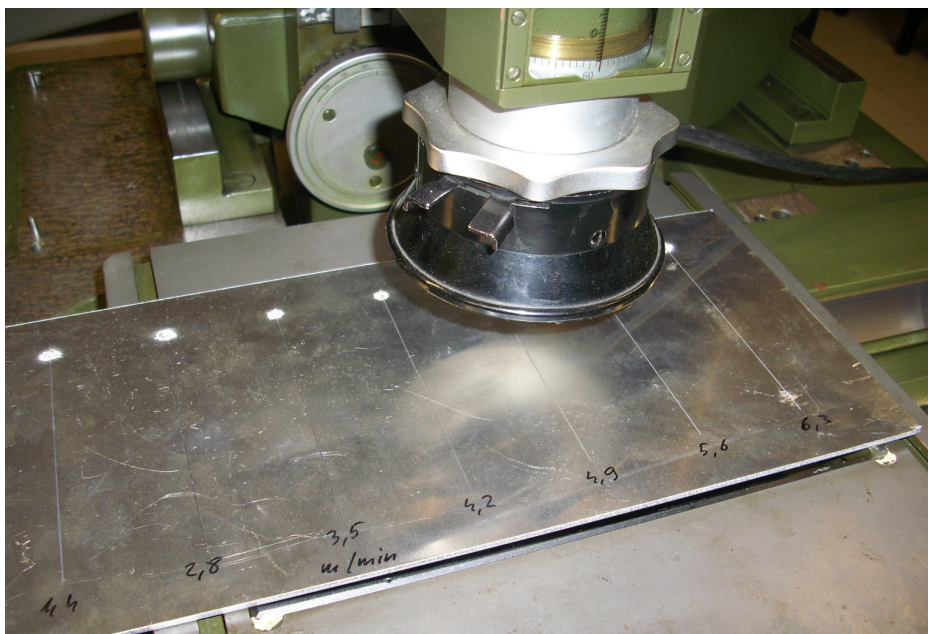
Slika 2.22 Prikaz laserskog ispitnog uzorka i alatnog mikroskopa za mjerenje širine reza
