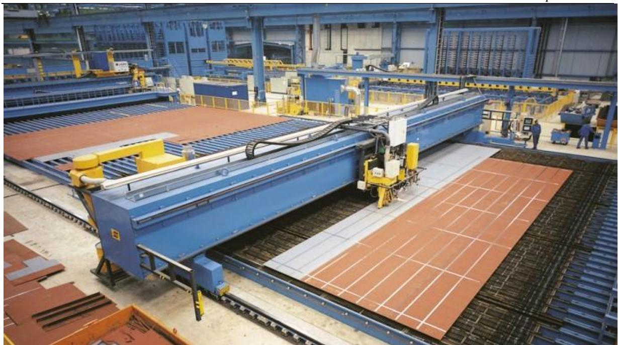
**Slika 19. Zavarivanje limova palube, [10]**
