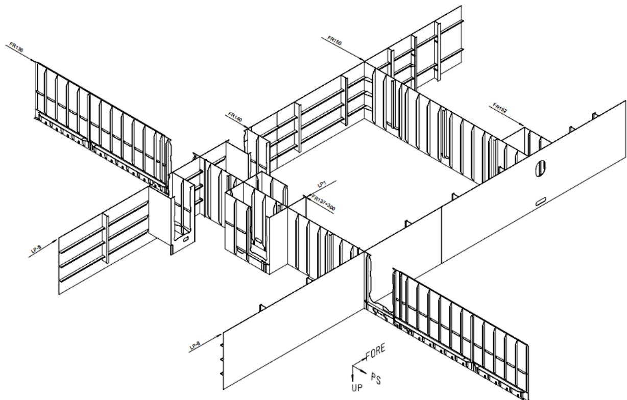
**Slika 5. 3D model sekciјe nadgrađa GN7342, [5]**
