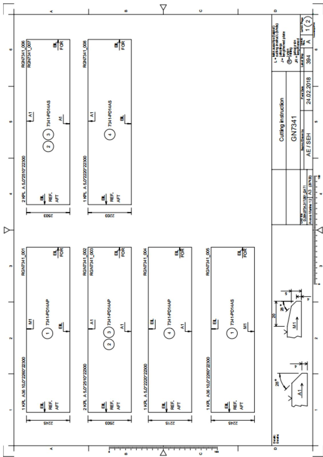
Slika 8. Raskroj limova palube, [5]
