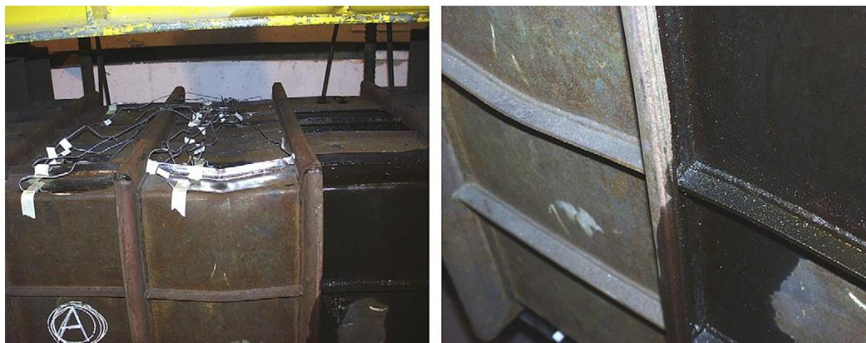
Slika 33. Deformacije oplate i ukrepa modela H300 nakon eksperimenta [4]
