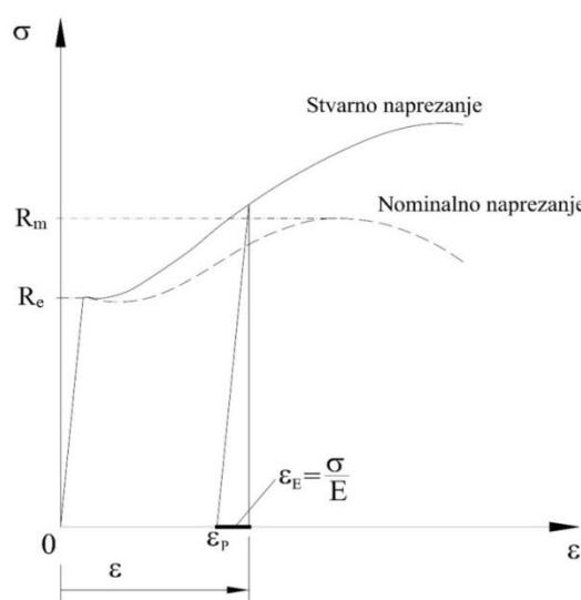
Slika 3.1. Kvalitativan prikaz krivulja nominalnog i stvarnog naprezanja duktilnog materijala, [1]
