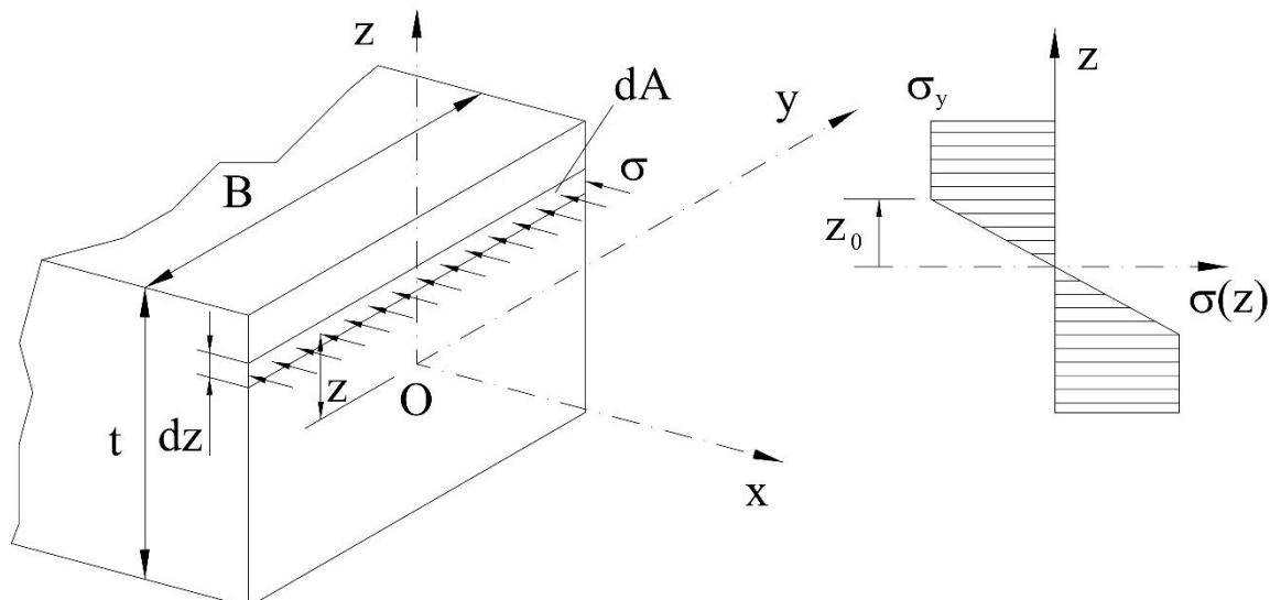
Slika 4.2. Prikaz djelovanja naprezanja na diferencijalnu površinu obradka, [1]
