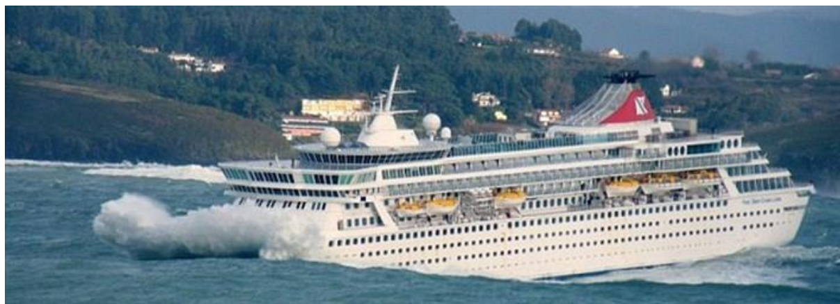
Slika 1. Valno udarno opterećenje ( slamming )
