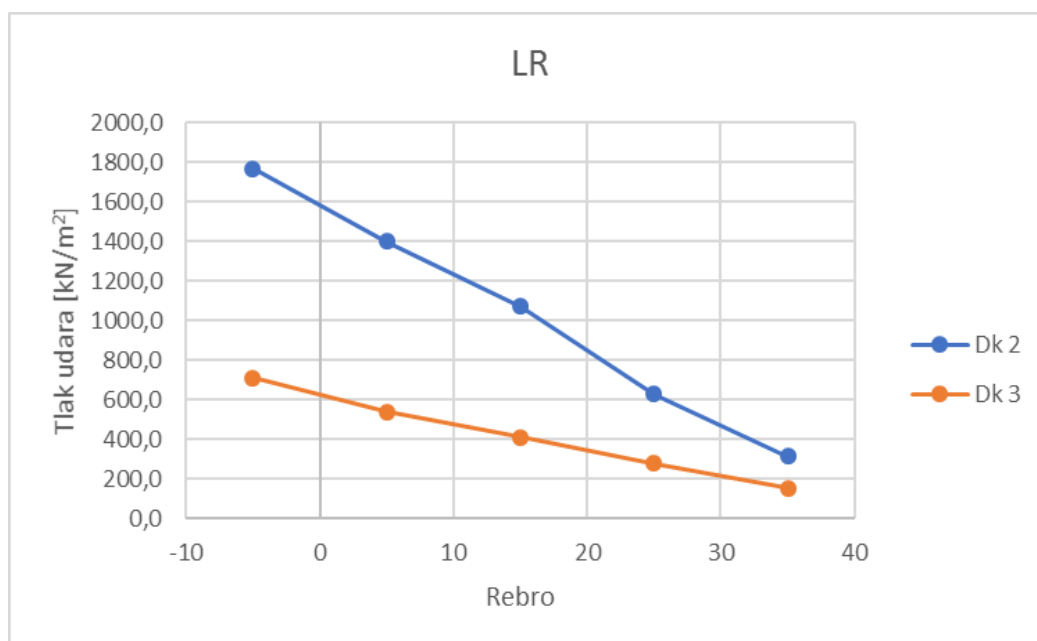
Slika 22. Promjena tlakova po visinama prema LR-u
