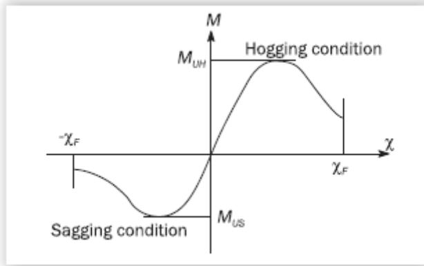
Slika 5 Granični moment savijanja u ovisnosti o zakrivljenosti [1]
