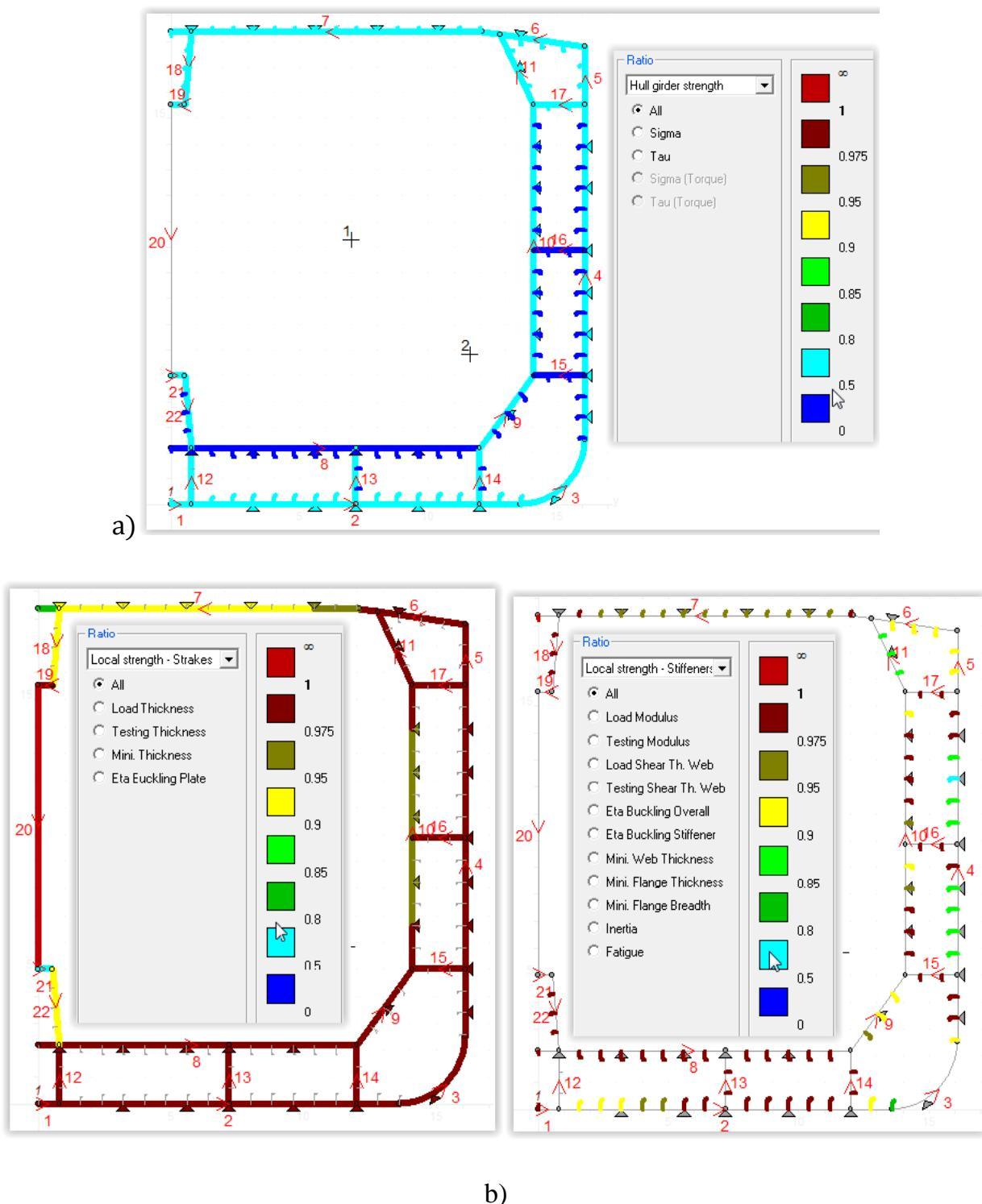
Slika 21 Kriteriji za a) globalnu čvrstoću i b) lokalnu čvrstoću glavnog rebra od čelika povишene čvrstoće ( AH36 )
