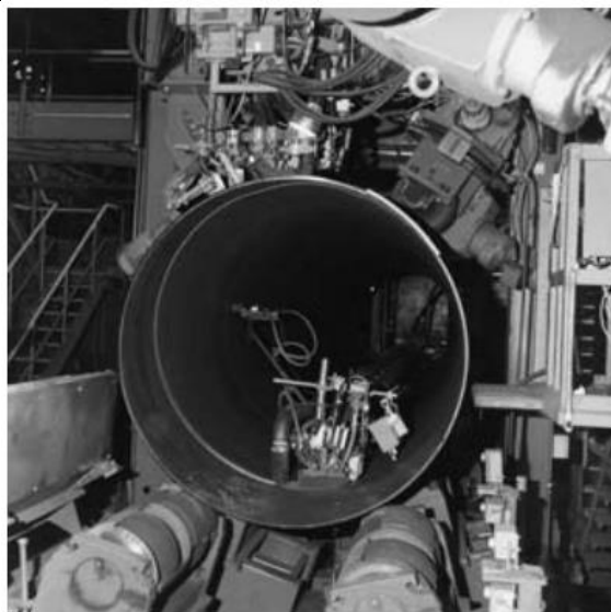
Slika 21. Unutarnje i vanjsko zavarivanje spiralnih cijevi pod praškom [7]
