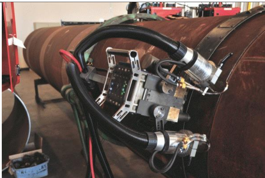
Slika 32. Glava za automatsko zavarivanje čeličnih cijevi [8]
