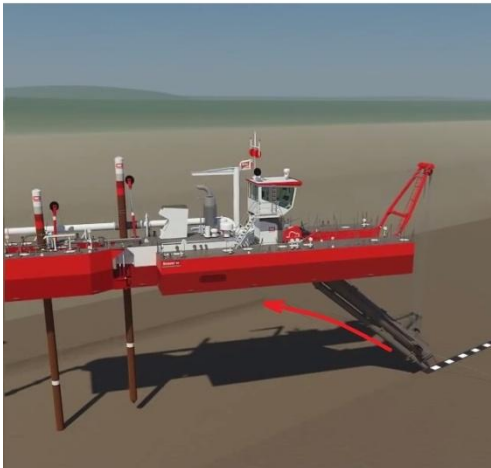
Položaj 3 - glavni je pylon za uzdužni pomak broda udaljeniji od glave sjekača (veći radijus) i zatezanjem lijevog čeličnog kabela, počinje se opisivati novi koncentrični kružni luk. Proces se ponavlja dok kolicila pilona ne dođu u krajnji položaj.
