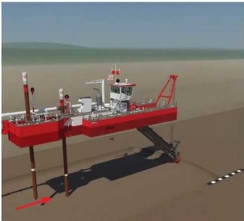
Položaj 5 - nakon što je glavni pylon podignut, pomoćni spušten, kolicila se počinju gibati prema naprijed dok ne dođu u krajnji položaj (najbliže sjekaču), a zatim se glavni pylon ponovo spušta, a pomoćni podiže.
