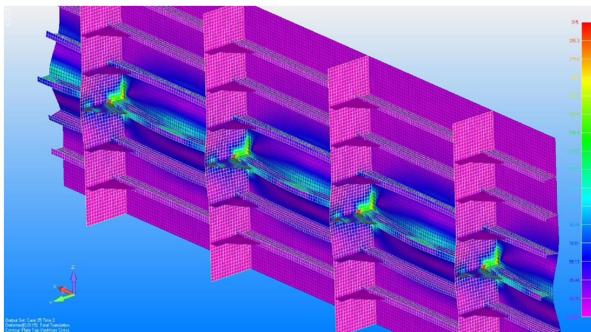
Slika II.16 Von Misesova naprezanja na deformiranom modelu "1A\_koljena" nakon rasterećenja
