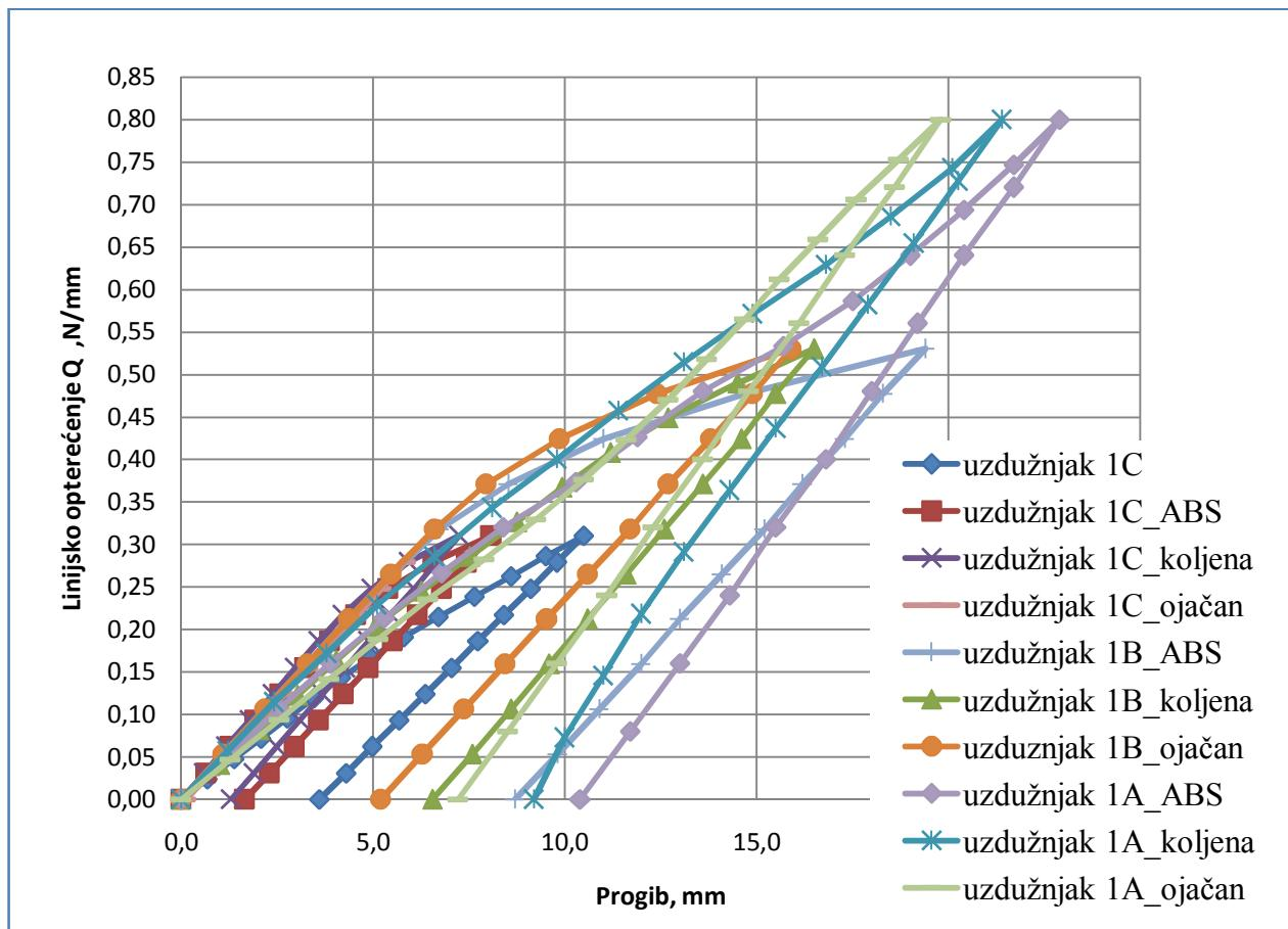
Slika 6.6 Krivulje opterećenje-maksimalni progib za uzdužnjak vanjske oplate za klase leda 1C, 1B i 1A
