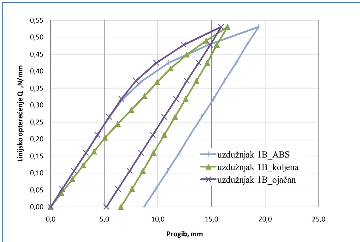
Slika 6.3 Krivulje opterećenje-maksimalni progib za uzdužnjak vanjske oplate za klasu leda 1B
