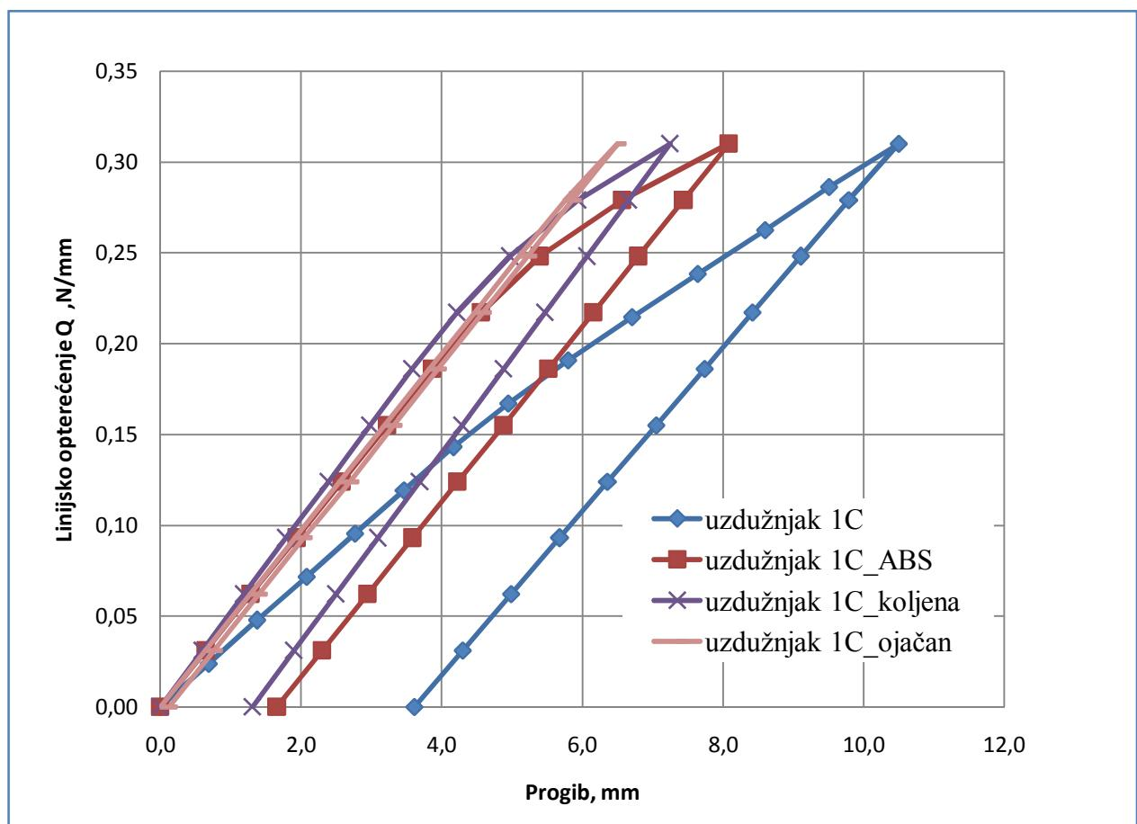
**Slika 6.1 Krivulje opterećenje-maksimalni progib za uzdužnjak vanjske oplate za klasu leda 1C**
