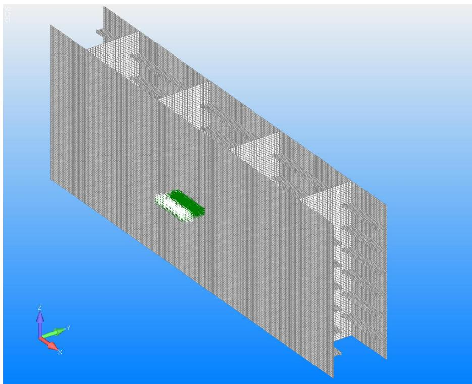
Slika 5.10 Površinsko opterećenje na oplati boka
