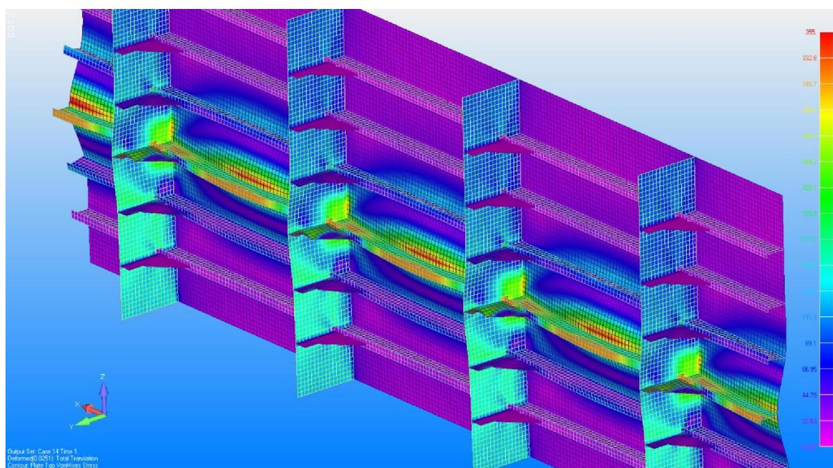
Slika II.15 Von Misesova naprezanja na deformiranom modelu "1A\_koljena" pri maksimalnom opterećenju
