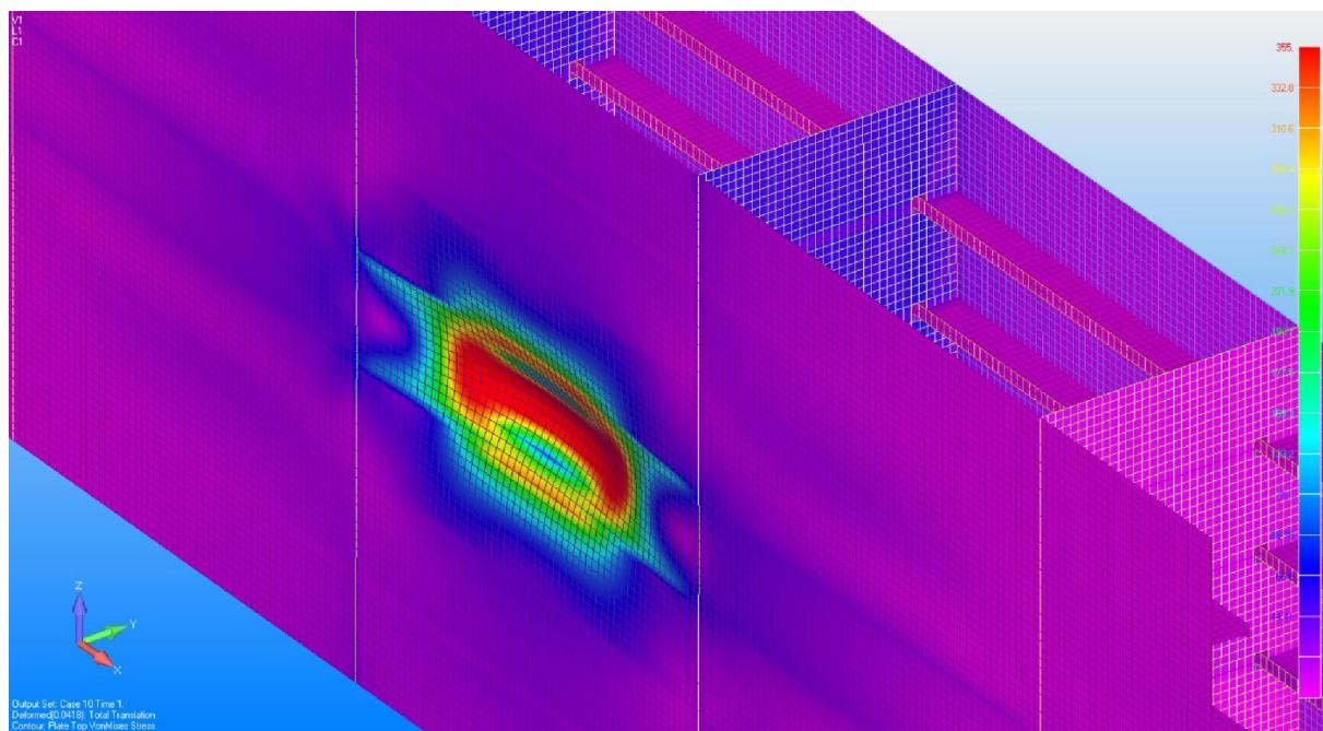
**Slika II.29** Von Misesova naprezanja na deformiranom modelu "1A" pri maksimalnom opterećenju
