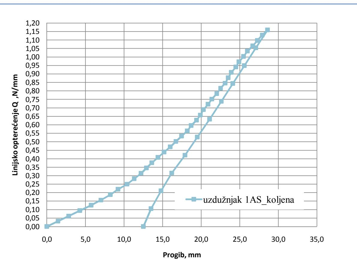
**Slika 6.5 Krivulja opterećenje-maksimalni progib za uzdužnjak vanjske oplate za klasu leda 1AS**
