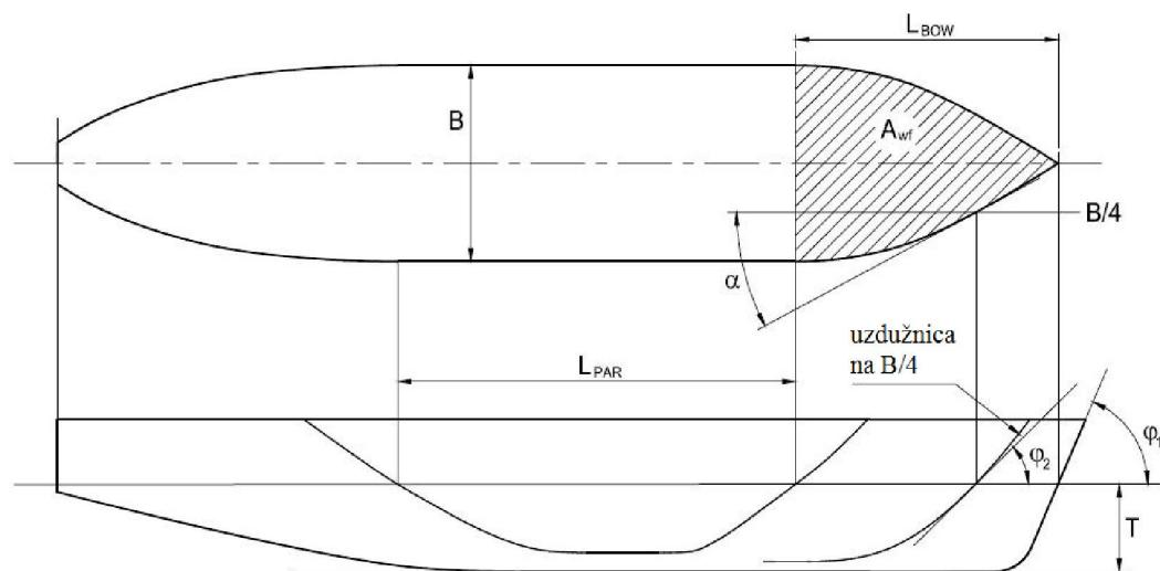
**Slika 5.2 Prikaz bitnih kutova za izračun snage stroja**
