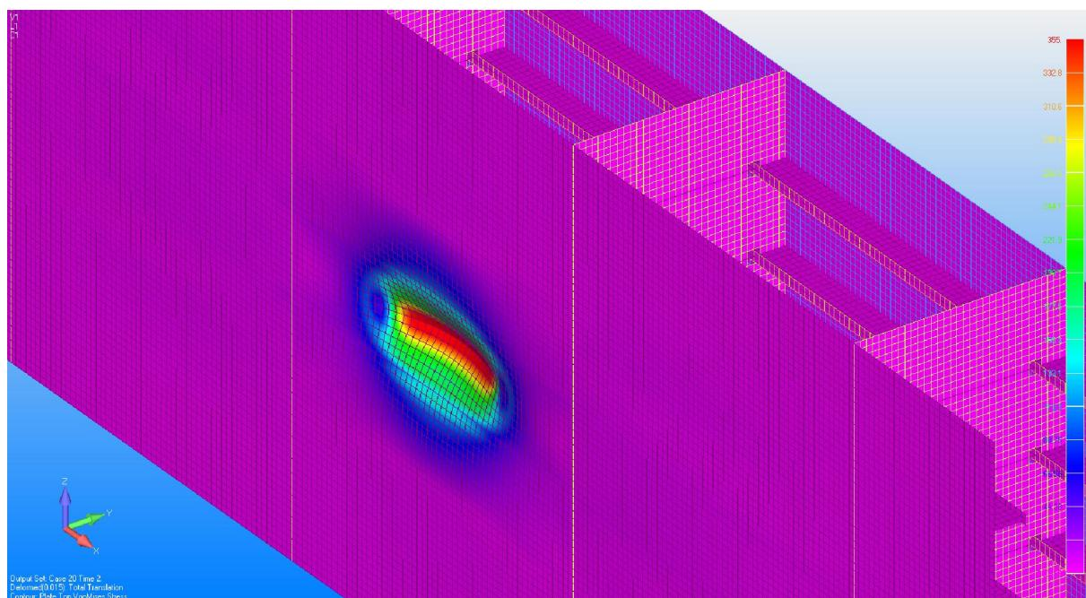
**Slika II.30** Von Misesova naprezanja na deformiranom modelu "1A" nakon rasterećenja
