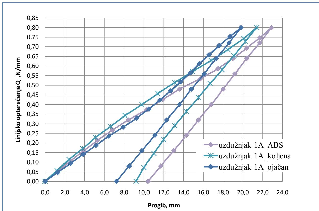
**Slika 6.4 Krivulje opterećenje-maksimalni progib za uzdužnjak vanjske oplate za klasu leda 1A**
