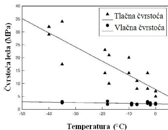
Slika 1.2 Vlačna i tlačna čvrstoća kao funkcije temperature [1]
