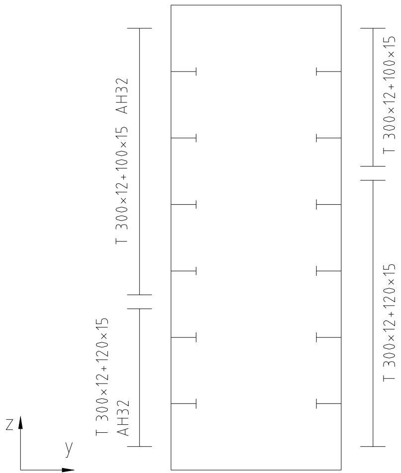
**Slika 5.1 Prikaz razmatranog dijela konstrukcije oplate u području glavnog rebra**
