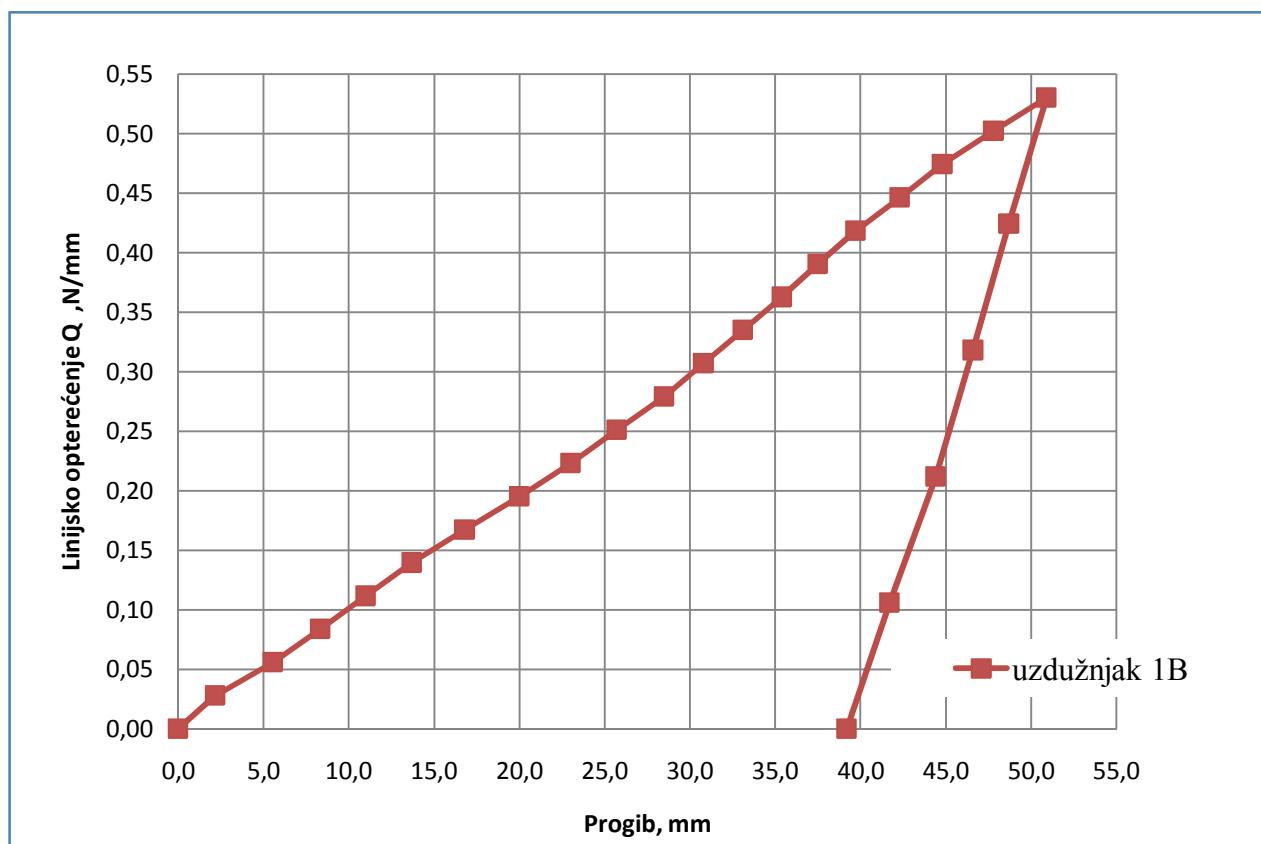
**Slika 6.2 Krivulja opterećenje-maksimalni progib za uzdužnjak vanjske oplate za klasu leda 1B za osnovni model**
