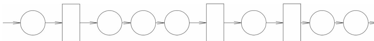
Slika 9. Linijski proizvodni proces sa sinhroniziranim zavisnim strojevima
