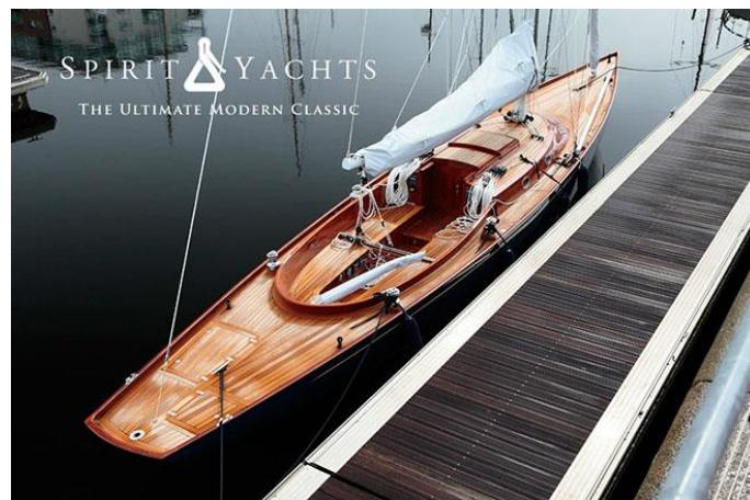
Slika 2. Primjer jahte u cijelosti izrađene od drva
