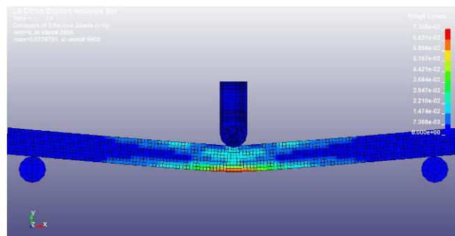
**Slika 49. Pojava deformacija i kritičnih točaka naprezanja**
