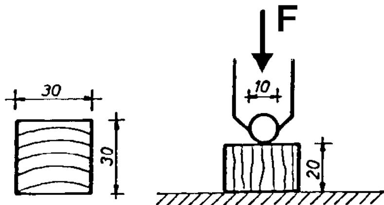
**Slika 27. Metoda određivanja tvrdoće drva prema Brinell-u [18]**
