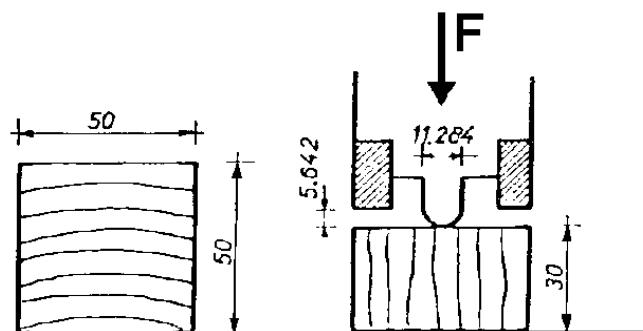
**Slika 28. Prikaz metode određivanja tvrdoće drva prema G.Janku [18]**
