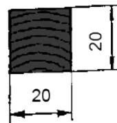
**Slika 22. Prikaz metode određivanja čvrstoće na tlak [18]**
