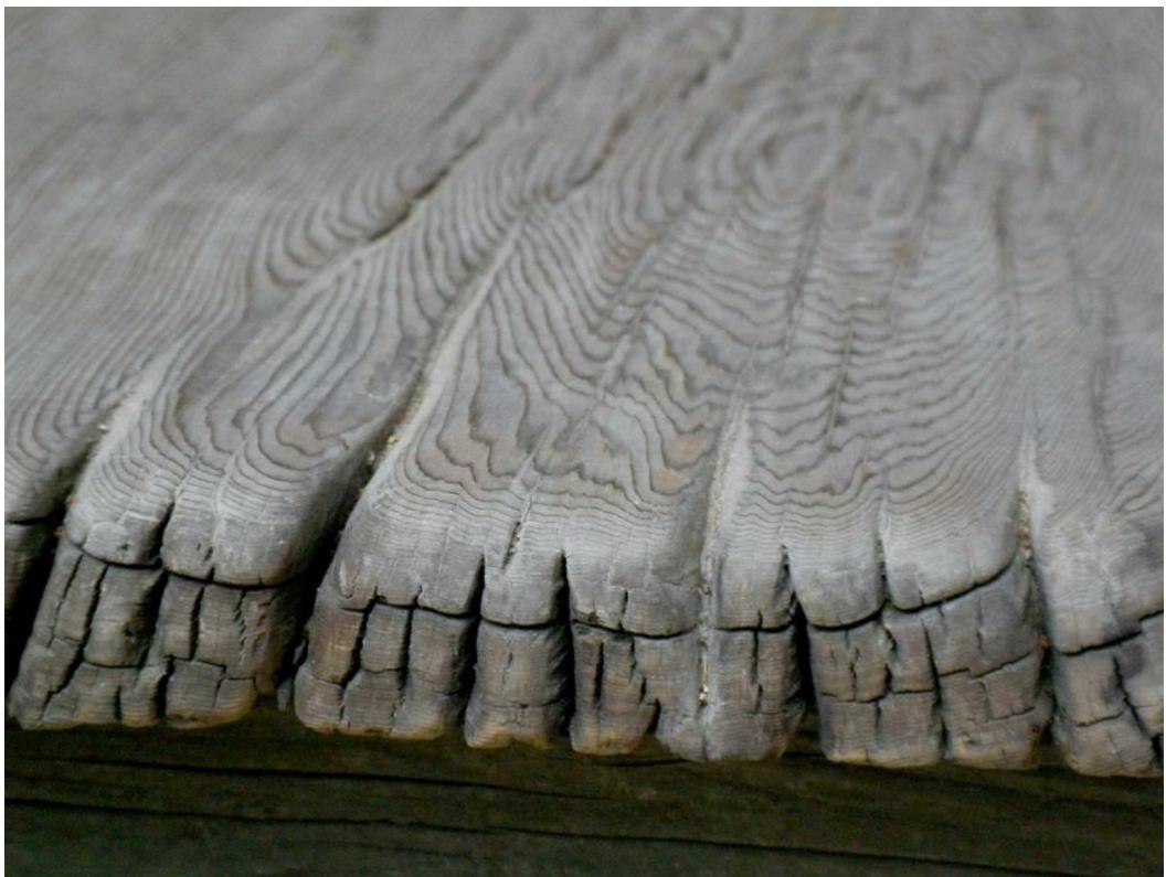
Slika 29. Trošenje drva habanjem [30]
