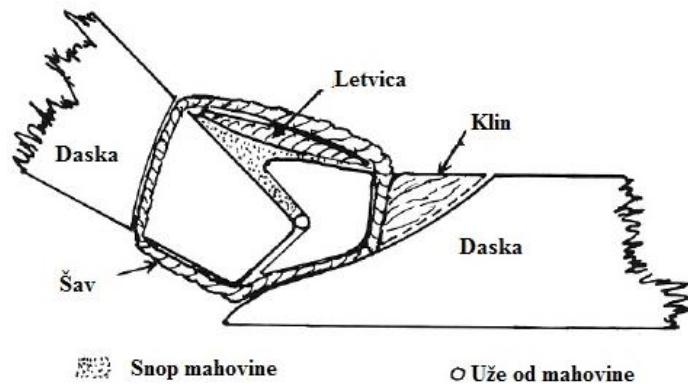
**Slika 8. Primitivni spoj drva sa mahovinom i drvenim klinom [4]**
