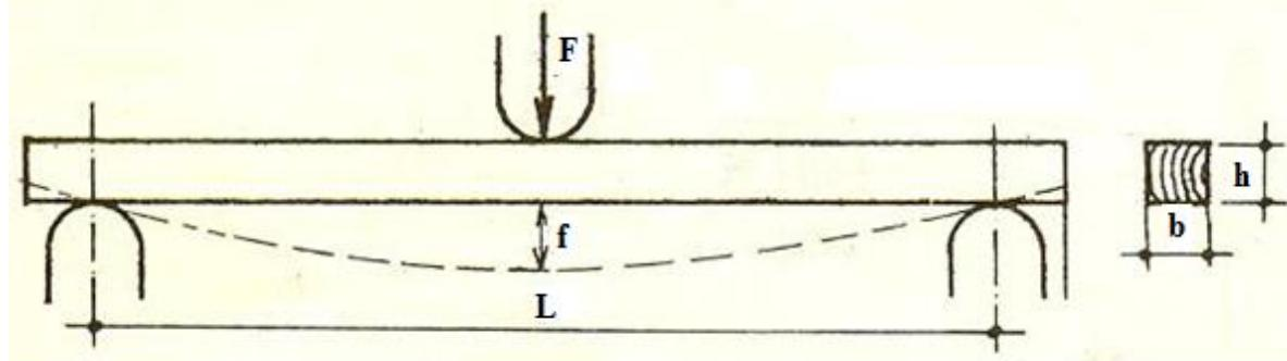
Slika 18. Prikaz općeg postupka određivanja modula elastičnosti [20]
