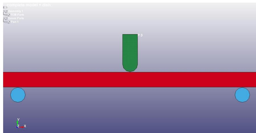
Slika 43. Geometrija modela za numeričku analizu savojne čvrstoće
