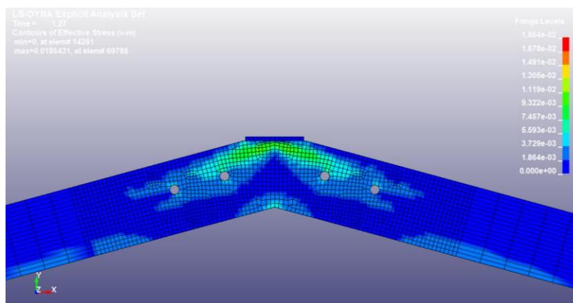
**Slika 63.** Prikaz von Mises naprezanja u t=1,27
