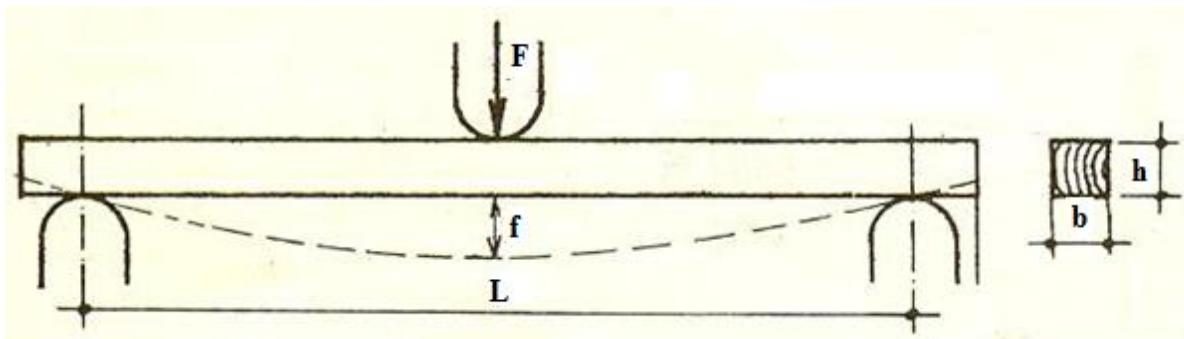
Slika 25. Metoda ispitivanja čvrstoće na savijanje [20]
