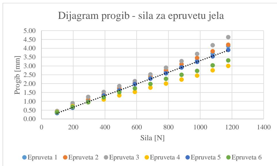
**Slika 38. Ovisnost progiba o sili za epruvete jele**
