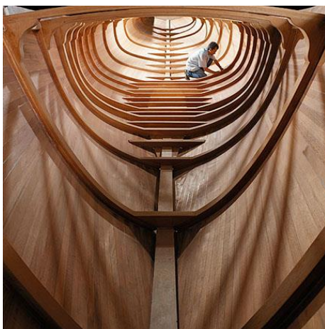
Slika 1. Oplata od drva za modernu konstrukciju ekskluzivnih jahti [1]
