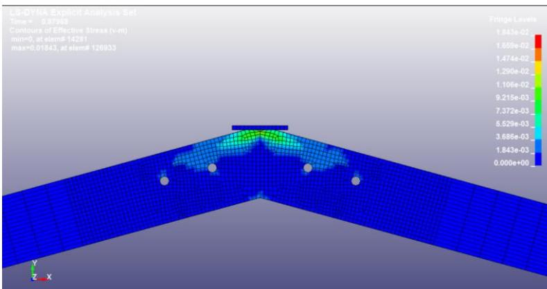
**Slika 62.** Prikaz von Mises naprezanja u t=0,88s
