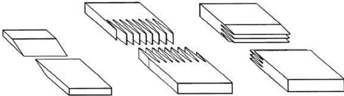
Slika 10. Prikaz lamenarnih spojeva [11]
