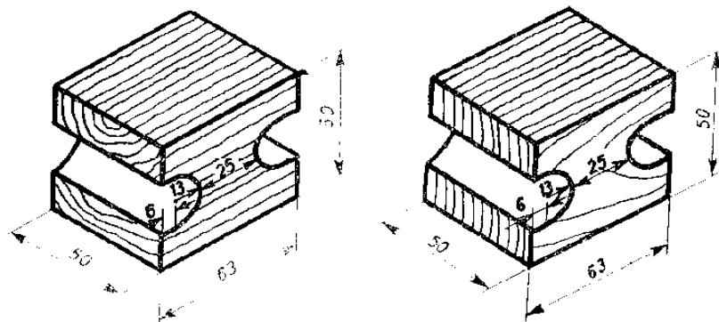
Slika 21. Uzorci za ispitivanje vlačne čvrstoće [20]
