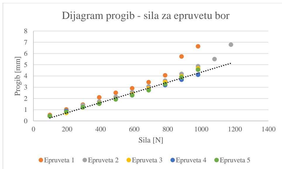
**Slika 37. Ovisnost progiba o sili za epruvete bora**
