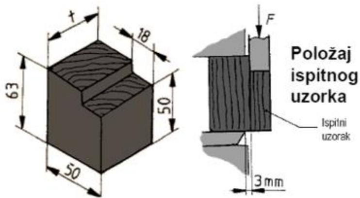
Slika 23. Metoda određivanja čvrstoće na smicanje [18]
