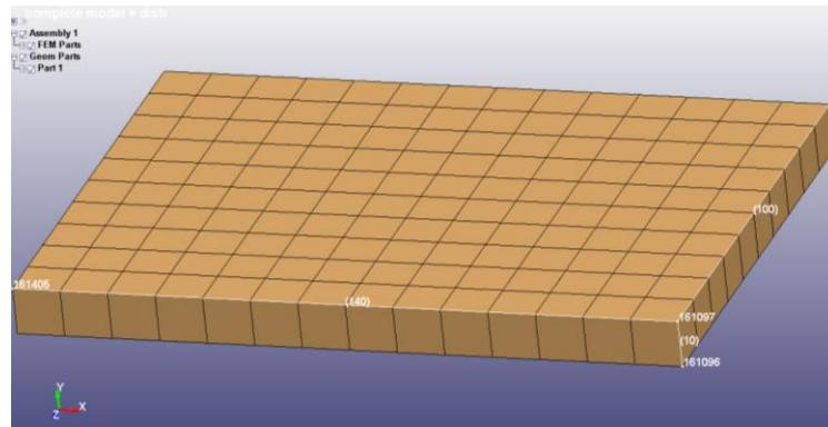
**Slika 54. Prikaz dimenzija pločastog dijela koji vrši silu**
