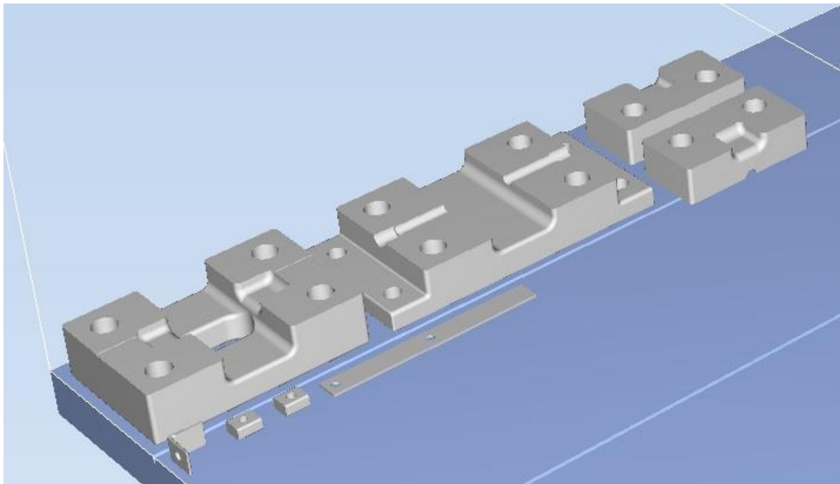
Slika 95 Prikaz slaganja dijelova za printanje u računalnom programu na zaslonu 3D printera Stratasys CONNEX 350
