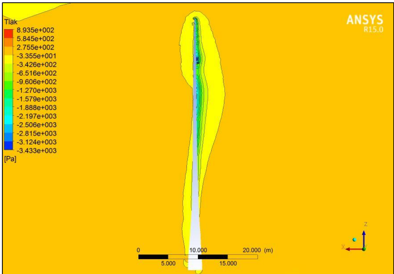
Slika 38. Raspodjela tlaka u presjeku xz duž lopatice
