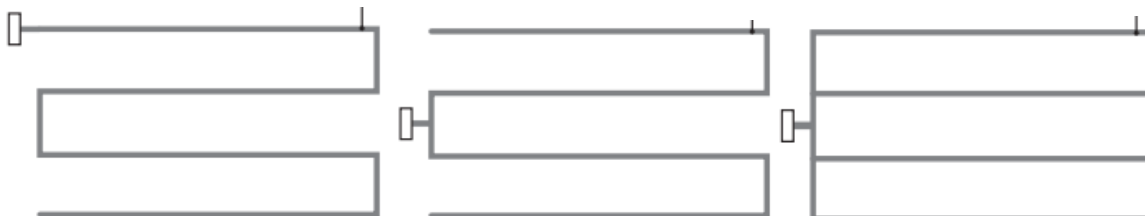
Slika 5 Osnovni načini postavljanja glavnog cjevovoda
