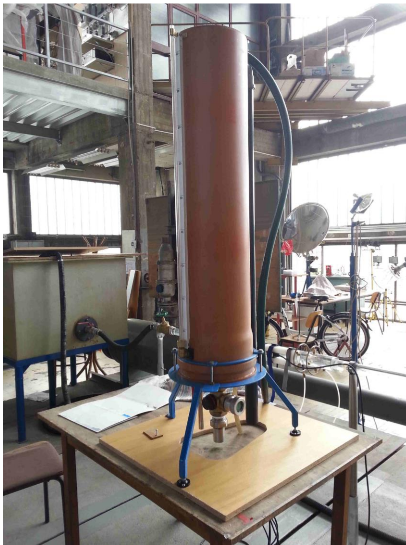
Slika 13. Mjerna posuda za umjeravanje protoka
