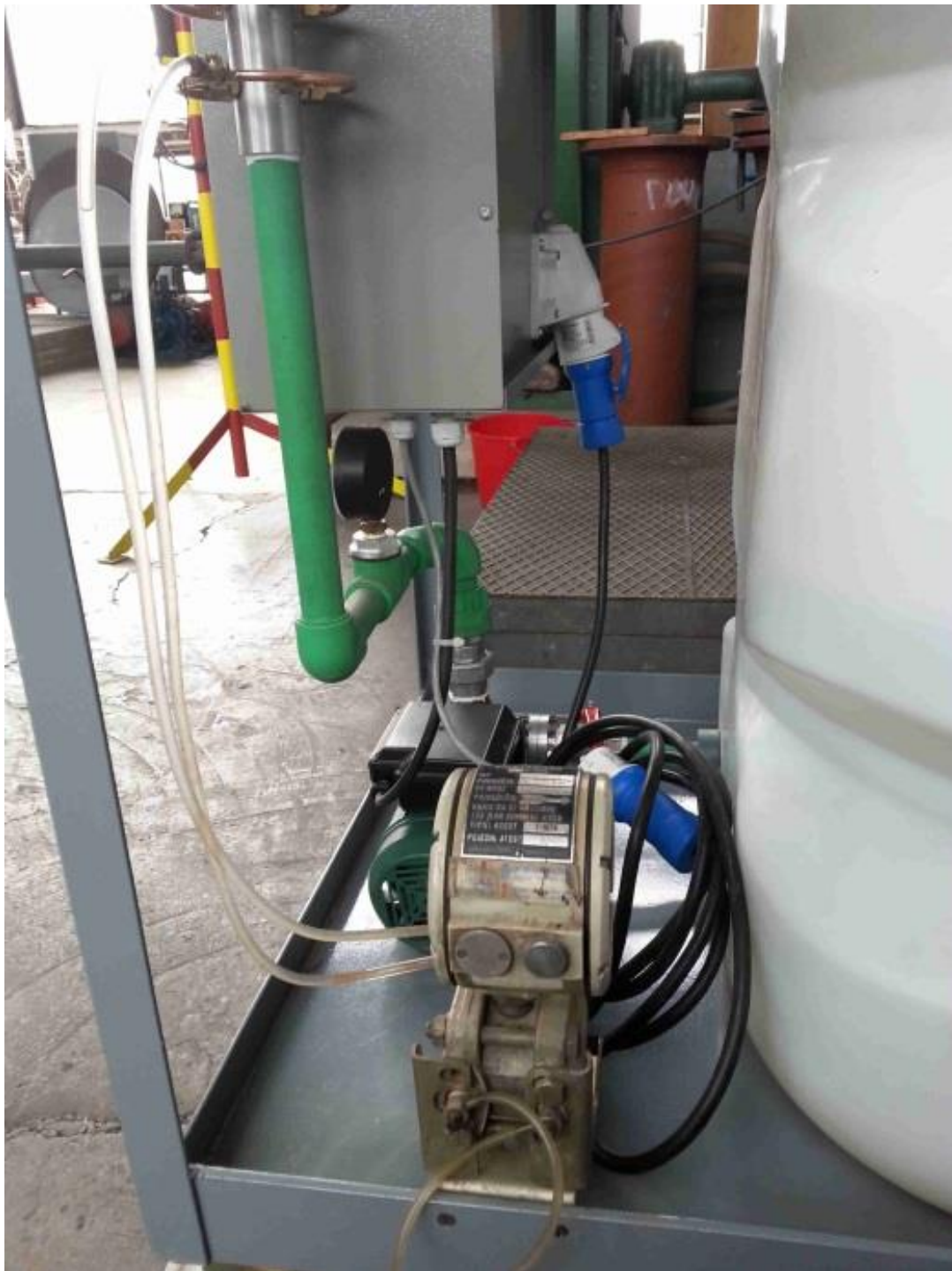
Slika 8. Stvarna izvedba mjernog lanca za mjerenje protoka
