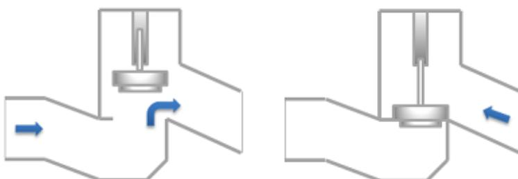
**Slika 4. Skica nepovratnog ventila s podiznim pladnjem**
