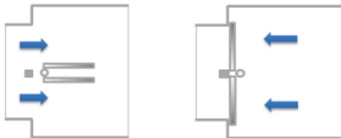
**Slika 3. Skica nepovratnog ventila s dvostrukom klapnom**
