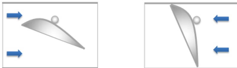
Slika 2. Skica nepovratnog ventila s ekscentrom
