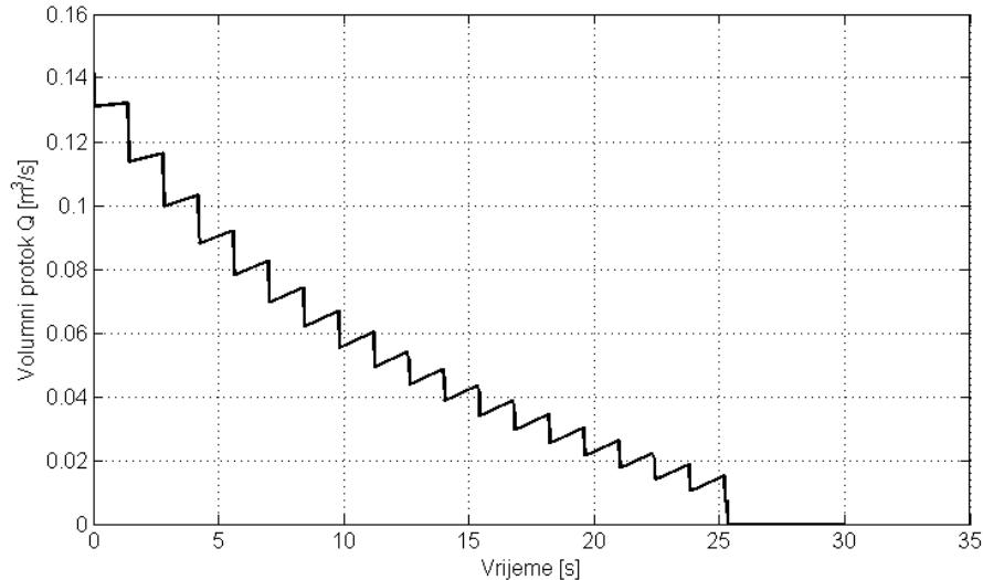
**Slika 43. Protok kroz ventil tijekom i neposredno nakon zatvaranja ventila**
