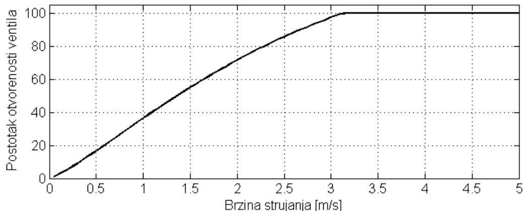
Slika 30. Postotak otvorenosti ventila ovisno o brzini strujanja
