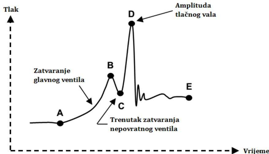
Slika 6. Primjer karakteristične krivulje tlaka očitane senzorom
