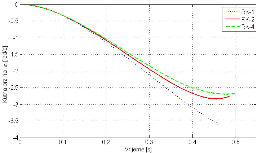
Slika 35. Kutna brzina klapne tijekom zatvaranja.
