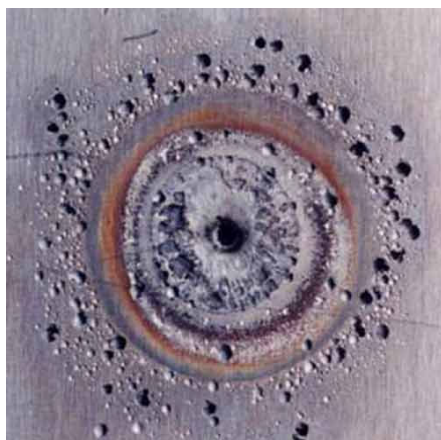
Slika 4. Primjeri jamičaste korozije [15]
