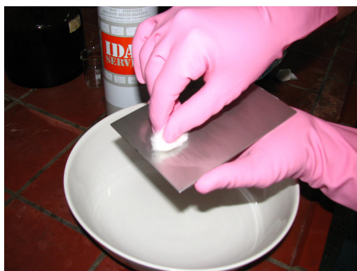
Slika 12. Odmašćivanje u alkoholu
