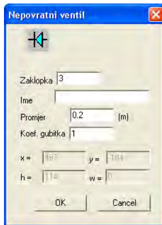
Slika 12. Okvir dijaloga nepovratnog ventila u programskom alatu Pipeline
