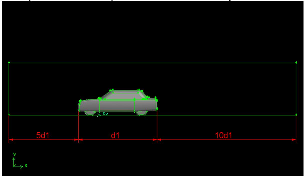
Slika 5.9 Odnos duljine zračnog tunela i automobila (nacrt)
