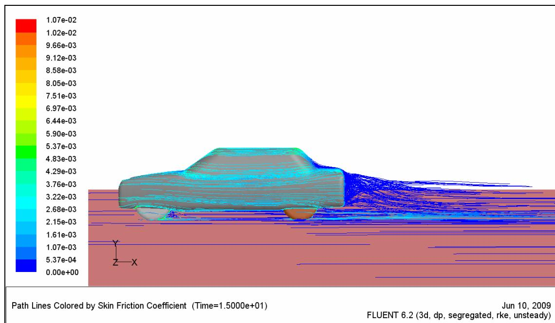
Slika 5.26 Strujnice obojane raspodjeljom koeficijenta trenja na površini – nacrt
