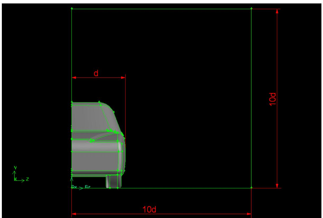
Slika 5.10 Odnos širine i visine zračnog tunela i automobila (bokoert)
