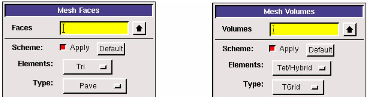
Slika 5.11 Vrste diskretizacijskih elemenata (lijevo za površinu, desno za volumen)
