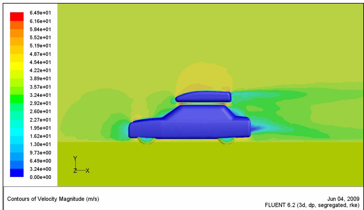
Slika 6.11 Konture raspodjele iznosa brzine – na simetriji
