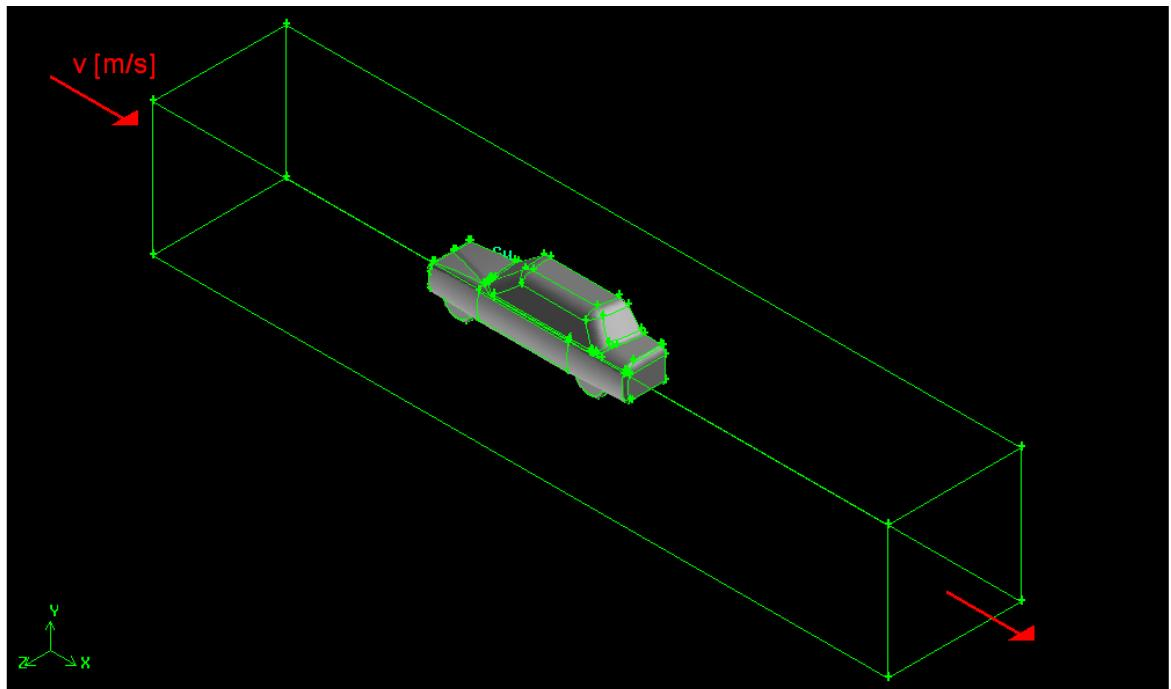
Slika 5.6 Prikaz koncepta - automobil u zračnom tunelu
