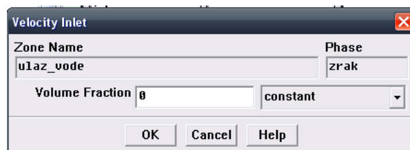
Slika 20: Definiranje rubnog uvjeta za sekundarnu fazu
