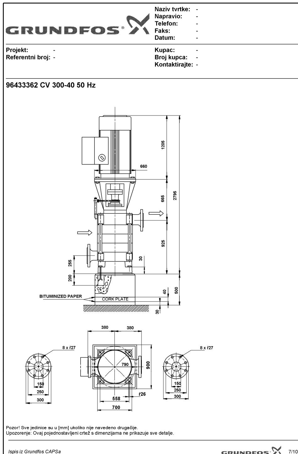
slika 3.6 – vanjske mjere pumpe
