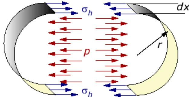
slika 4.4 – tlak i naprezanje u poprečnom smjeru
