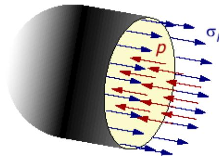
slika 4.3 – tlak i naprezanje u uzdužnom smjeru
