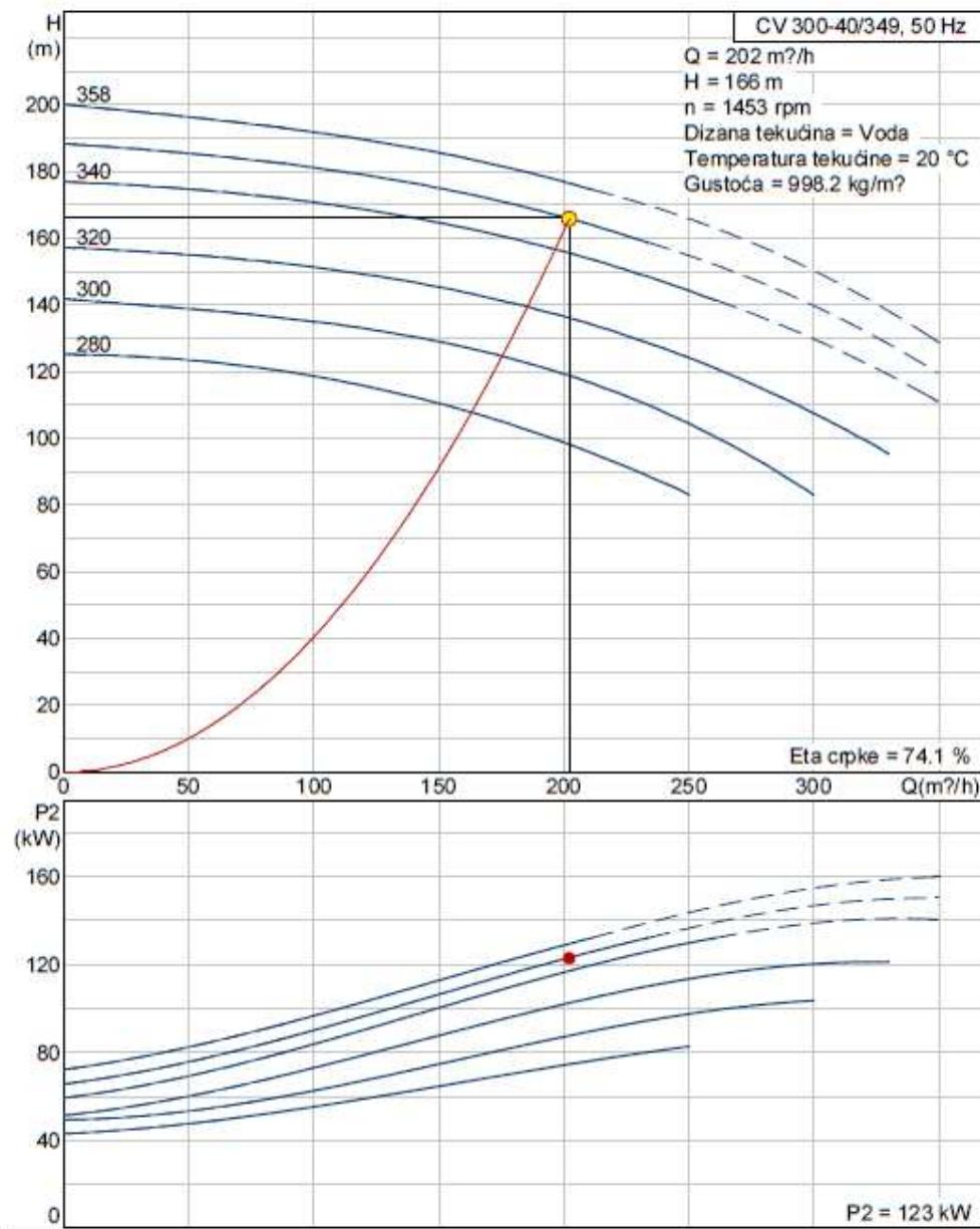
dijagram 3.1 - karakteristike pumpe dobivene od proizvođača
