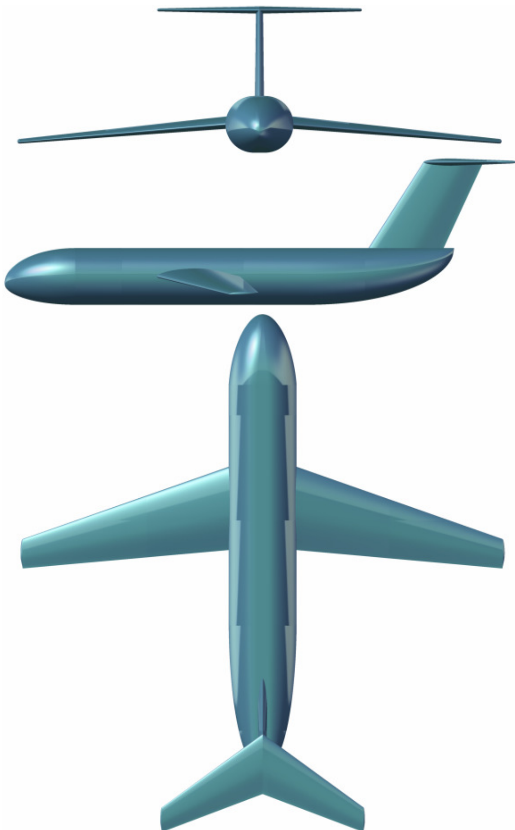
Slika 4-3 Tri projekcije odabrane konfiguracije zrakoplova
