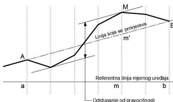
**Slika 21. Mjerenje pravocrtnosti bazirano na mjerenju duljine [8]**
