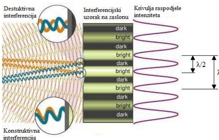
**Slika 36. Prikaz konstruktivne i destruktivne interferencije na zaslonu [16]**
