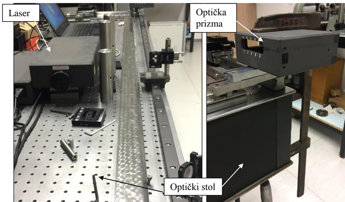
Slika 52. Laser i optička prizma postavljeni na stol
