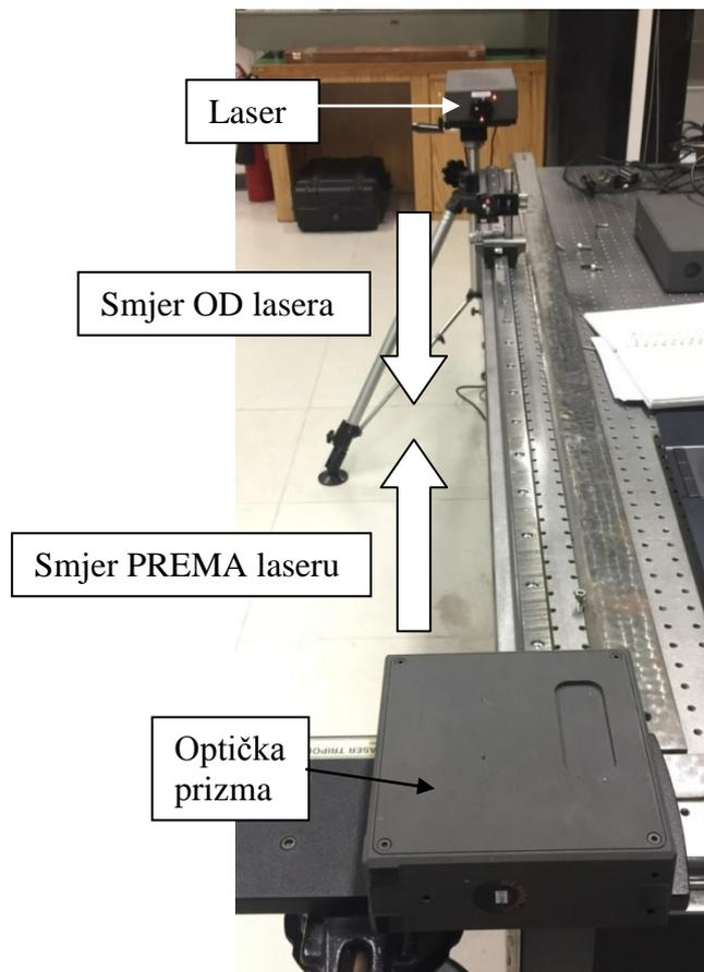
**Slika 65. Smjer OD i PREMA laseru na vodilici u smjeru osi X**
