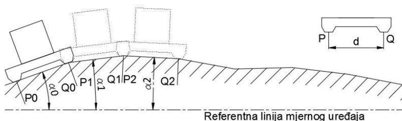
**Slika 22. Mjerenje pravocrtnosti bazirano na mjerenju kutova [8]**
