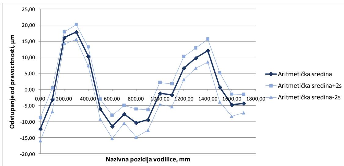
**Slika 73.** Aritmetička sredina horizontalnih odstupanja od pravocrtnosti mjerenja u smjeru osi *X* – autokolimator
