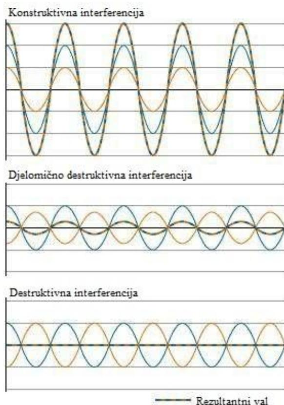
**Slika 34. Primjer konstruktivne i destruktivne interferencije [16]**
