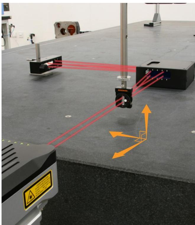
**Slika 46. Računanje odstupanja od okomitosti interferometrom [21]**
