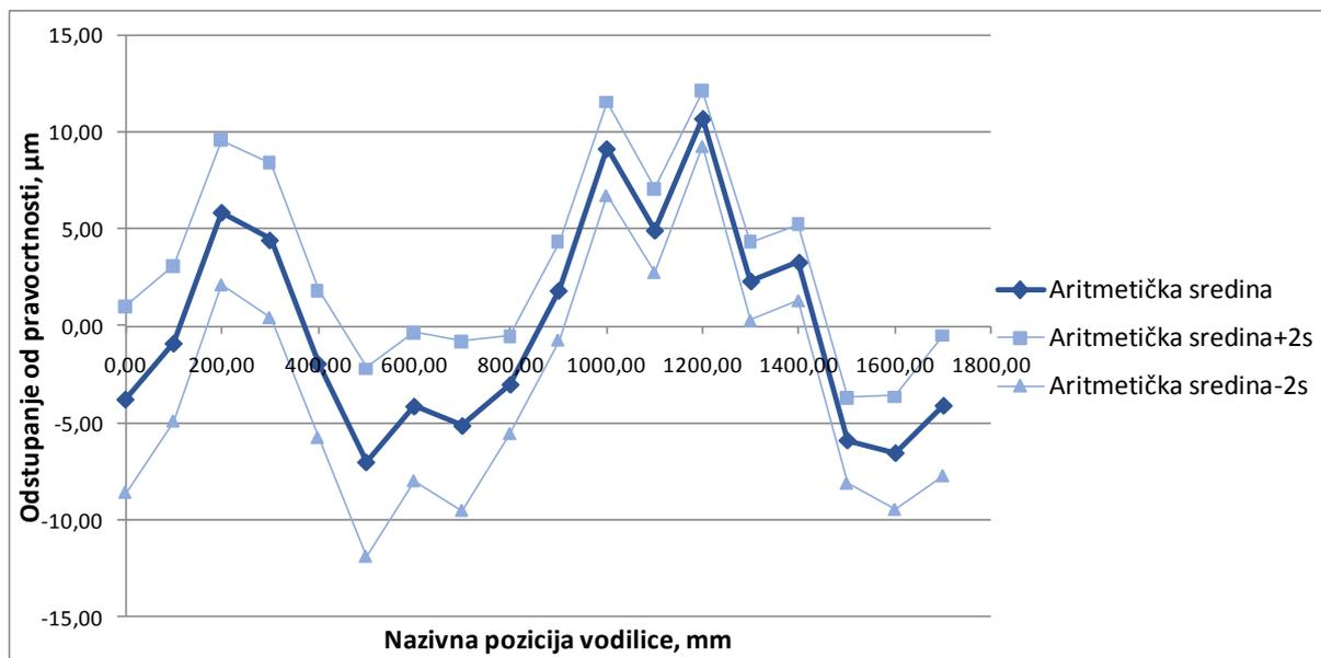
**Slika 76.** Aritmetička sredina vertikalnih odstupanja od pravocrtnosti mjerenja u smjeru osi  $X$
