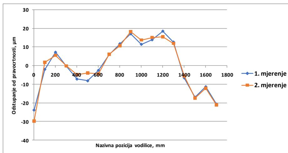
**Slika 53. Usporedba odstupanja od pravocrtnosti dobivenih ponovljivim postavljanjem operatera**
