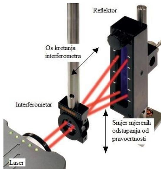
**Slika 39. Konfiguracija reflektora i interferometra za mjerenje vertikalnih odstupanja od pravocrtosti [18]**
