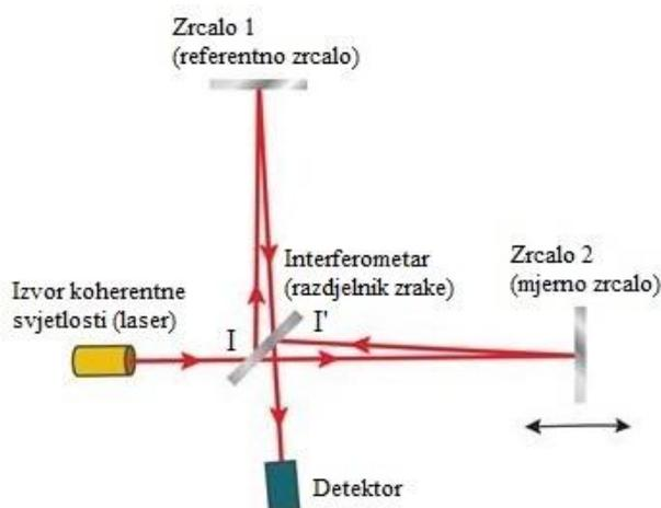
**Slika 32. Princip rada Michelsonovog interferometra [14]**
