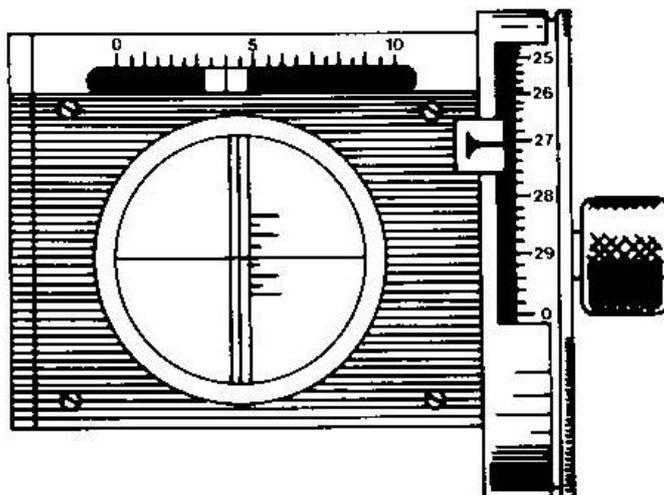
**Slika 43. Skale za očitavanje kutnog pomaka reflektora [19]**
