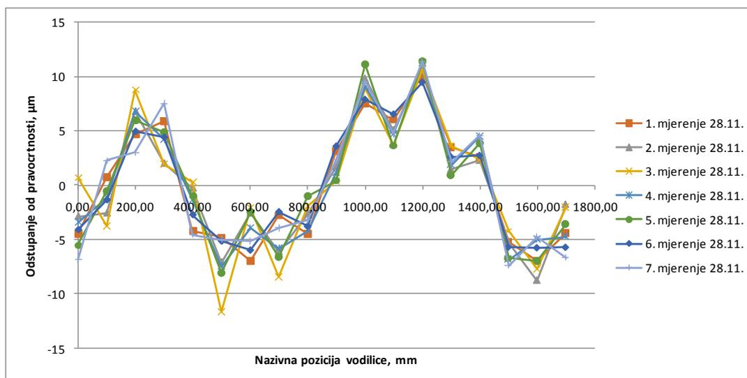
**Slika 75. Usporedba vertikalnih odstupanja od pravocrtnosti svih mjerenja u smjeru osi  $X$**
