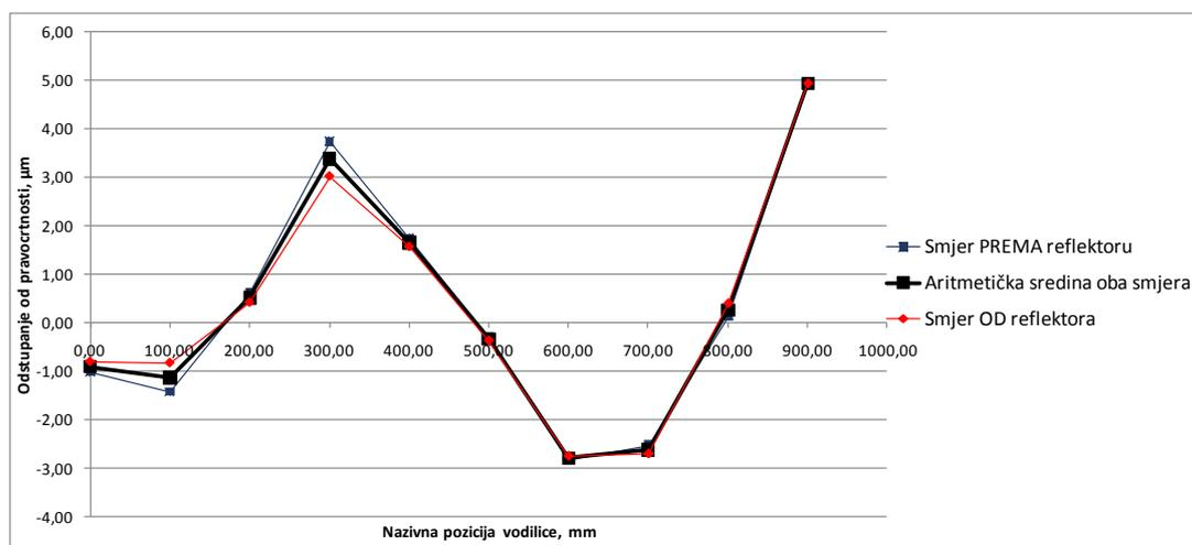
**Slika 85. Usporedba aritmetičkih sredina horizontalnih odstupanja od pravocrtnosti dvosmjernih mjerenja u smjeru osi Y – interferometar**
