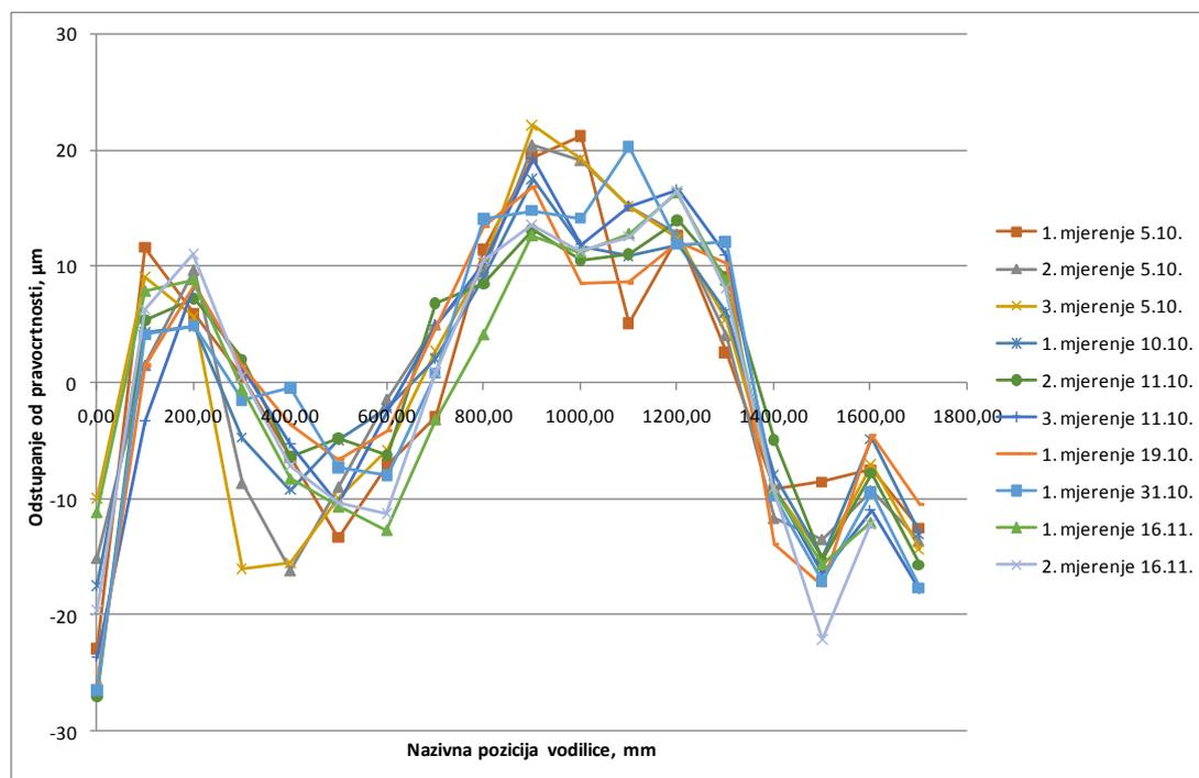
**Slika 67. Usporedba horizontalnih odstupanja od pravocrtnosti svih mjerjenja u smjeru PREMA laseru – interferometar**
