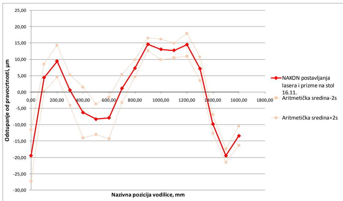
**Slika 63.** Aritmetička sredina horizontalnih odstupanja od pravocrtnosti mjerenja u smjeru osi X nakon postavljanja lasera i optičke prizme na stol – interferometar
