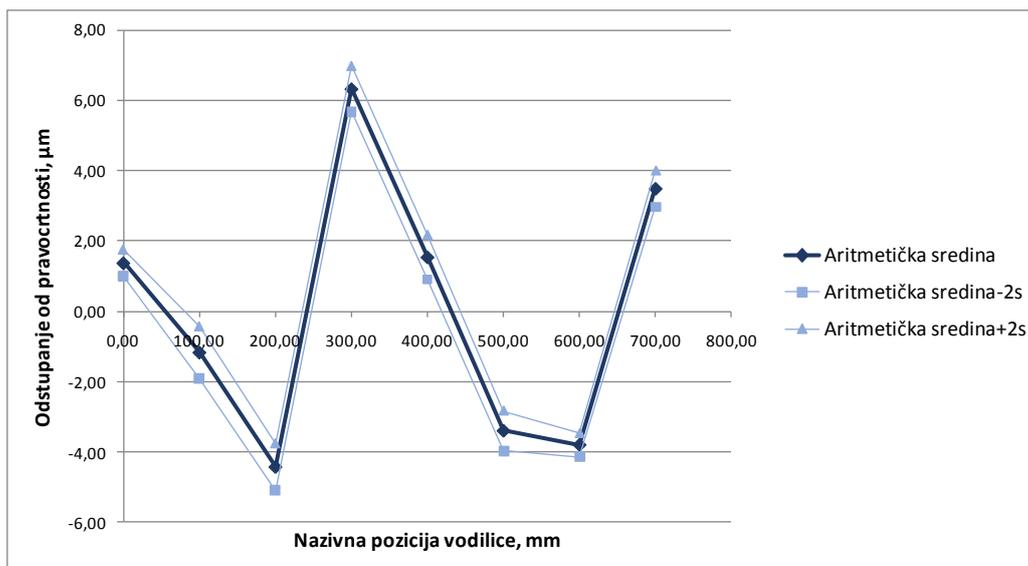
**Slika 90.** Aritmetičke sredine vertikalnih odstupanja od pravocrtnosti mjerenja u smjeru osi  $Y$
