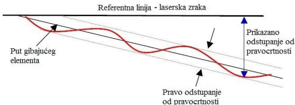
**Slika 26. Pogreška nesuosnosti referentne linije i osi predmeta mjerenja [9]**
