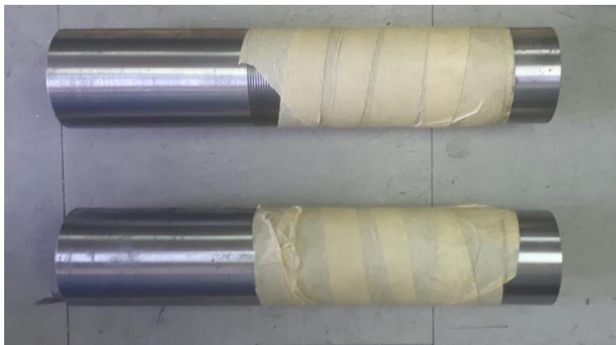
*Slika 112. Cijev noge amortizera sa narezanim navojem*
