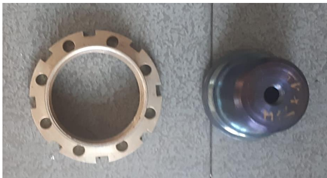
Slika 116. Dijelovi opružne noge (lijevo – matica amortizera TEIN; desno – matica noge amortizera)
