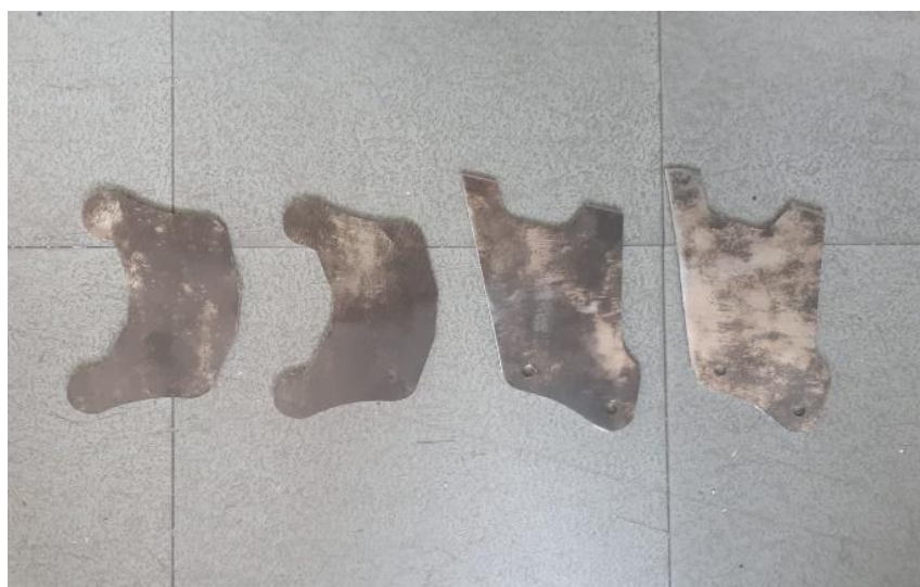
Slika 61. Limovi prikladni za diskretizaciju ljuskastim elementima
