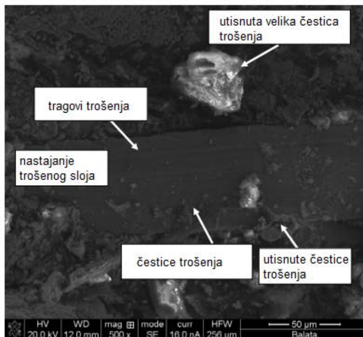
Slika 23. Snimak površine kočne pločice poslije procesa kliznog trošenja pod SEM mikroskopom[36]
