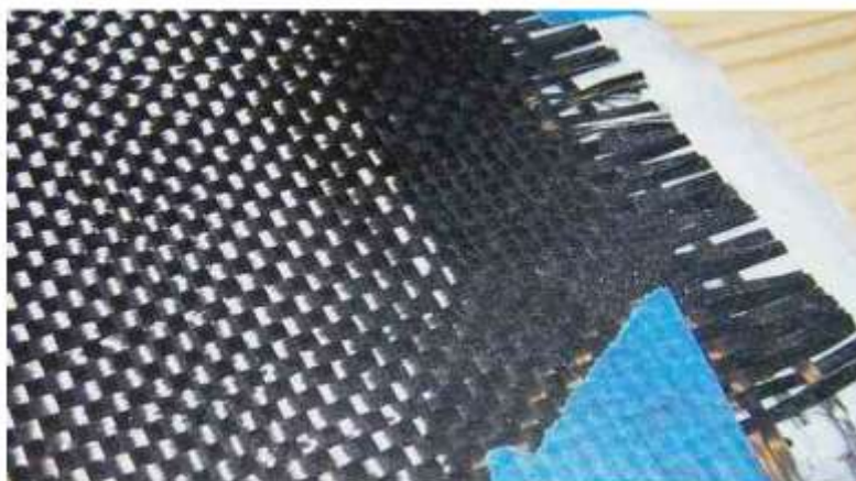
Slika 2.9. Primjer rovinga od ugljičnih vlakana [13]
