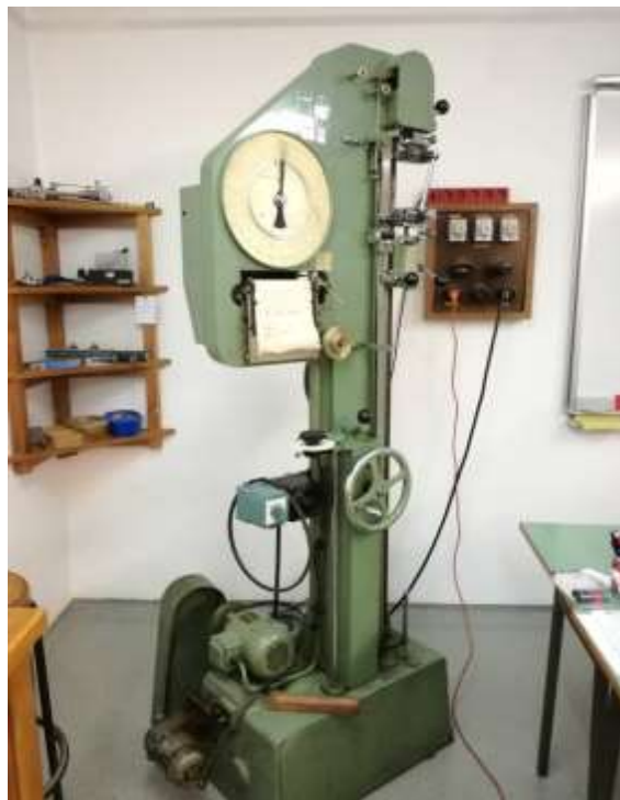
Slika 5.11. Kidalica za statično vlačno ispitivanje
