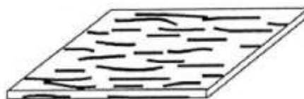
Slika 2.6. Primjer usmjerenog ojačanja kratim vlaknima [37]
