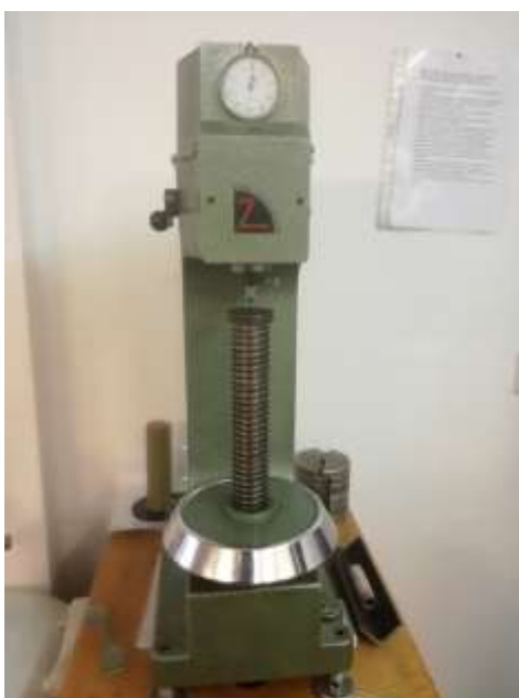
Slika 5.34. Tvrdomjer za ispitivanje tvrdoće
