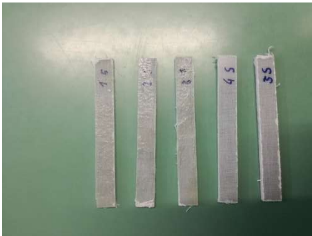
Slika 5.21. Epruvete spremne za savojno ispitivanje
