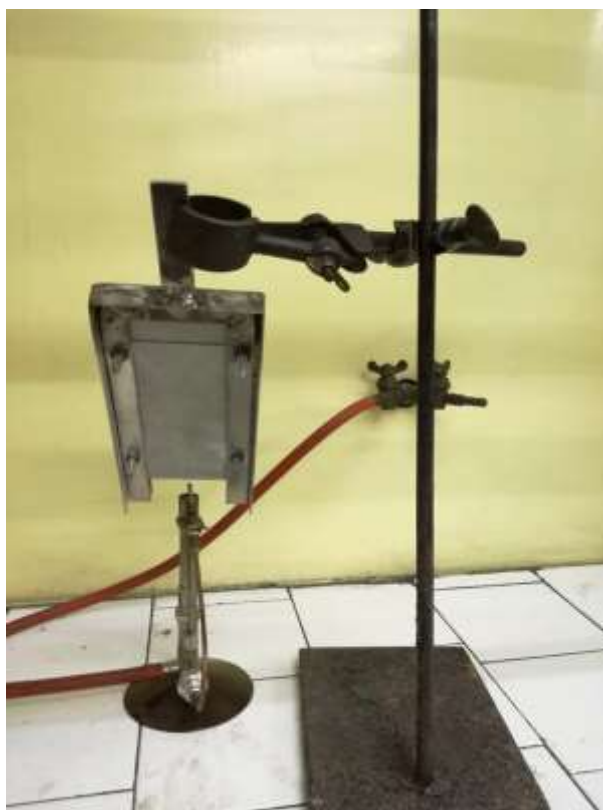
Slika 5.37. Epruveta spremna za ispitivanje samogasivosti
