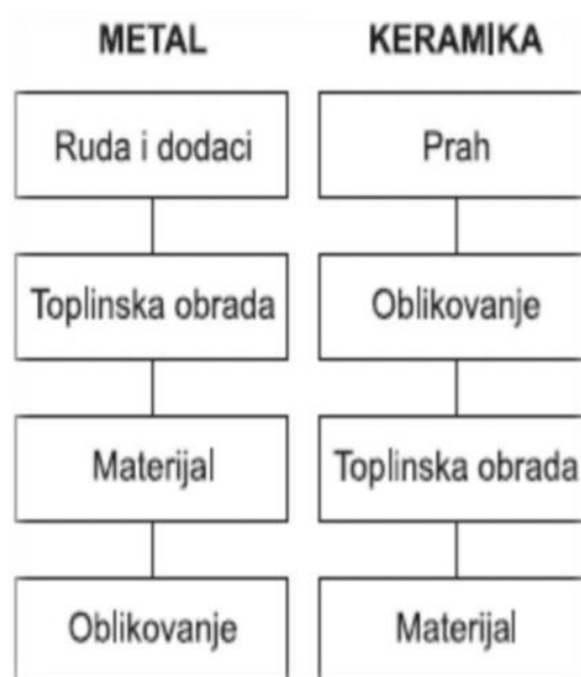
Slika 1. Usporedba procesa proizvodnje metala i keramike [2]
