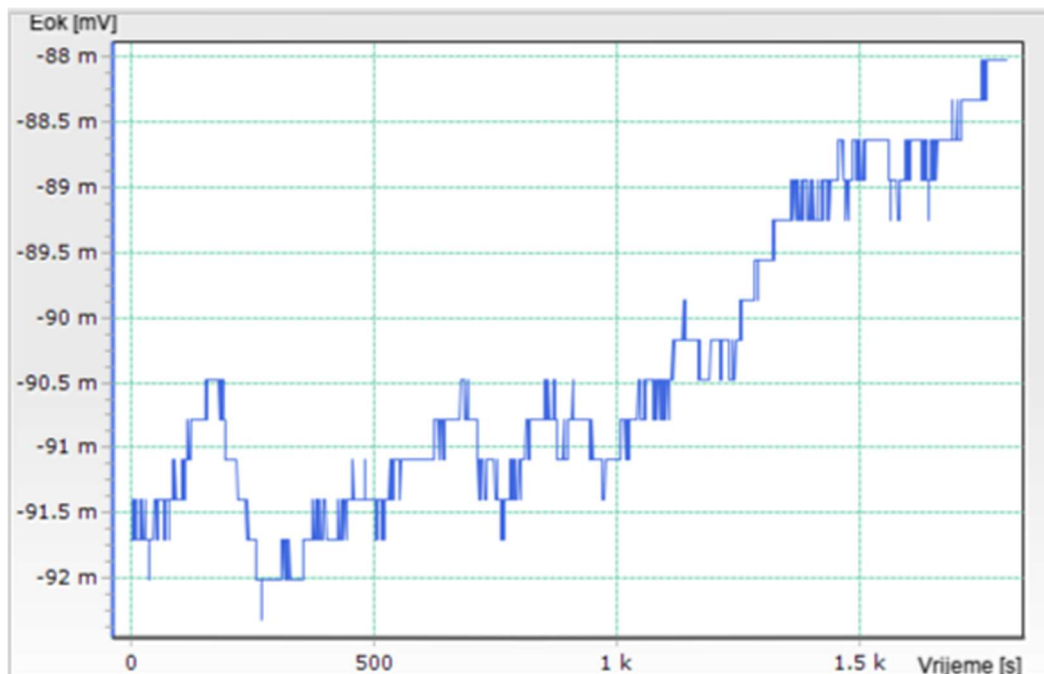
Slika 38. Dijagram potencijala otvorenog strujnog kruga za polazno stanje Ti6Al4V
