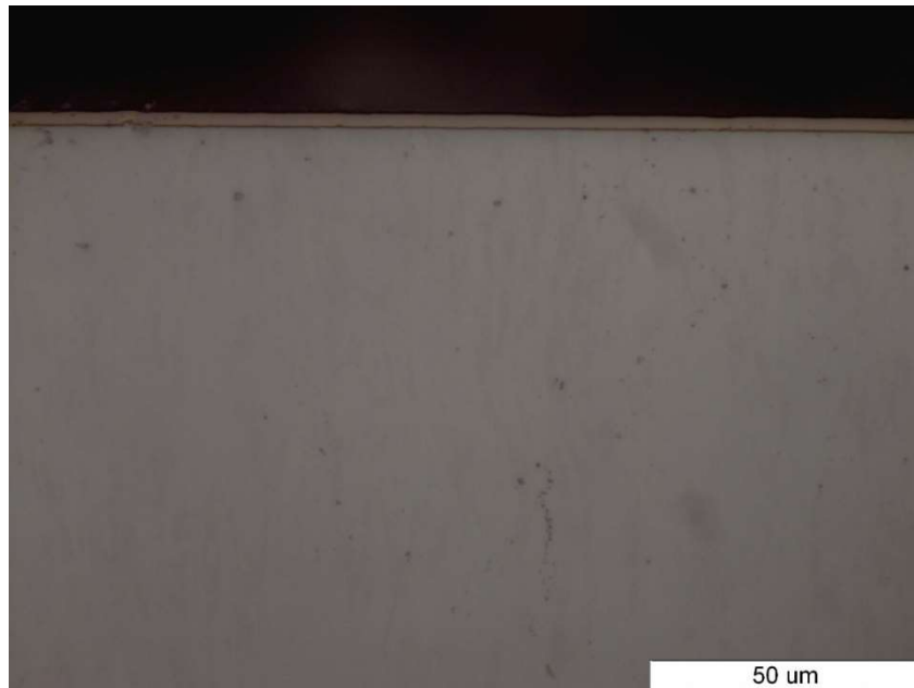
Slika 49. Prikaz rubnog sloja uzorka prevučenog PACVD postupkom
