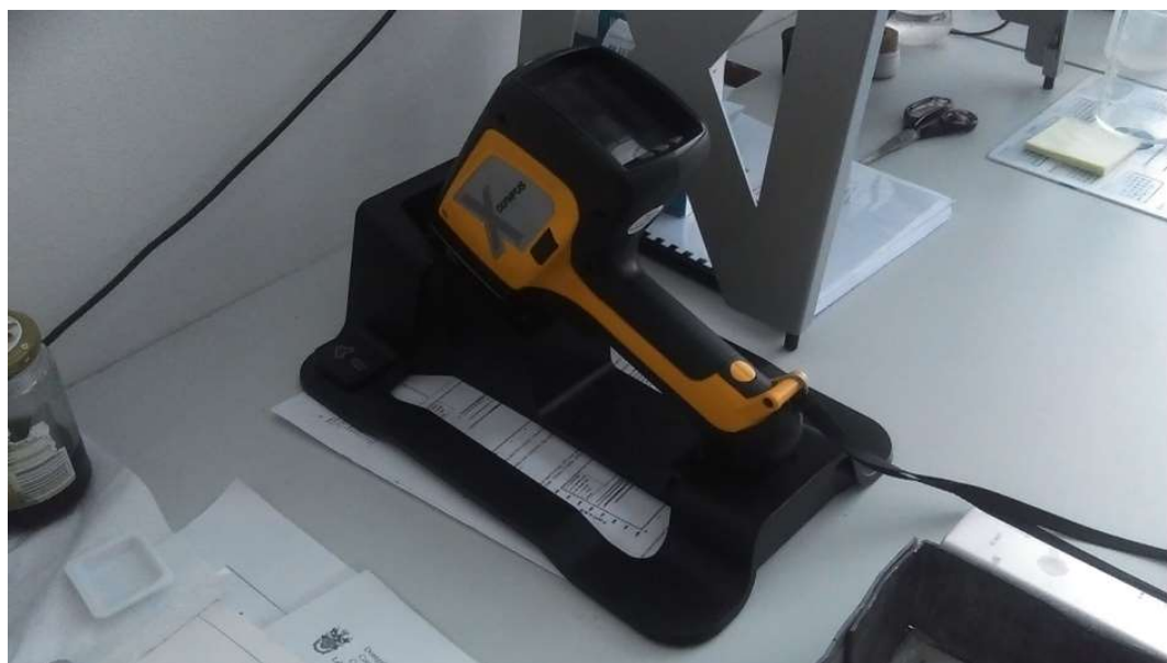
Slika 17. Uređaj Olympus X za određivanje kemijskog sastava
