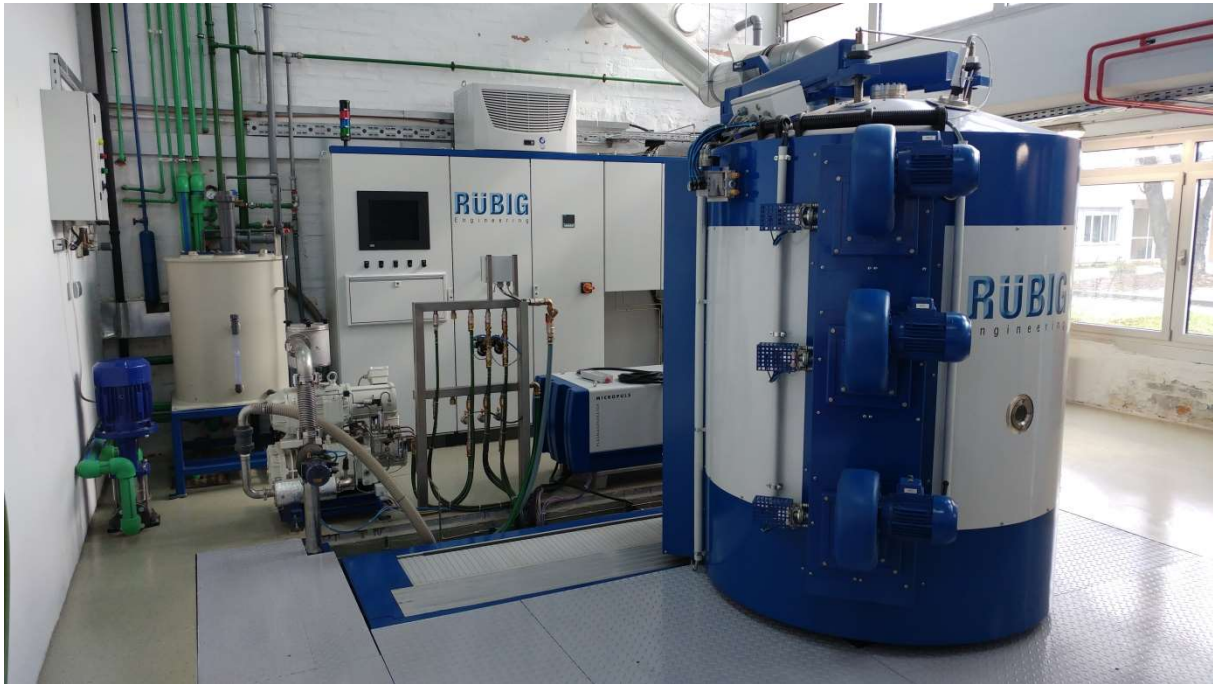
Slika 18. Uređaj za nitriranje u plazmi i prevlačenje postupkom PACVD
