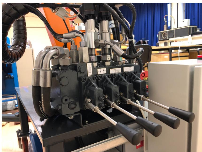
Slika 2. Proporcionalni ventilski blok s označenim segmentima
