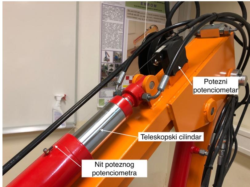
**Slika 17. Linearni potenciometar s djelomično izvučenom poteznom nitijem**
