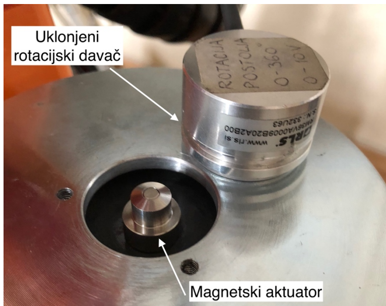
Slika 14. Magnetski aktuator beskontaktnog rotacijskog davača kuta zakreta postolja
