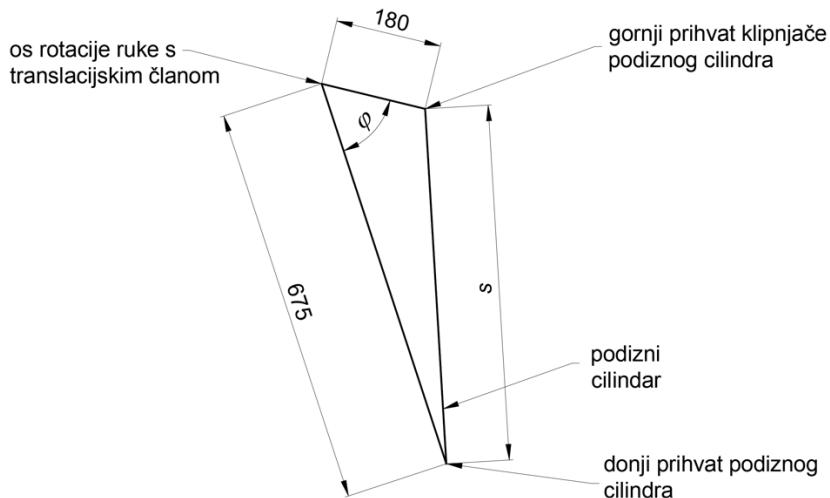
**Slika 39. Skica izmjerениh geometrijskih odnosa podiznog cilindra i osi rotacije ruke s translacijskim članom**
