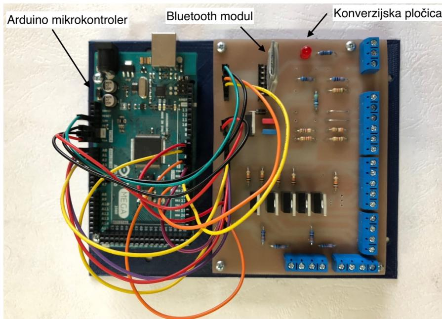
**Slika 8. Konverzijska pločica povezana s Arduino mikrokontrolerom [1]**
