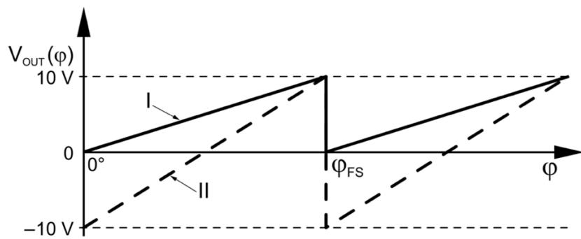
**Slika 12.** Prikaz izlaznog signala rotacijskog davača u ovisnosti o kutu s mjernim područjem označenim oznakom  $\phi_{FS}$  [5]
