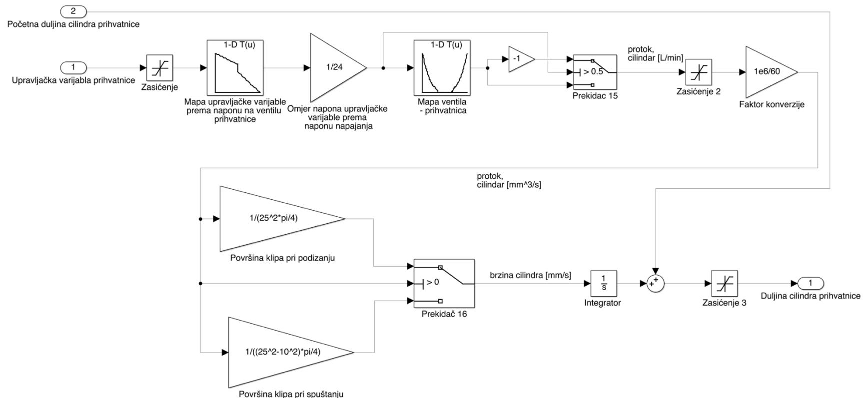
Slika 42. Simulacijski model upravljanja cilindrom prihvavnice
