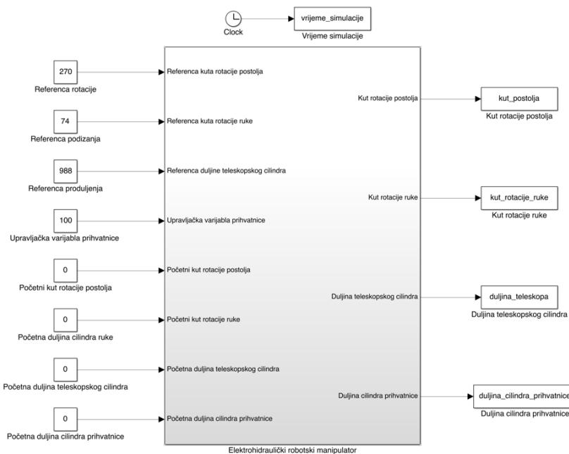
Slika 34. Simulacijski model elektrohidrauličkog robotskega manipulatora
