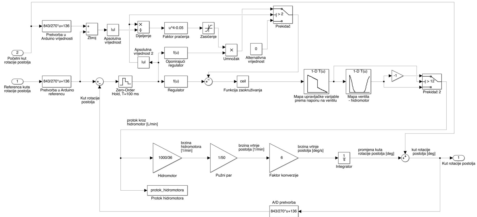
Slika 38. Simulacijski model prvog stupnja slobode gibanja manipulatora, rotacija postolja
