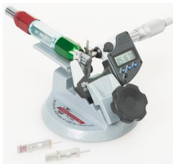
Slika 4. Korištenje valjčića u prihvatima[5]
