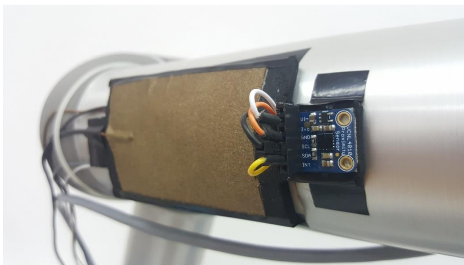
Slika 26. Osjetilni modul montiran na robotsku ruku (2)
