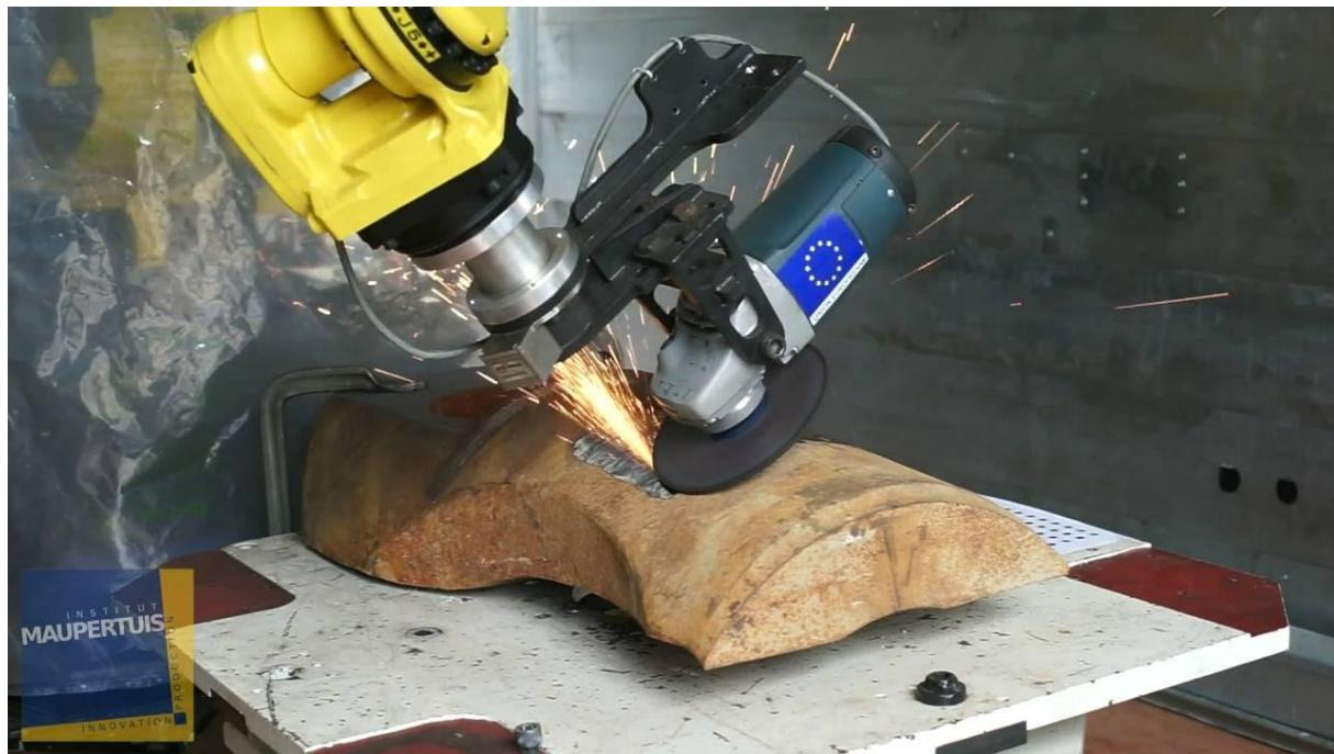
Slika 2. Brušenje zahtjevnije površine pomoću robota
