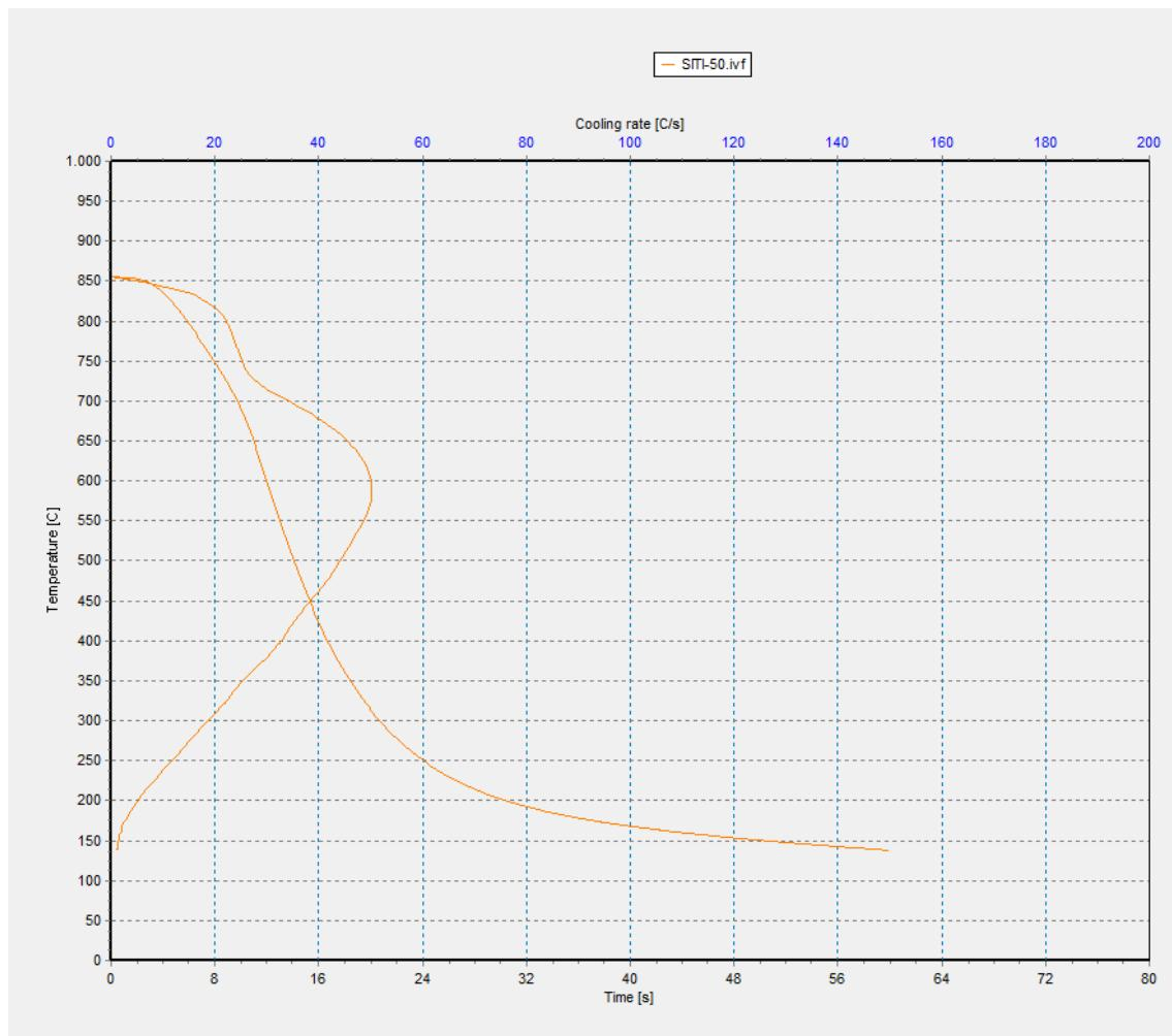
**Slika 20. Karakteristike ohlađivanja ispitivanog uzorka ulja za kaljenje označe SITI- 50°C**
