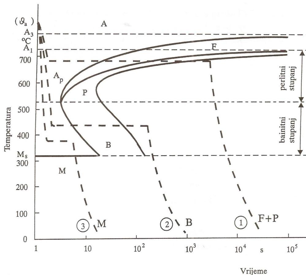
Slika 5. Izotermički TTT- dijagram hlađenja jednog podeutektoidnog čelika [1]
