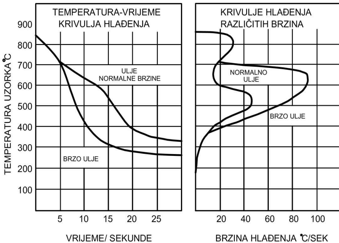
Slika 8. Usporedba brzog i normalnog ulja za gašenje:
