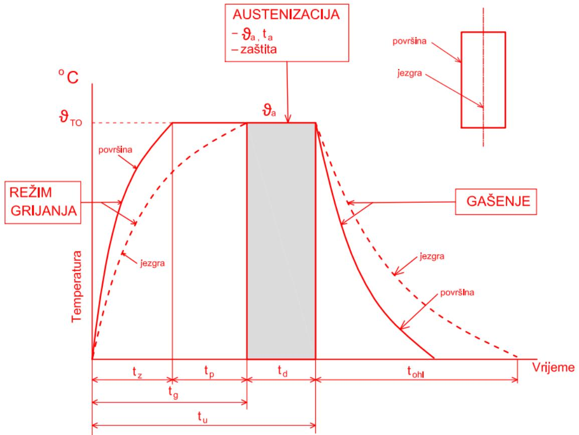
Slika 1. Općeniti T-t dijagram postupka toplinske obrade [2]
