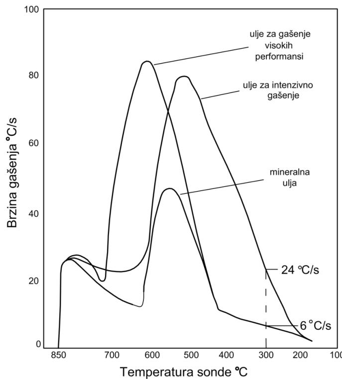
**Slika 9. Usporedba  $T\text{-}v$  dijagraama gašenja test probe legure Inconel 600 u mineralnom ulju, ulju za intenzivno gašenje i ulju za gašenje visokih performansi [7]**
