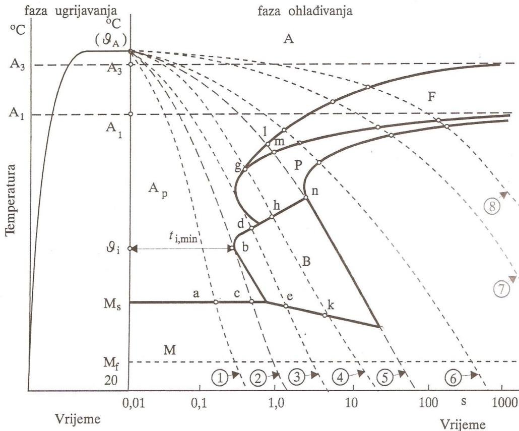
**Slika 4. TTT dijagram kontinuiranog hlađenja jednog podeutektoidnog čelika [1]**
