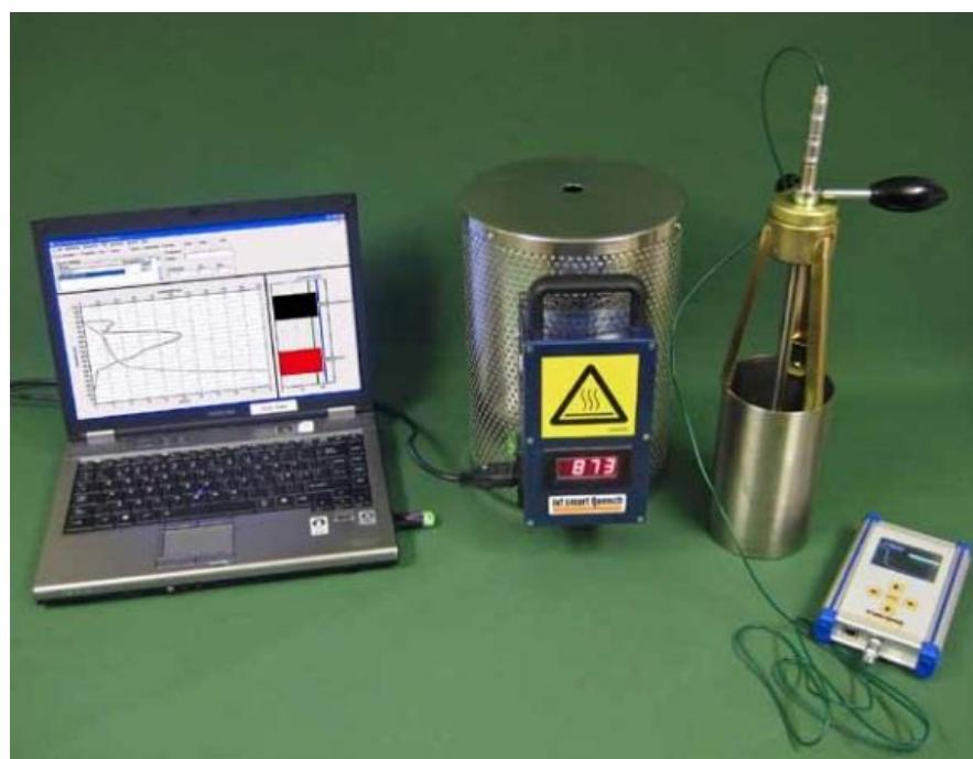
**Slika 13. Mjerni sustav IVF Smart Quench za ispitivanje
