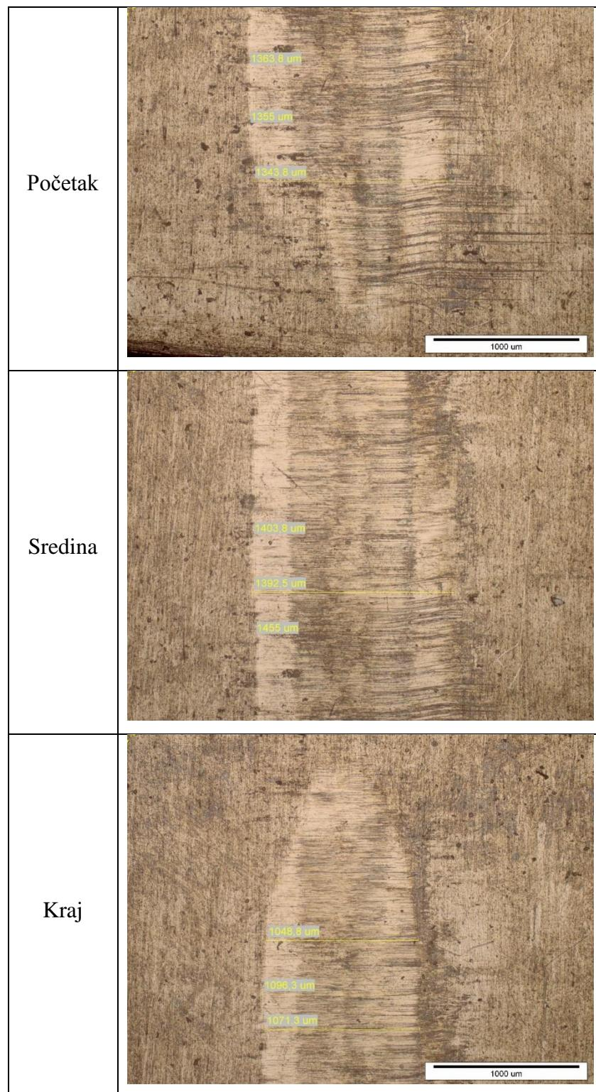
Prilog 23. Trag 2 ispitivanja adhezijskog trošenja za titanovu leguru TiAl6V4 pri opterećenju od 156,96 N.
