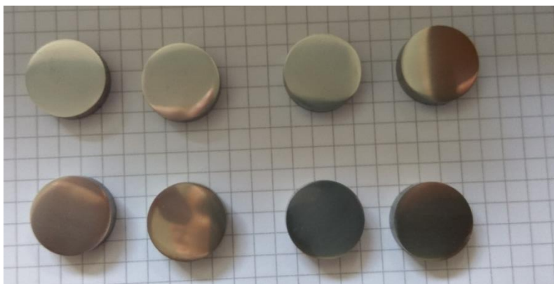
Slika 5.1 Uzorci TiAl6V4 nakon pripreme za prevlačenje
