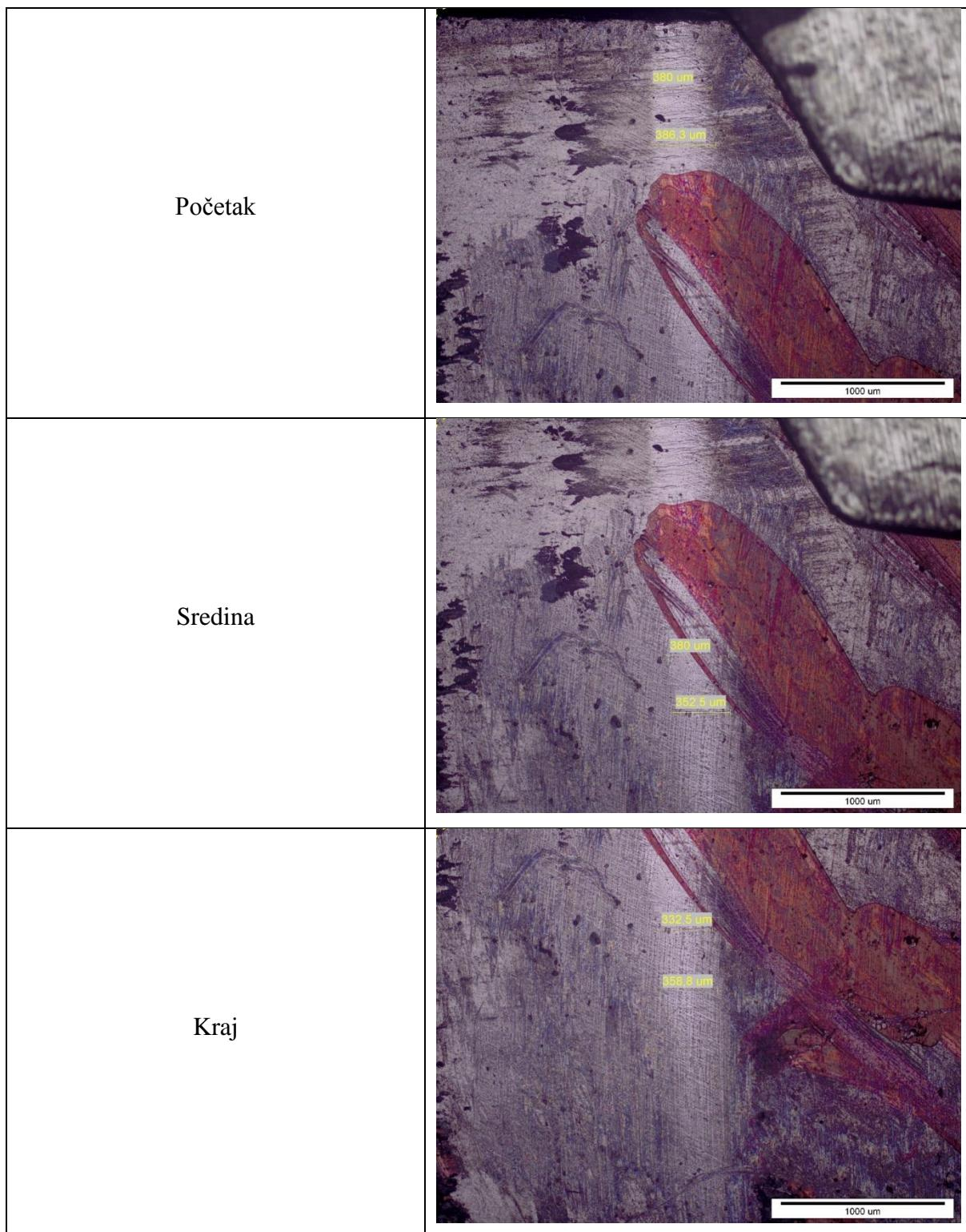
Prilog 27. Trag 6 ispitivanja adhezijskog trošenja za prevlaku TiN/TiCN pri opterećenju od 235,44 N.
