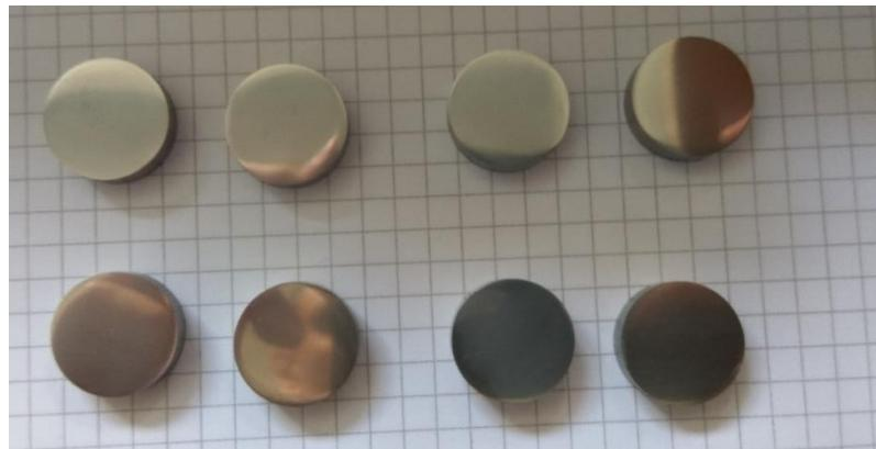
Slika 5.1 Uzorci TiAl6V4 nakon pripreme za prevlačenje
