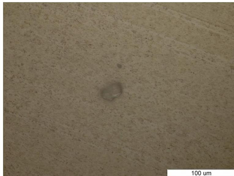
Slika 6.21 Legura TiAl6V4 nakon cikličke polarizacije
