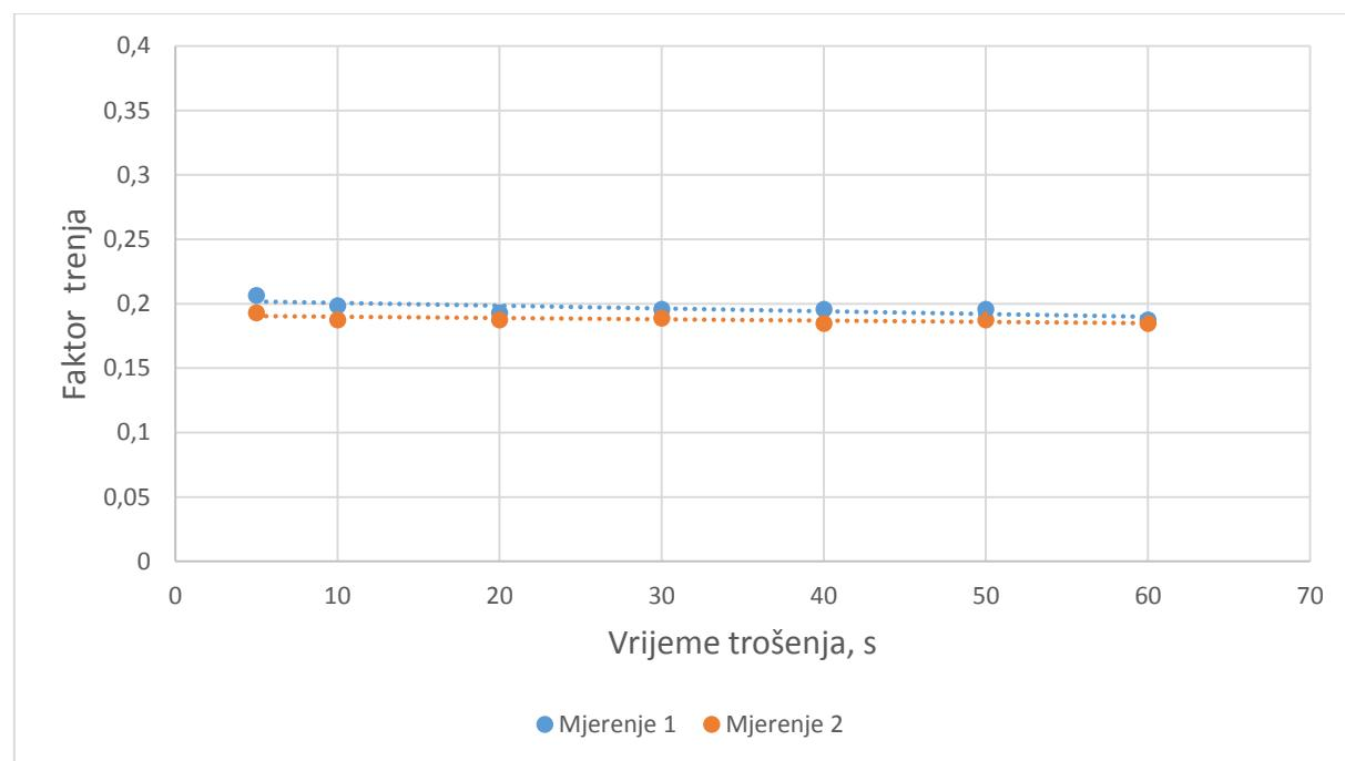
Prilog 9. Tablica i dijagram faktora trenja u ovisnosti o vremenu pri sva tri opterećenja za leguru TiAl6V4 i prevlaku TiN/TiCN.
