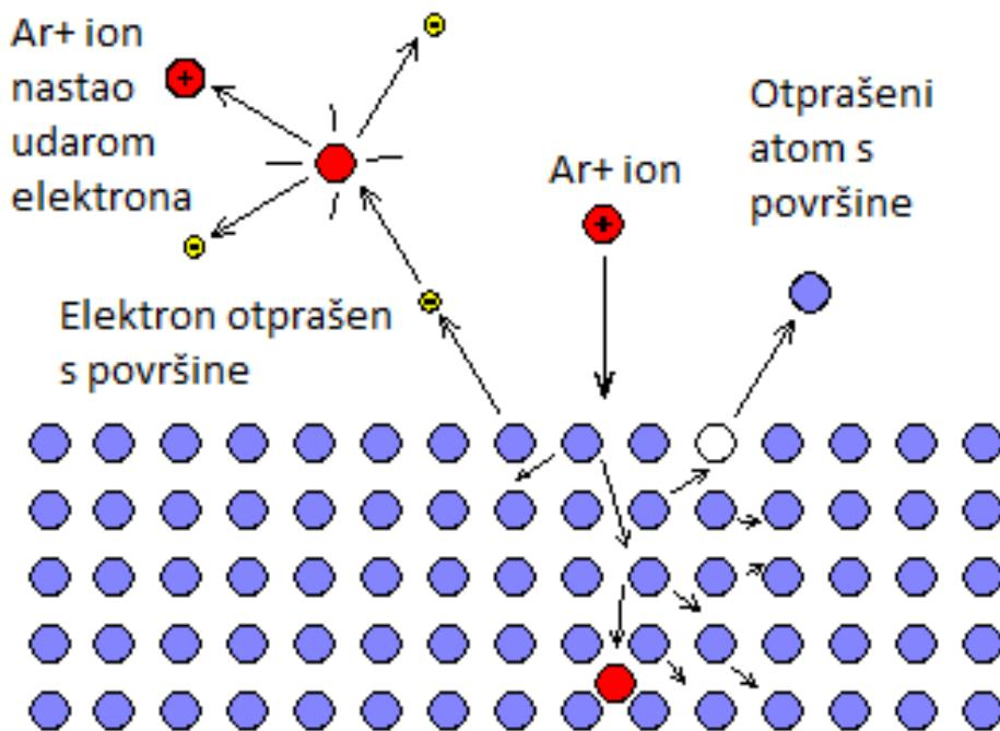
Slika 3.1 Priprema površine otprašivanjem oksida s površine [5]
