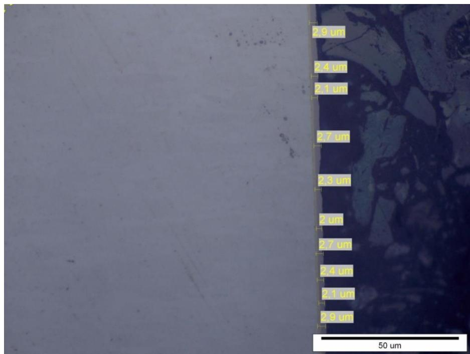
Slika 6.5 Mjerenje debljine prevlake na svjetlosnom mikroskopu
