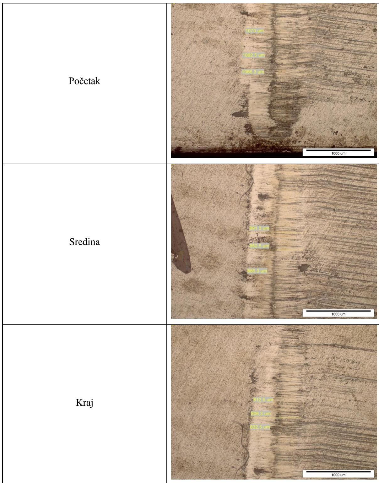
Prilog 25. Trag 4 ispitivanja adhezijskog trošenja za prevlaku TiN/TiCN pri opterećenju od 78,48 N.
