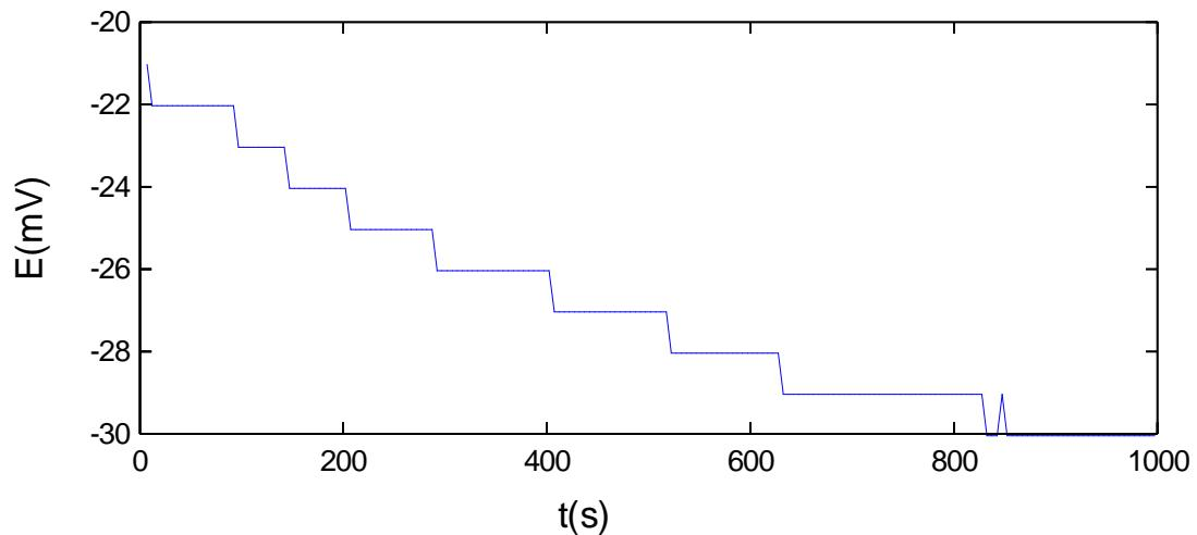
Slika 6.15 Drugo mjerjenje potencijala otvorenog strujnog kruga prevlake TiN/TiCN
