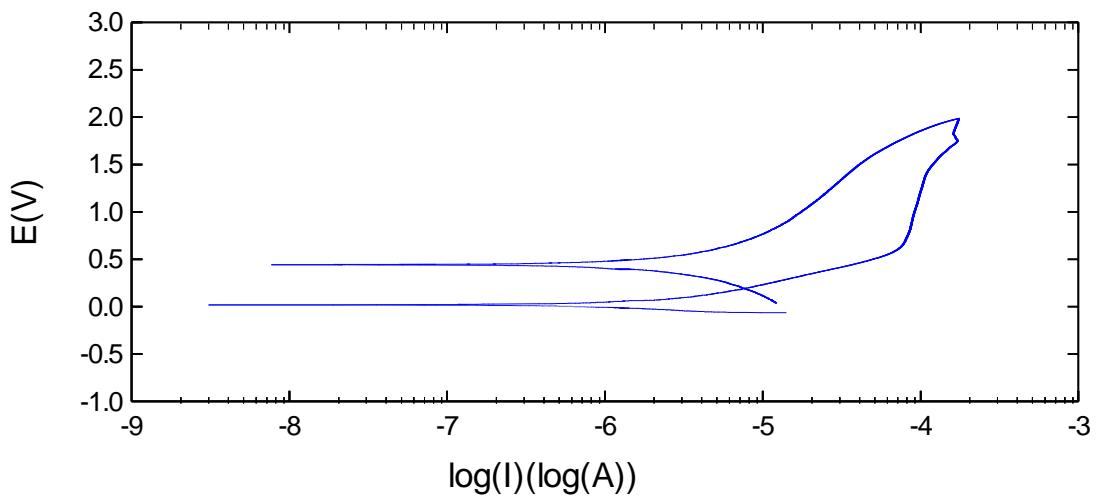
Slika 6.19 Ciklička polarizacija legure TiAl6V4
