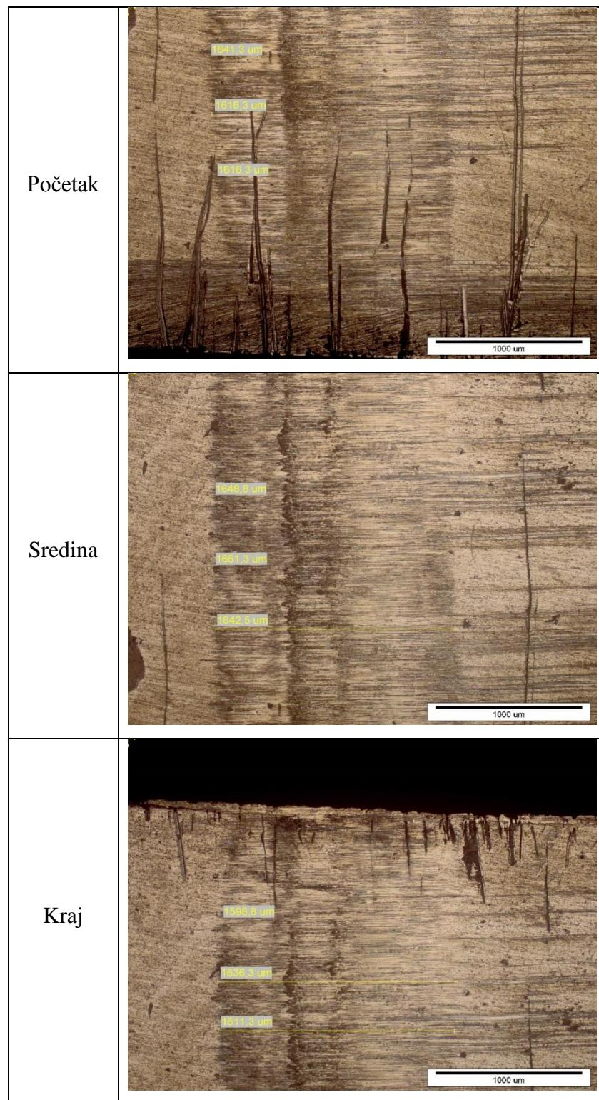
Prilog 24. Trag 3 ispitivanja adhezijskog trošenja za titanovu leguru TiAl6V4 pri opterećenju od 235,44 N.
