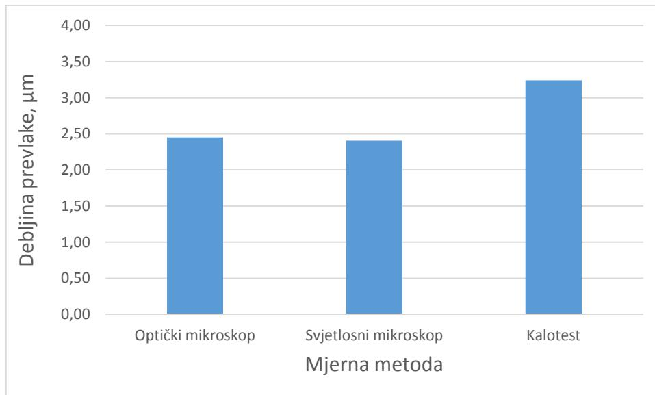
*Slika 6.7 Usporedba rezultata mjerenja debljine prevlake TiN/TiCN*
