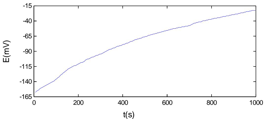
Slika 6.12 Drugo mjerene potencijale otvorenog strujnog kruga legure TiAl6V4
