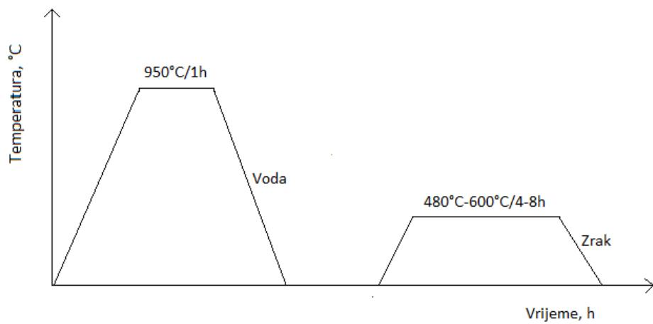
Slika 2.2 Dijagram postupka rastvornog žarenja i dozrijevanja legure TiAl6V4[12]
