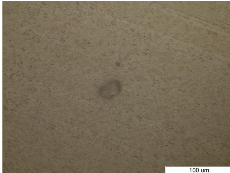
Slika 6.21 Legura TiAl6V4 nakon cikličke polarizacije
