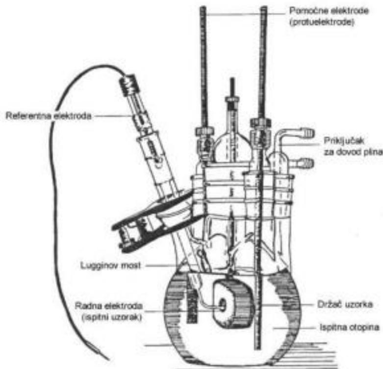
Slika 4.5 Čelija za ispitivanje elektrokemijske korozije [10]
