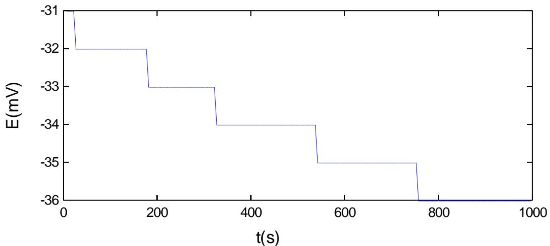
Slika 6.16 Treće mjerjenje potencijala otvorenog strujnog kruga prevlake TiN/TiCN
