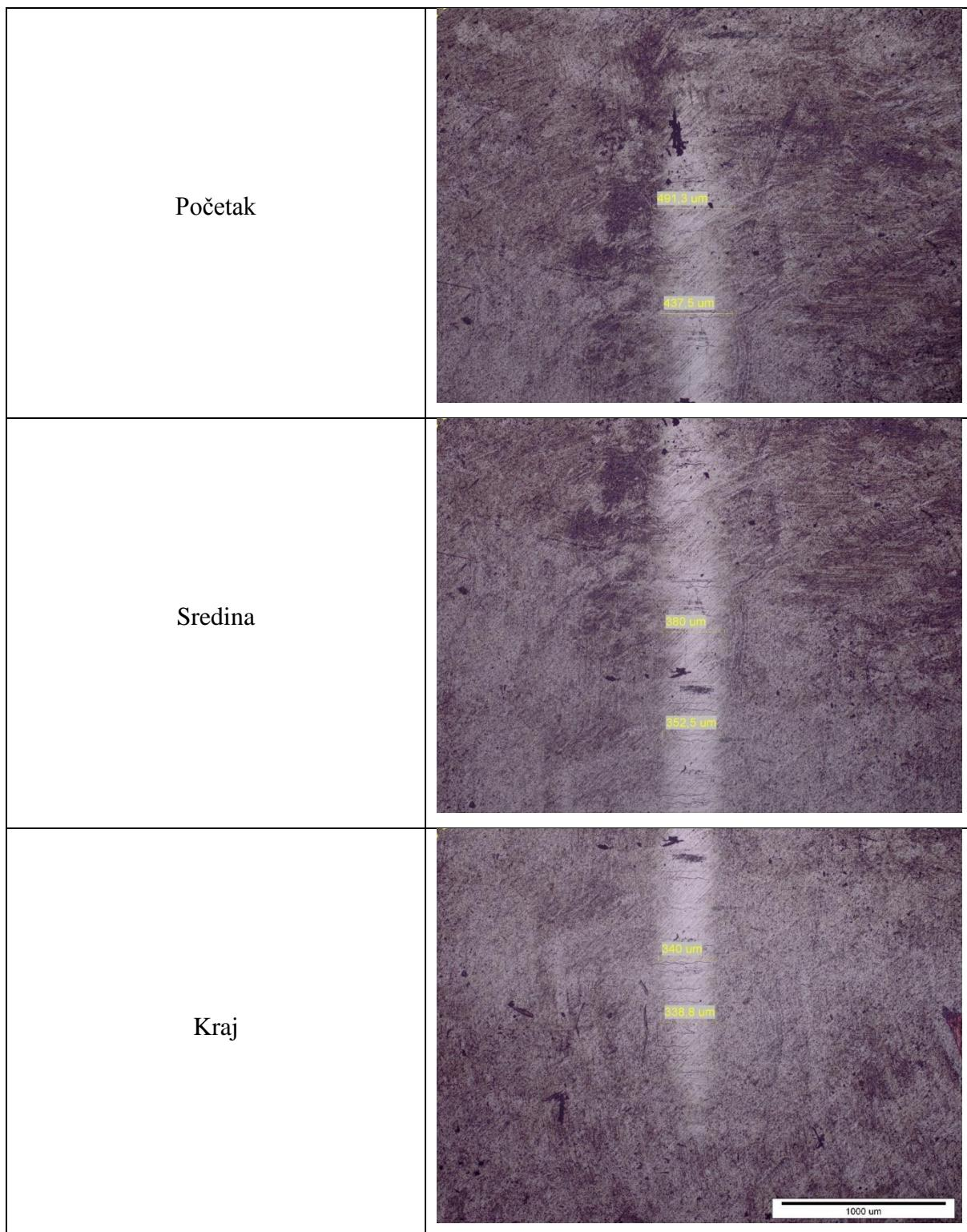
Prilog 26. Trag 5 ispitivanja adhezijskog trošenja za prevlaku TiN/TiCN pri opterećenju od 156,96 N.
