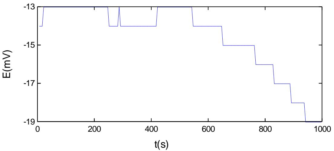
Slika 6.14 Prvo mjerjenje potencijala otvorenog strujnog kruga prevlake TiN/TiCN
