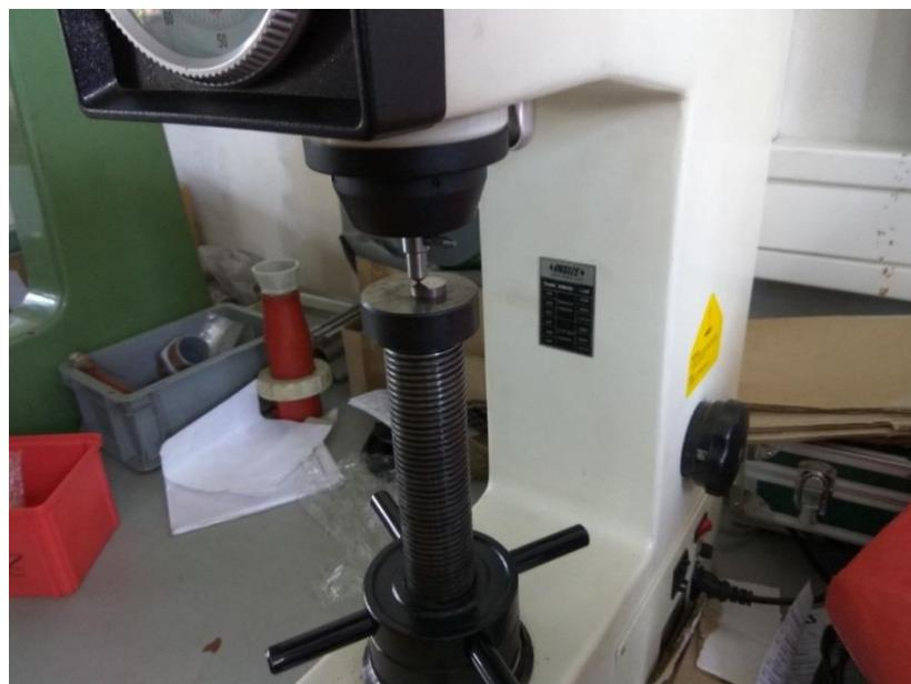
Slika 5.4 Ispitivanje adhezivnosti prevlake VDI testom
