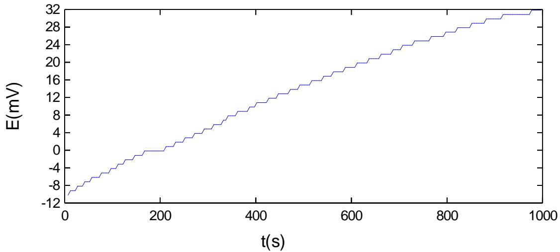
Slika 6.13 Treće mjerjenje potencijala otvorenog strujnog kruga legure TiAl6V4
