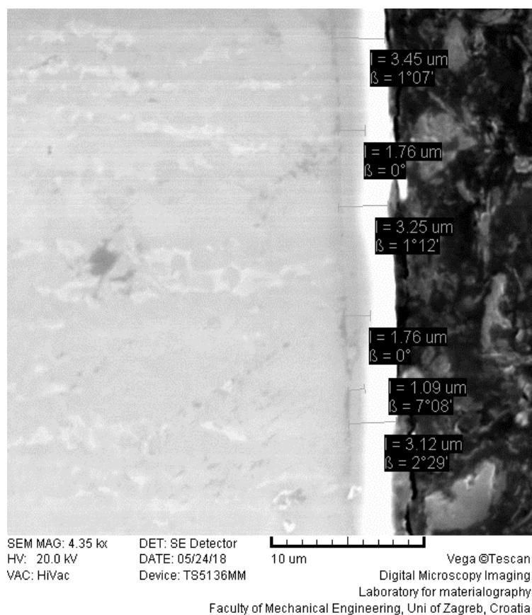
*Slika 6.6 Mjerenje debljine prevlake na elektronskom mikroskopu*
