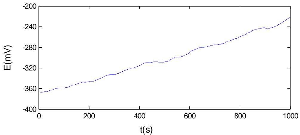
Slika 6.11 Prvo mjerene potencijale otvorenog strujnog kruga legure TiAl6V4
