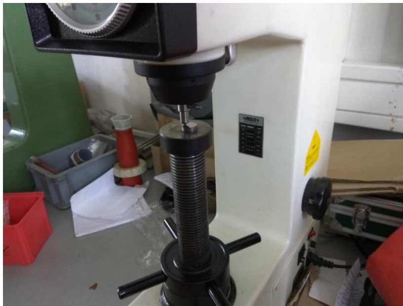
Slika 5.4 Ispitivanje adhezivnosti prevlake VDI testom
