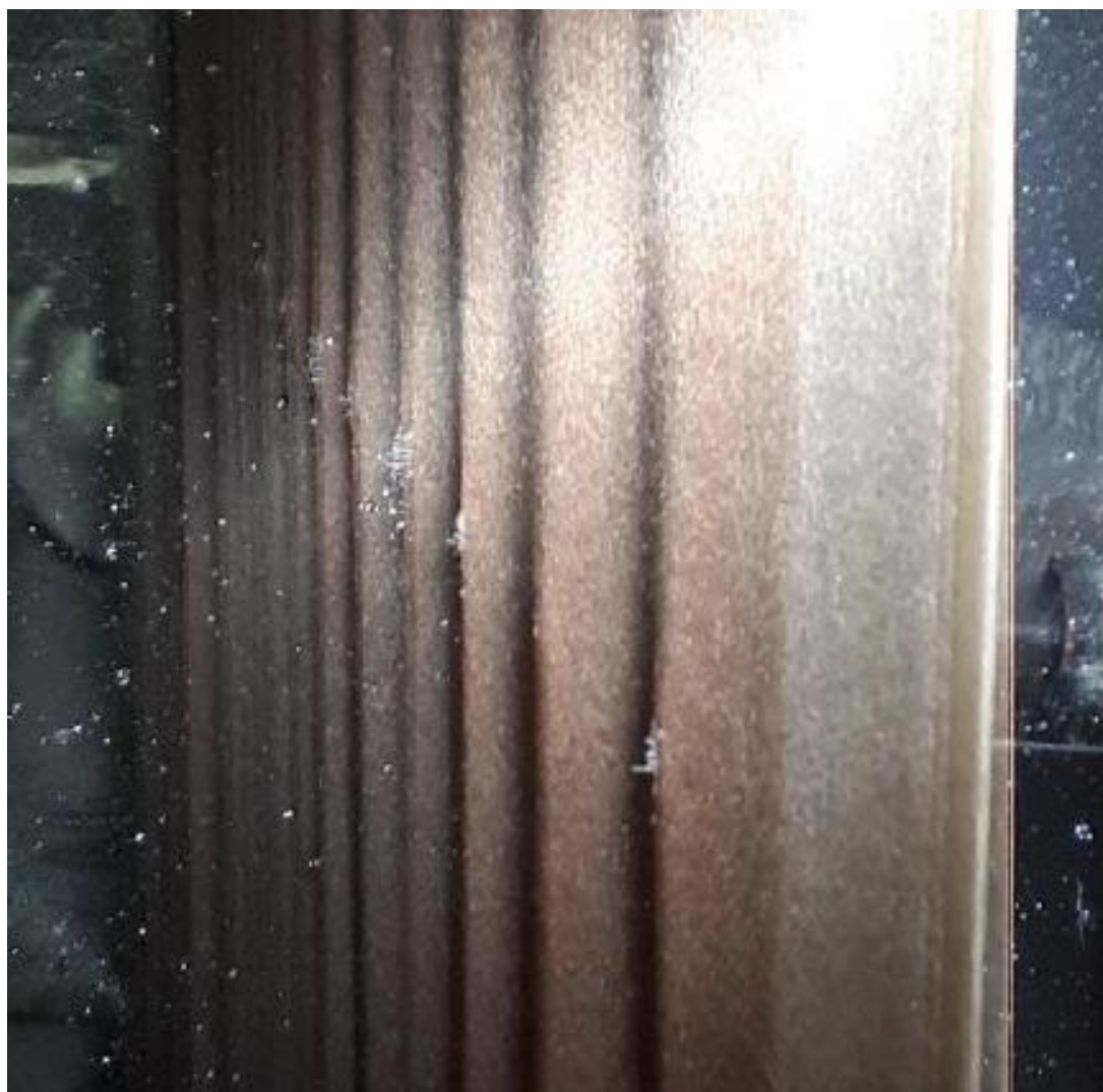
Slika 36. Stražnja strana filca prilikom pranja visokotlačnim špicama
