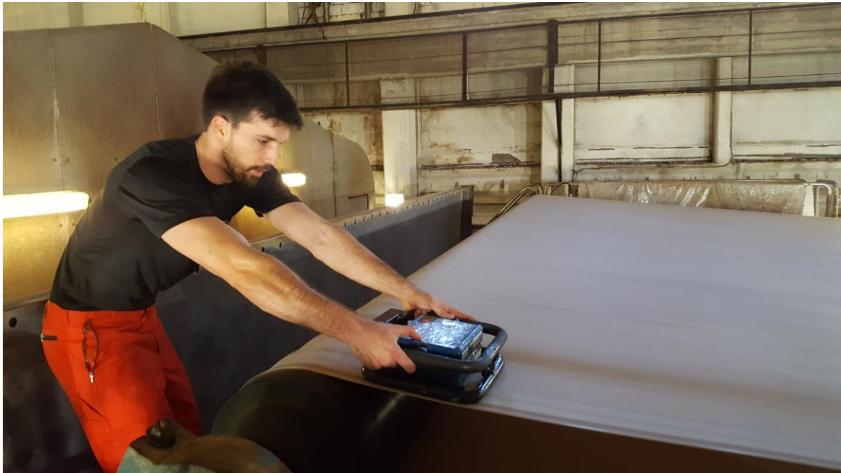
Slika 43. Postavljanje uređaja na početak filca – Cross direction before nip
