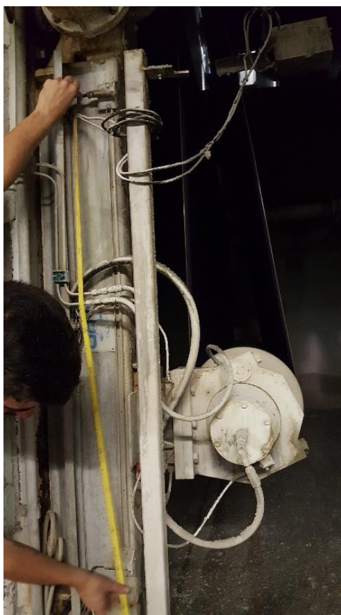
Slika 37. Pozicioniranje za mjerenje preostalog/iskorištenog hoda napinjača
