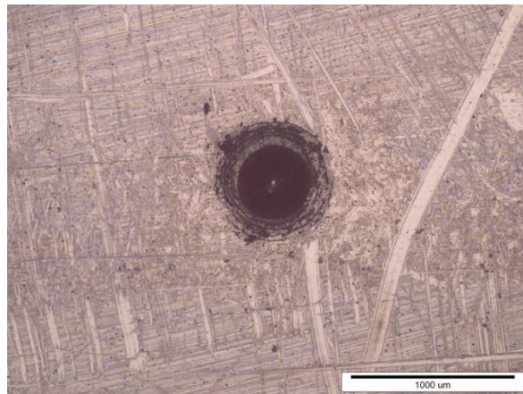
Slika 26. Otisak Rockwell-ovog C indentora na uzorku D2 31
