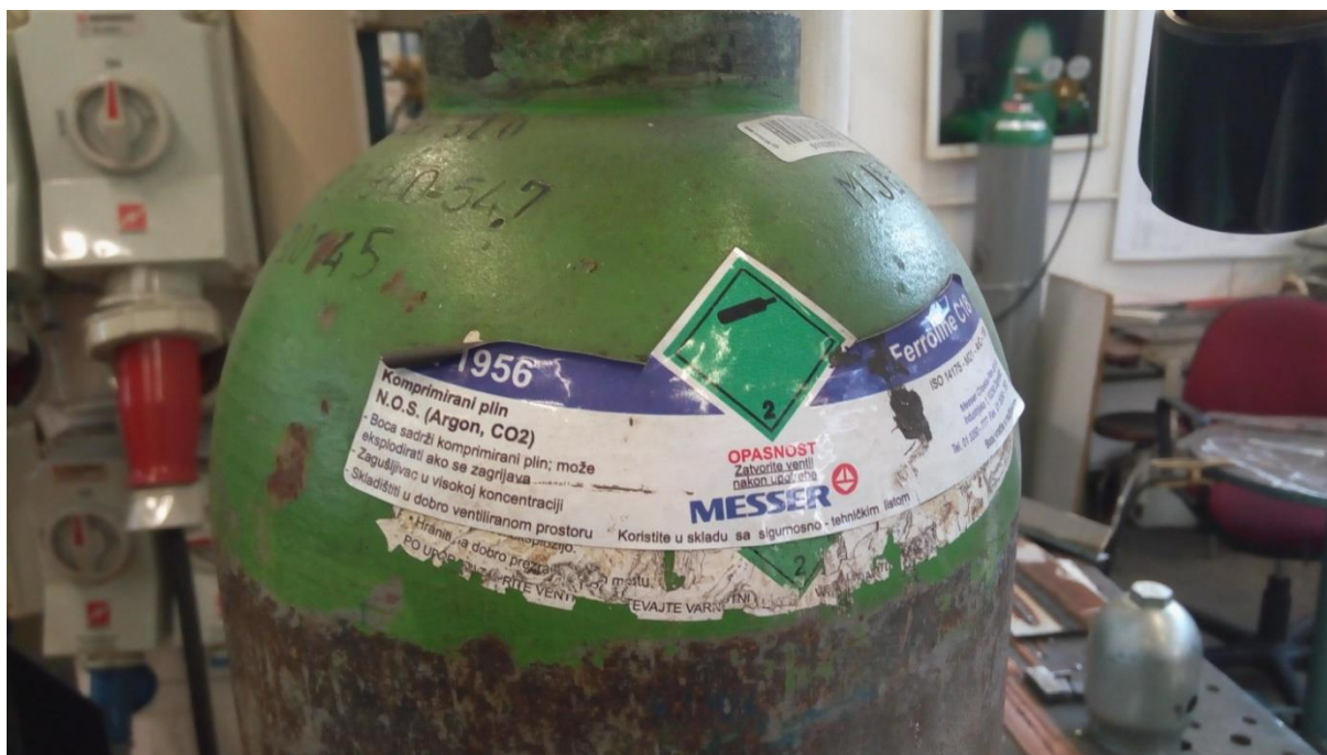
Slika 3.8 Spremnik C18 Ferroline zaštitnog plina
