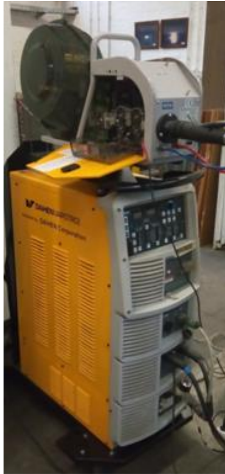
Slika 3.1 Welbee P500L izvor struje za zavarivanje
