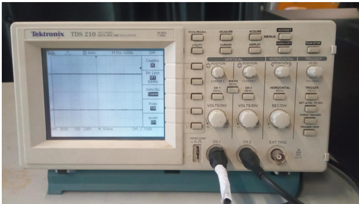
Slika 3.2 Tetronix TDS 210 dvokanalni osciloskop
