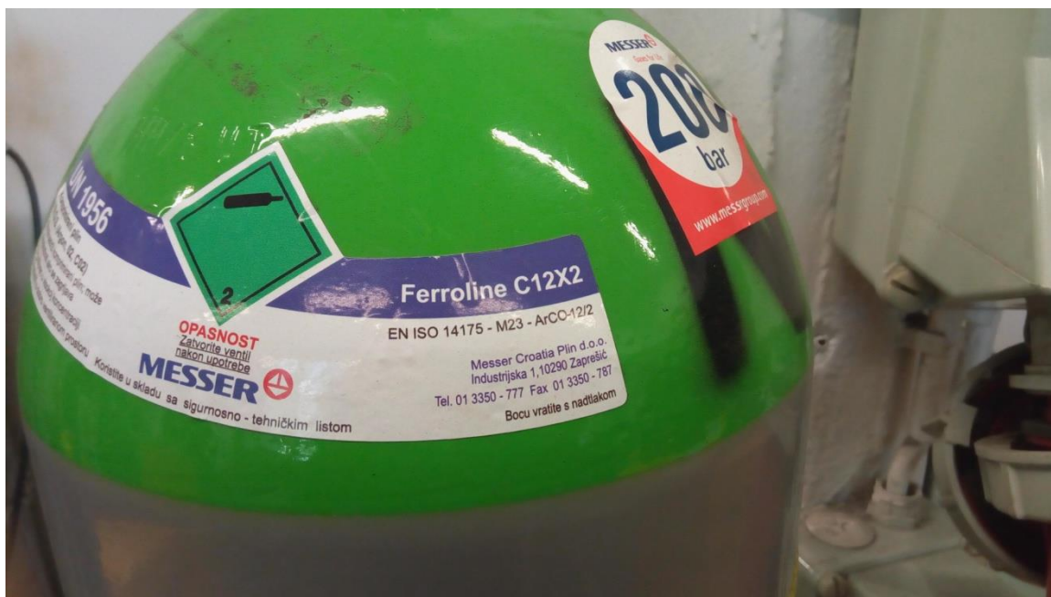
Slika 3.9 Spremnik Ferroline C12X12 zaštitnog plina
