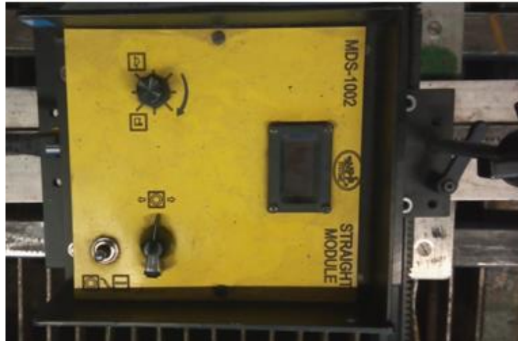
Slika 3.6 Kontrolna ploča MDS -1002 modularnog sustava za zavarivanje
